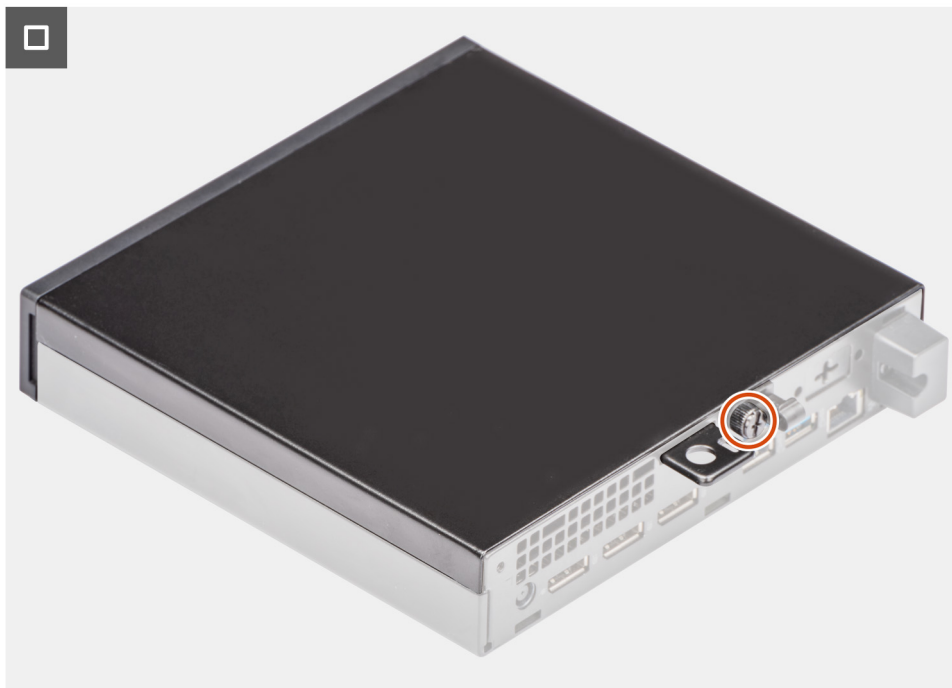
Abbildung 12. Anbringen der Seitenabdeckung
