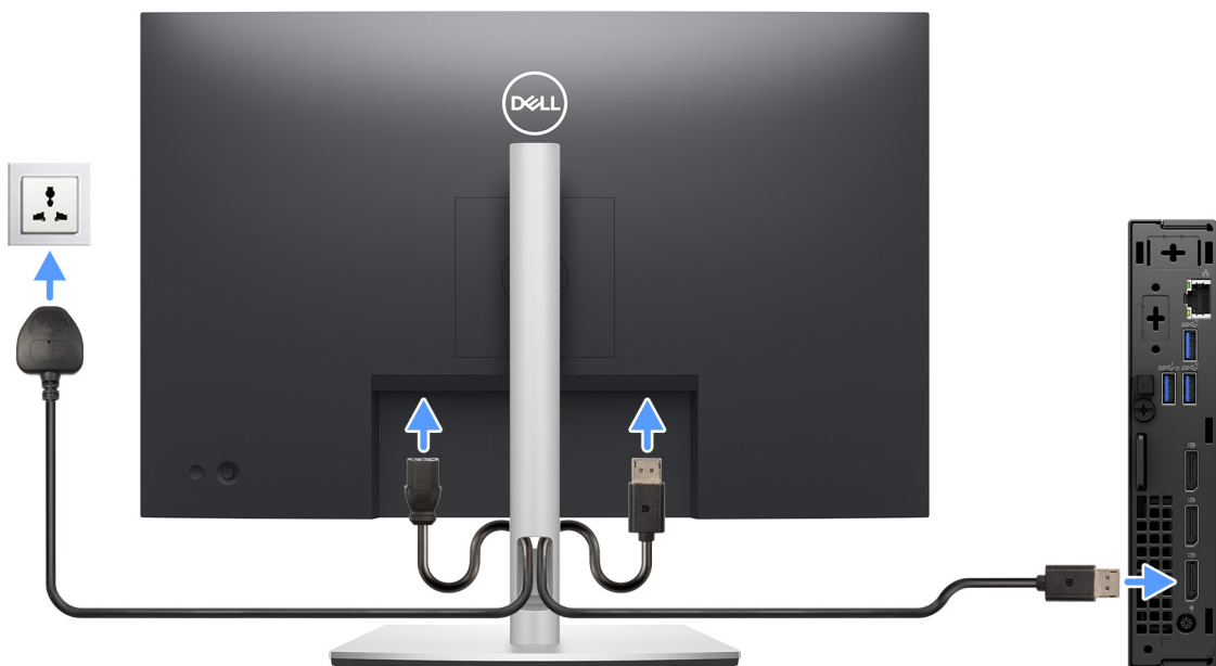
Afbeelding 5. Het beeldscherm aansluiten
