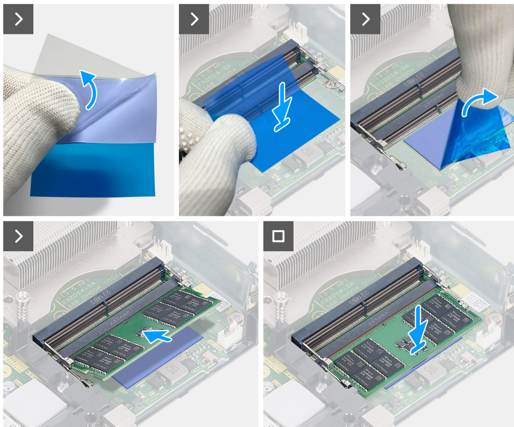
Afbeelding 33. De geheugenmodule plaatsen
