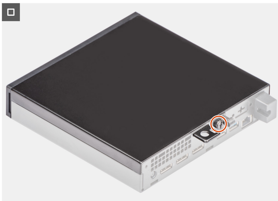
Figure 12. Installation du capot latéral
