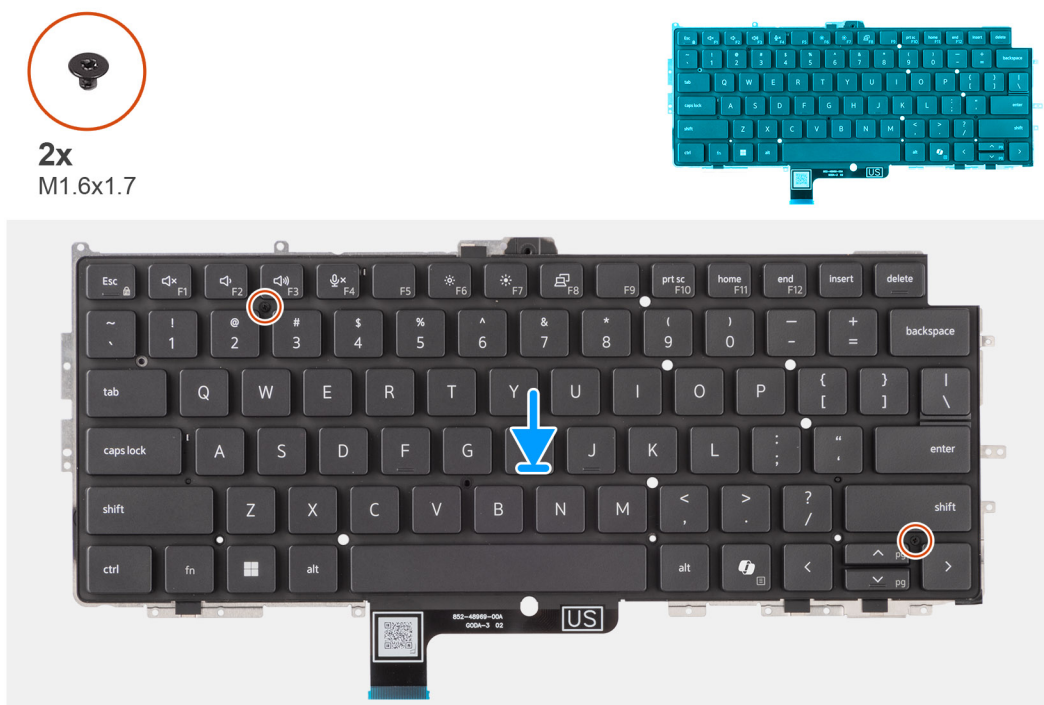
Figure 82. Installation du clavier
