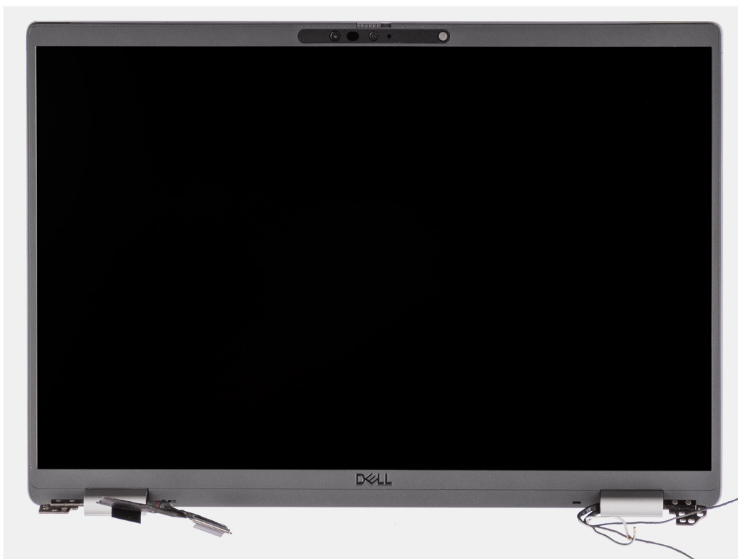
Figure 52. Assemblage d'écran avec câbles d'antenne WWAN
