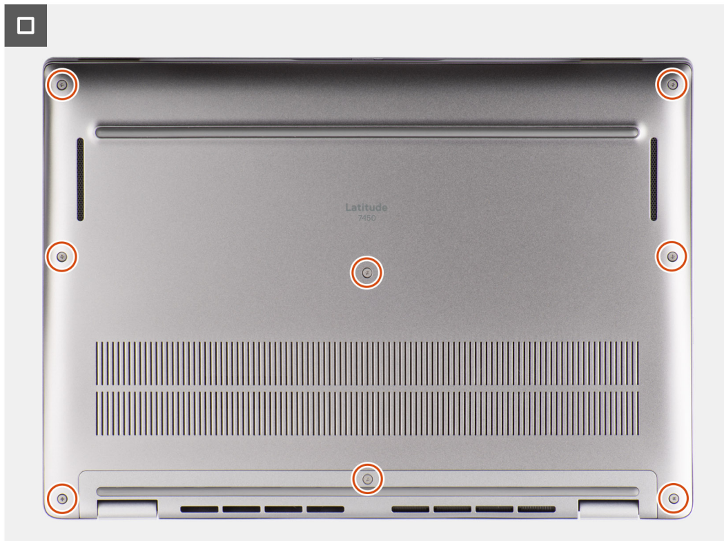
Figure 21. Installation du cache de fond
