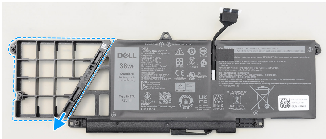
Figure 38. Retrait de la batterie à 2 cellules
