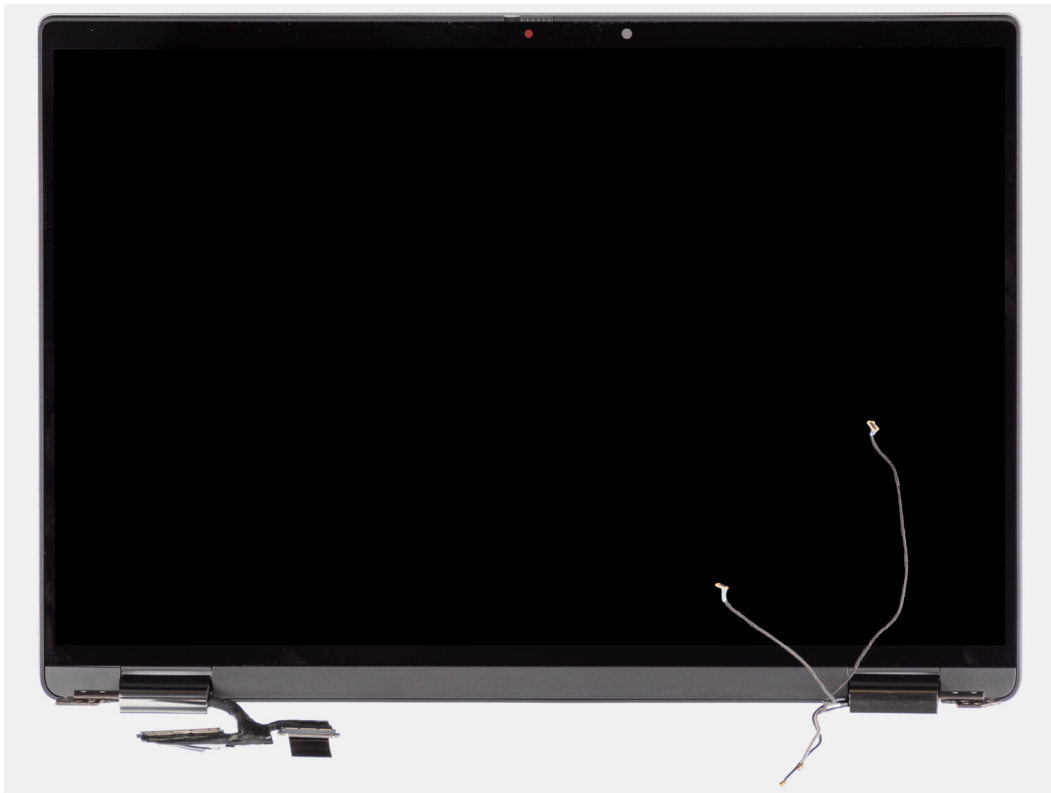
Figure 51. Assemblage d'écran avec câbles d'antenne WWAN
