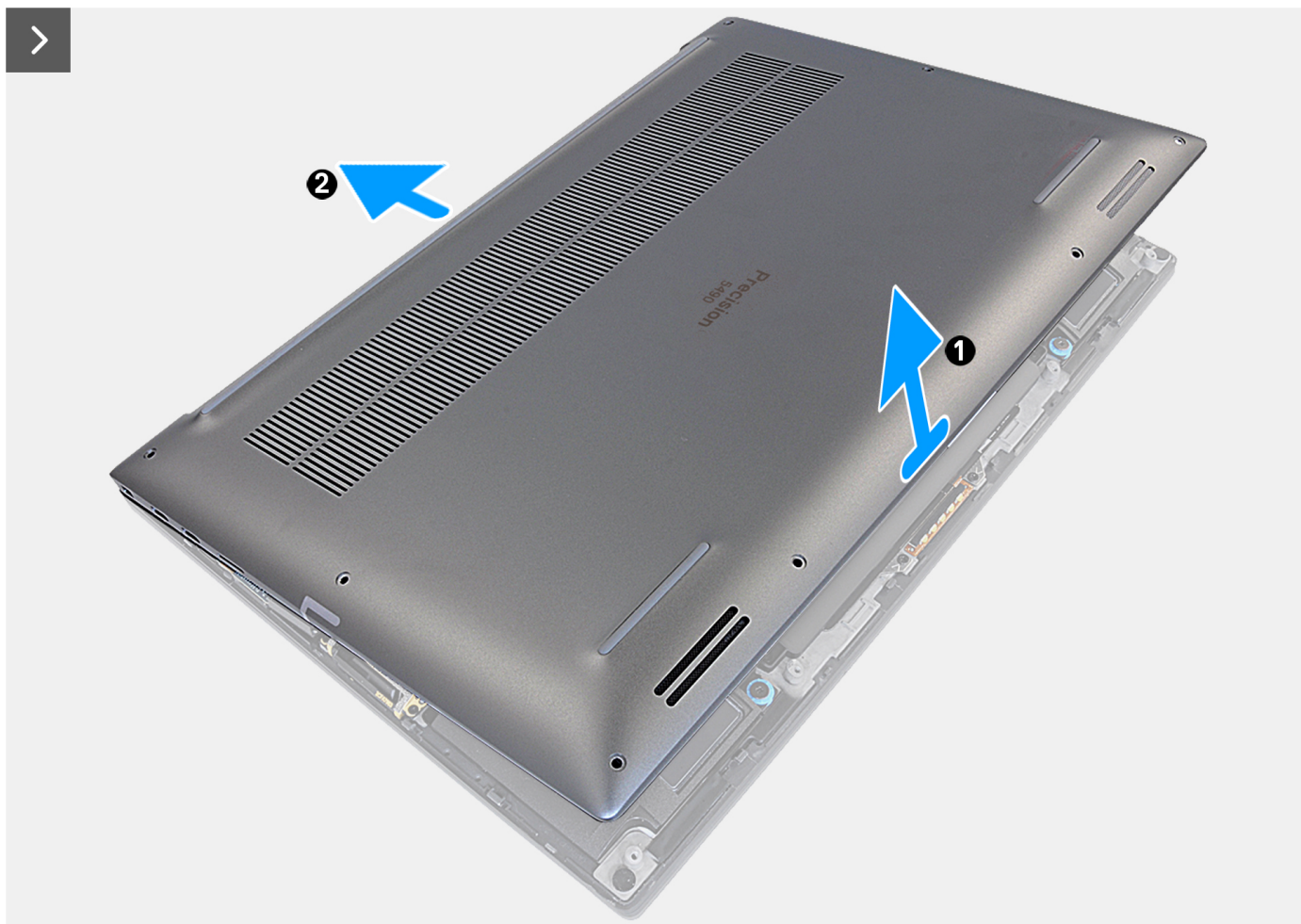
Ilustración 30. Extracción de la cubierta de la base
