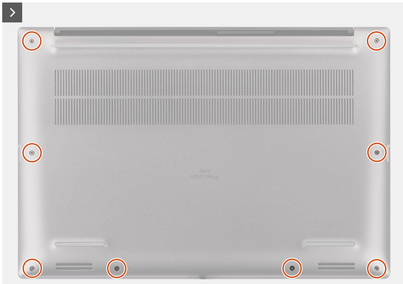
Ilustración 28. Extracción de la cubierta de la base
