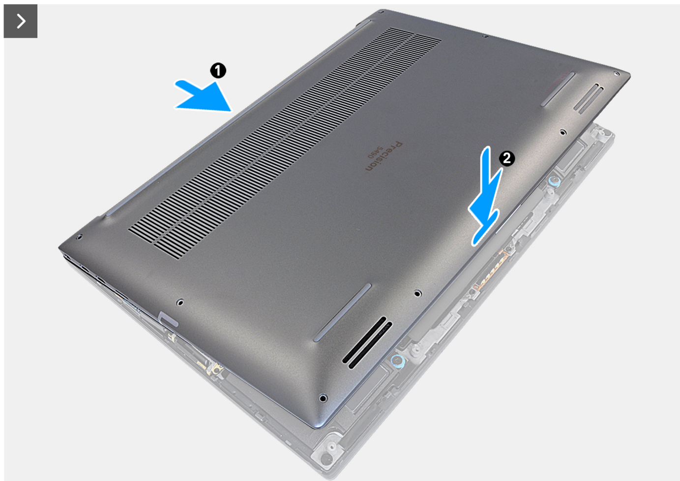
Ilustración 32. Instalación de la cubierta de la base
