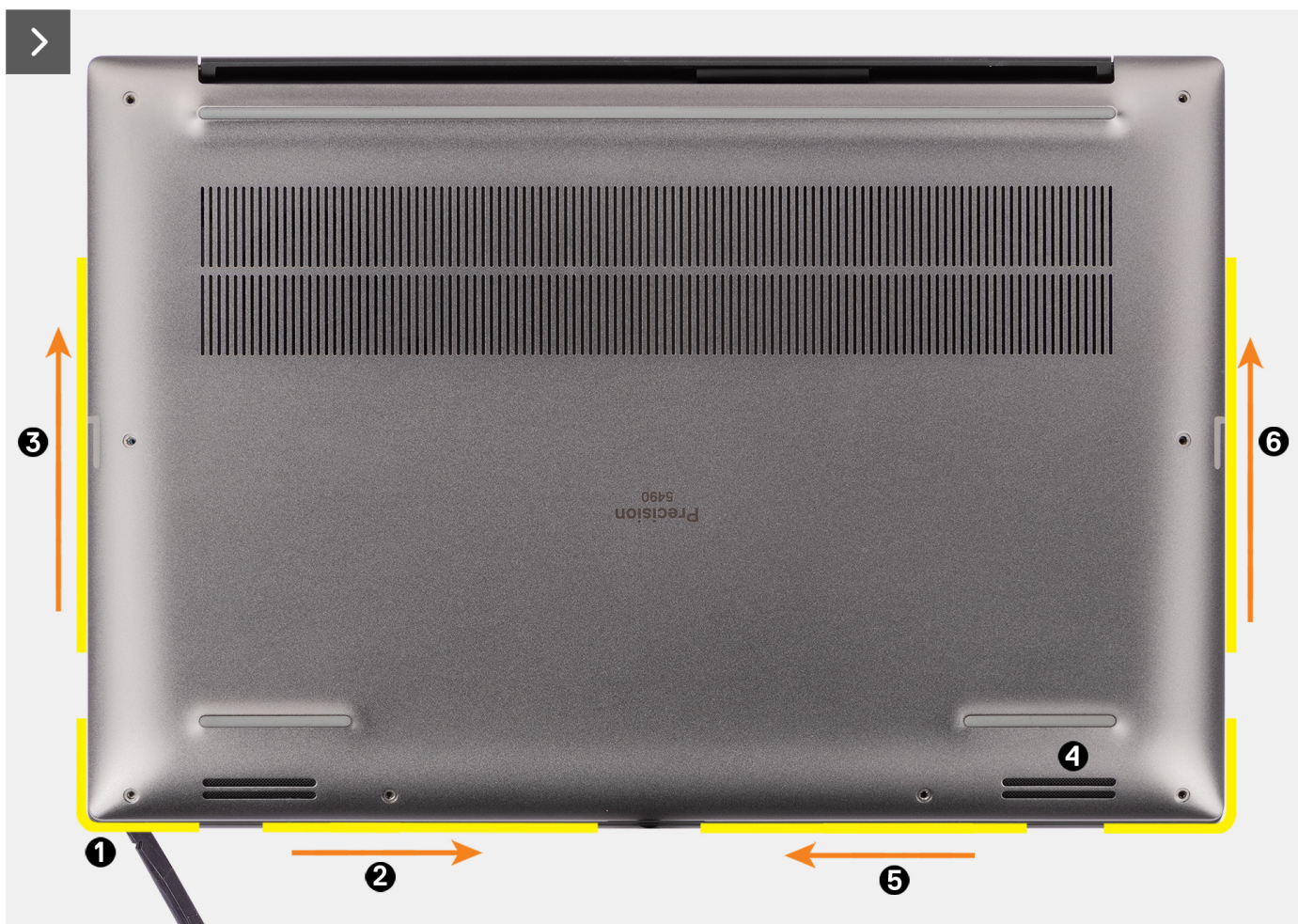
Ilustración 29. Extracción de la cubierta de la base
