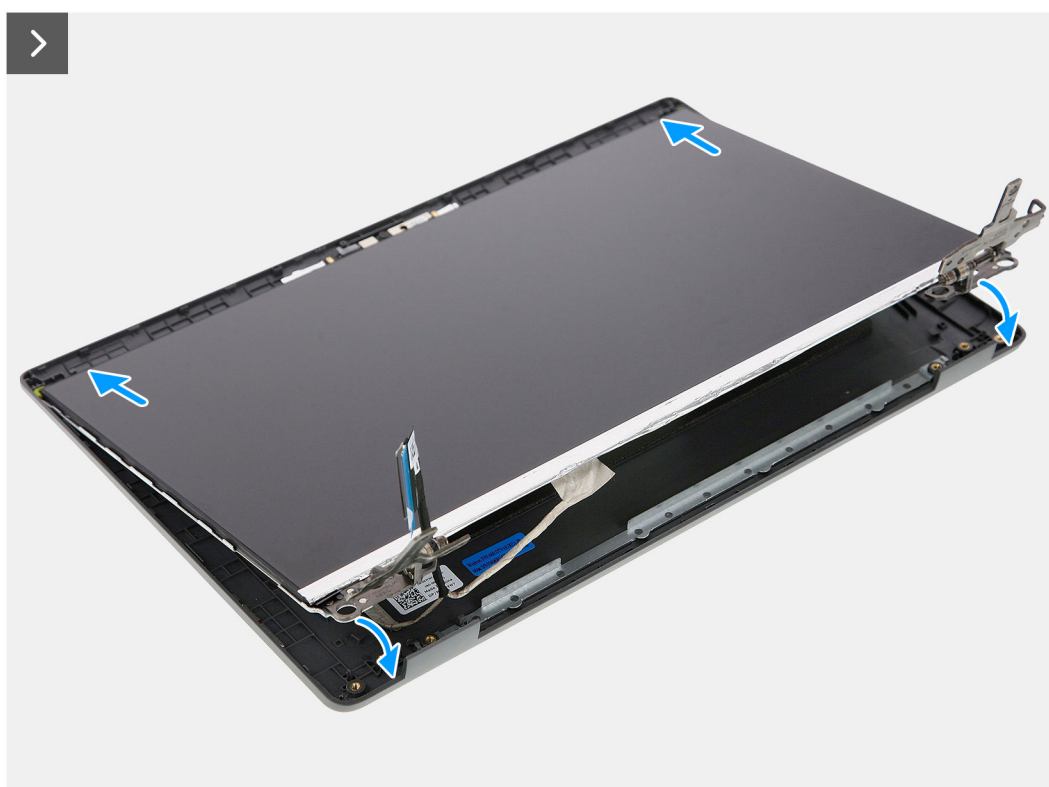
Figure 61. Installation du panneau d'écran
