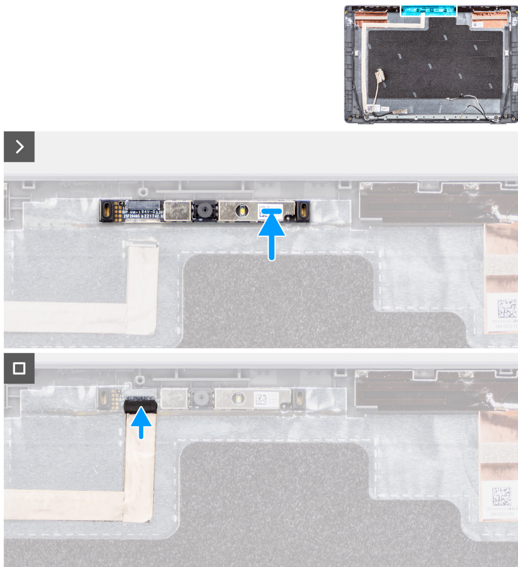
Figure 65. Installation de la caméra
