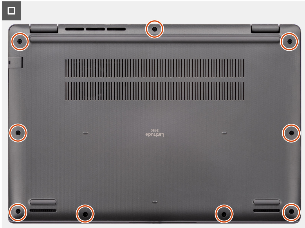
Ilustración 12. Instalación de la cubierta de la base
