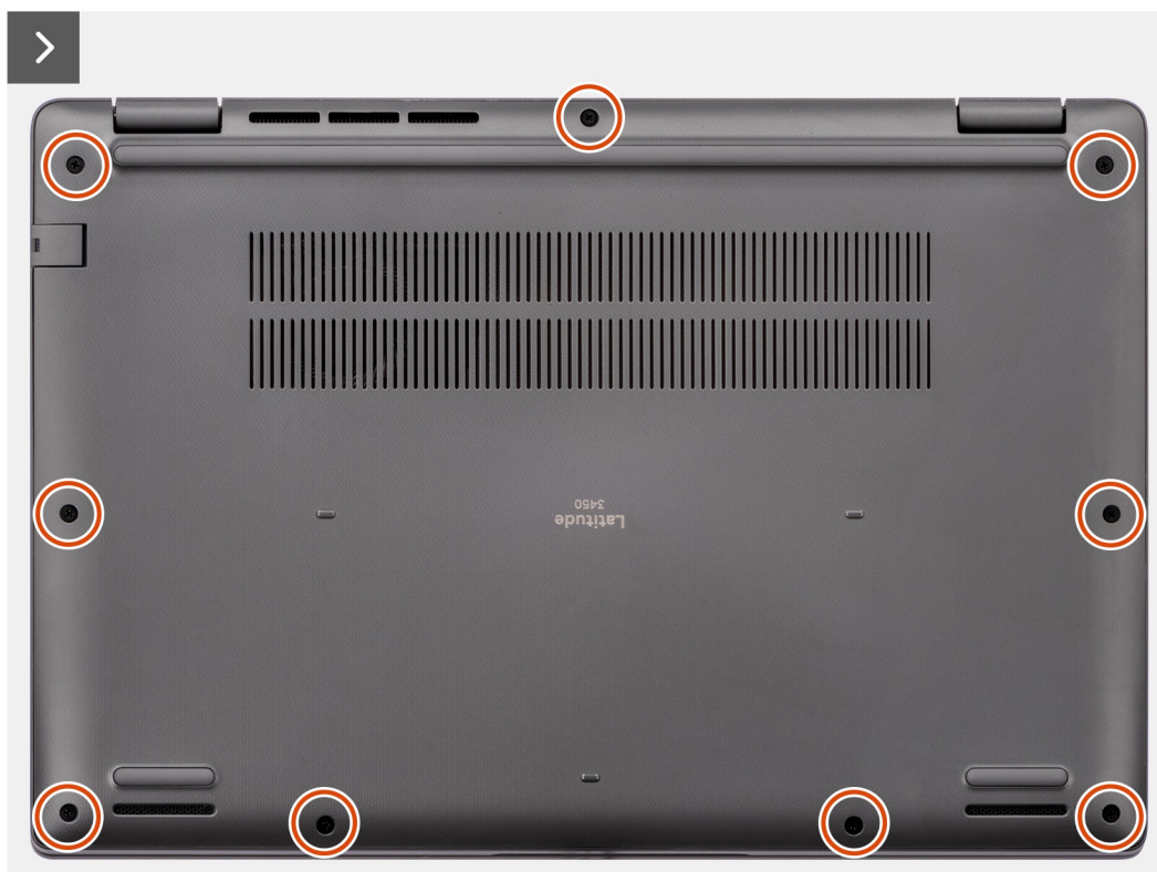
Ilustración 9. Extracción de la cubierta de la base
