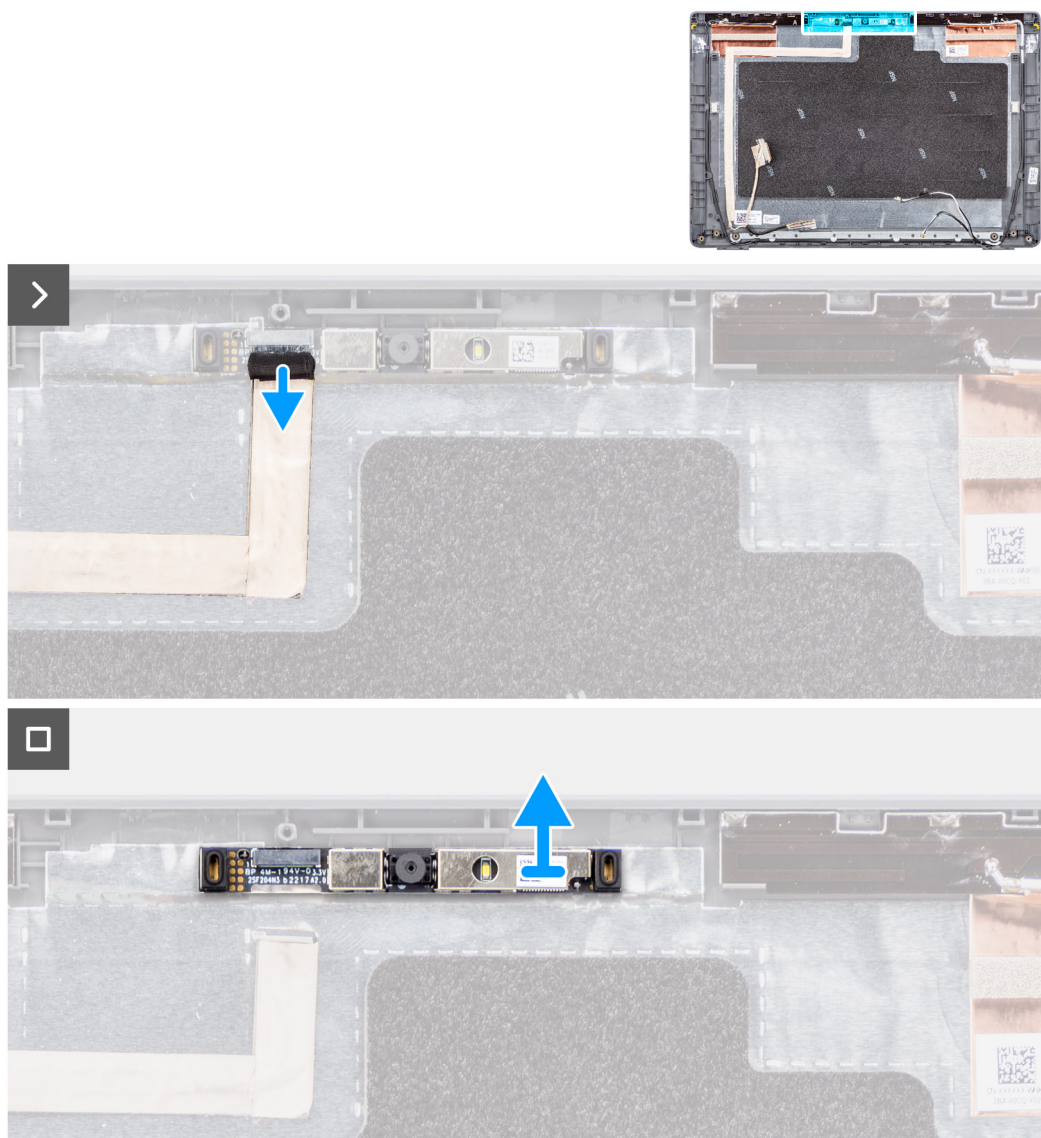
Ilustración 64. Extracción de la cámara
