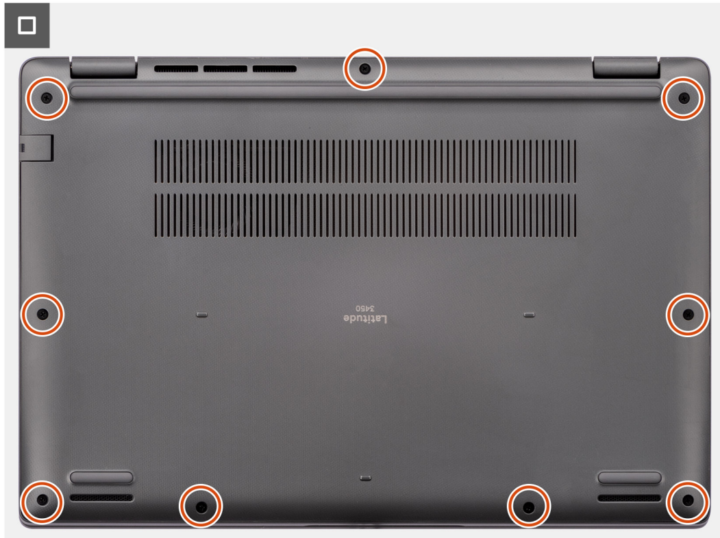
Abbildung 12. Anbringen der Bodenabdeckung
