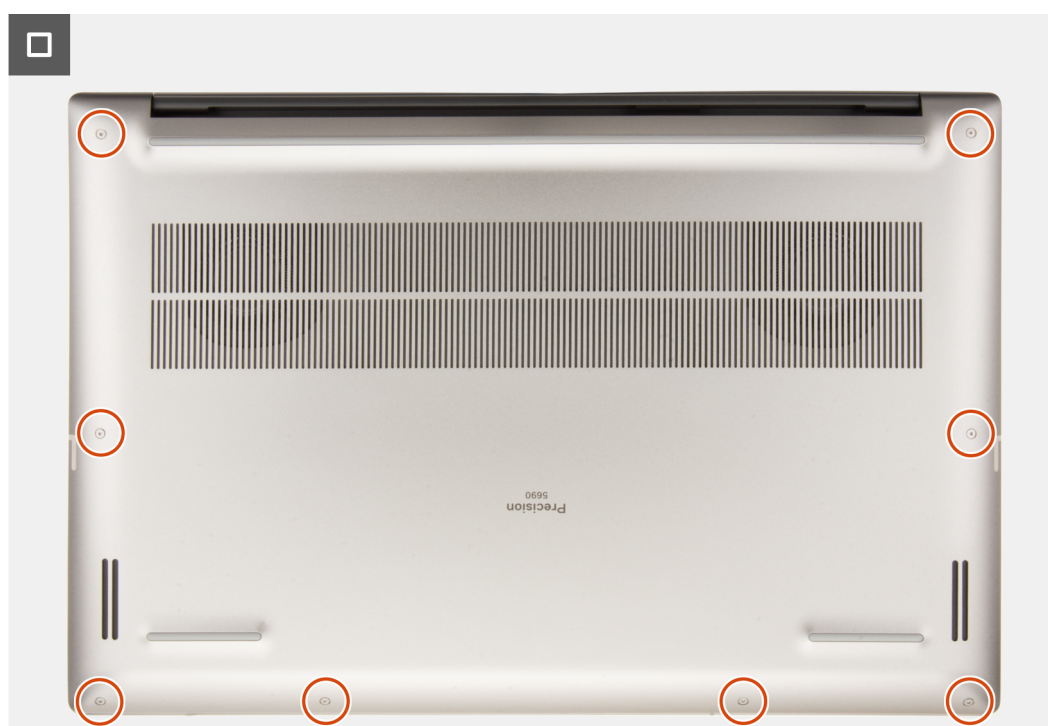
Ilustración 15. Instalación de la cubierta de la base
