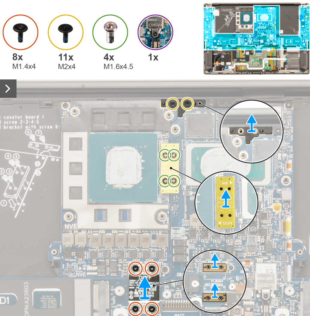
Ilustración 55. Extracción de la tarjeta madre
