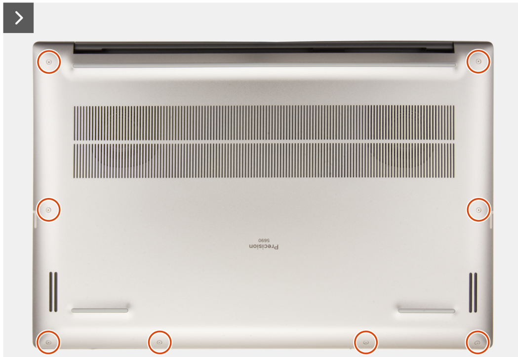
Ilustración 11. Extracción de la cubierta de la base
