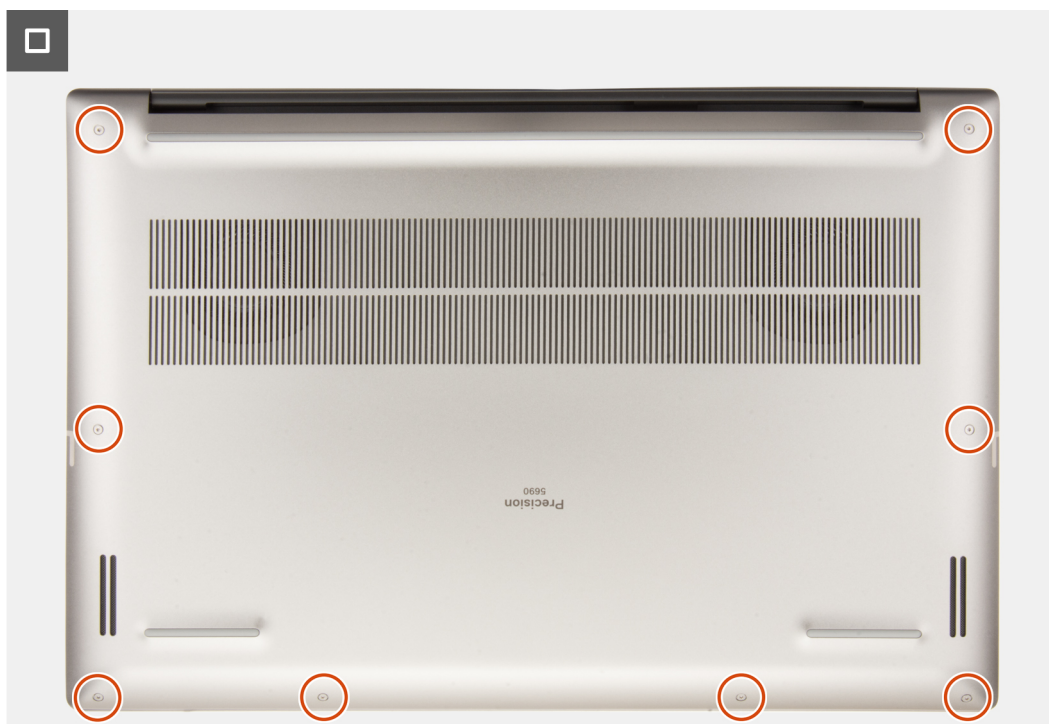
Abbildung 15. Installieren der Bodenabdeckung
