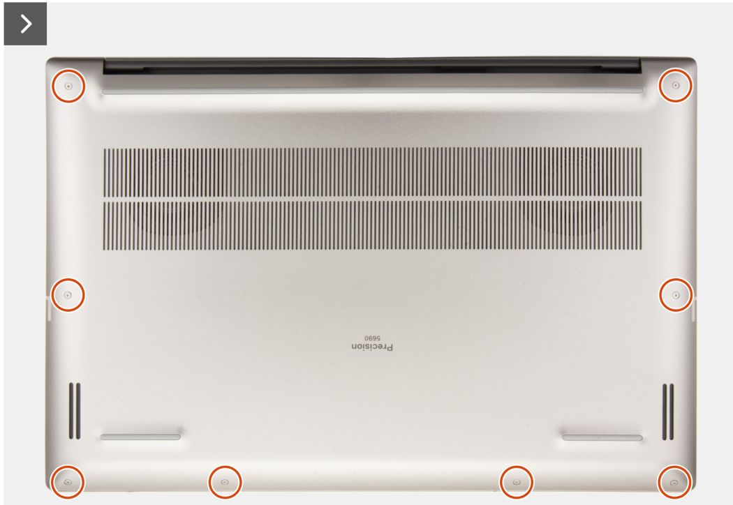
Abbildung 11. Entfernen der Bodenabdeckung
