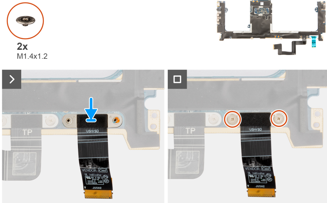
Abbildung 74. Installieren des FPC-Kabels der SD-Karten-Zusatzplatine
