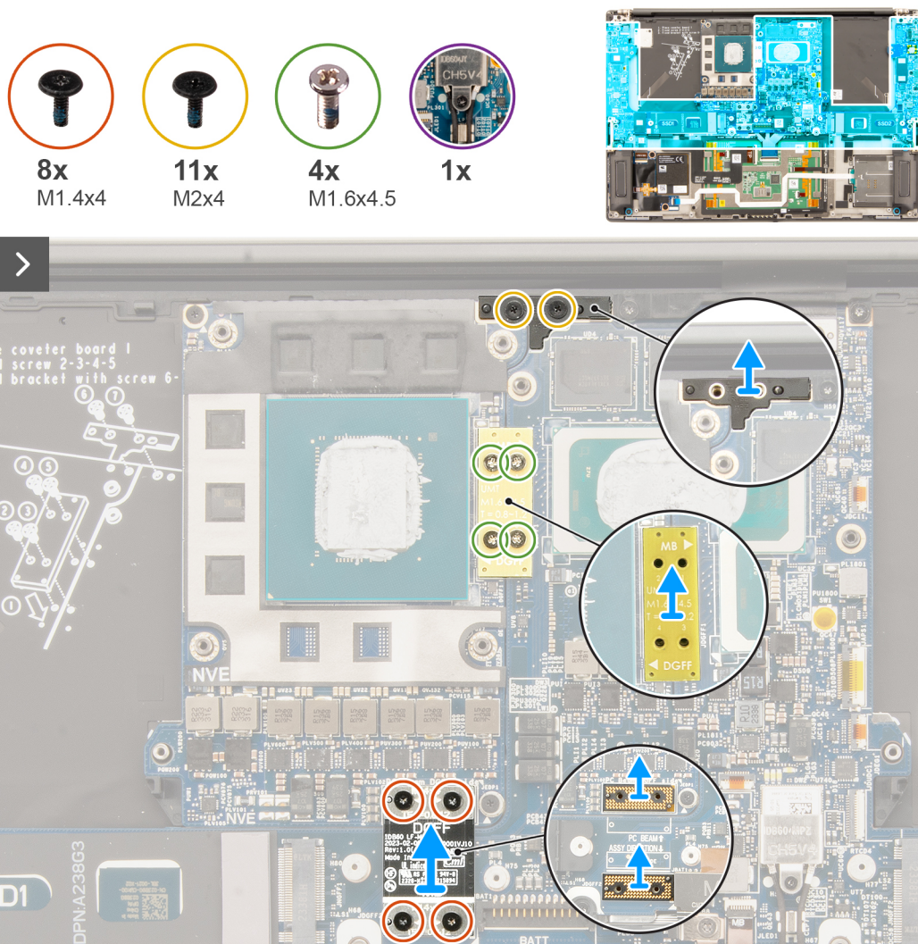
Abbildung 55. Entfernen der Hauptplatine
