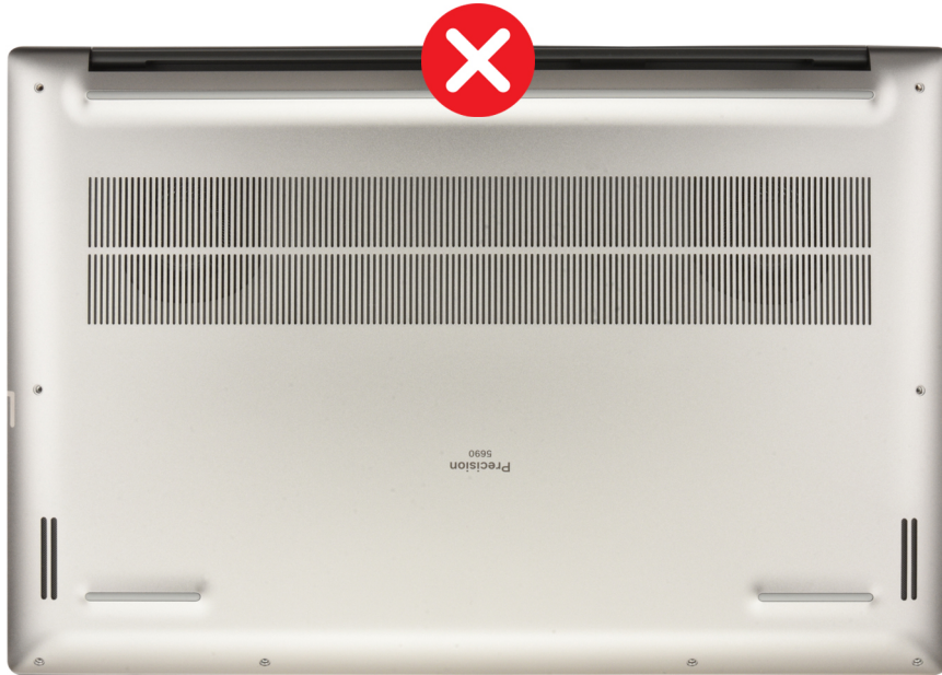
Afbeelding 13. De onderplaat verwijderen
