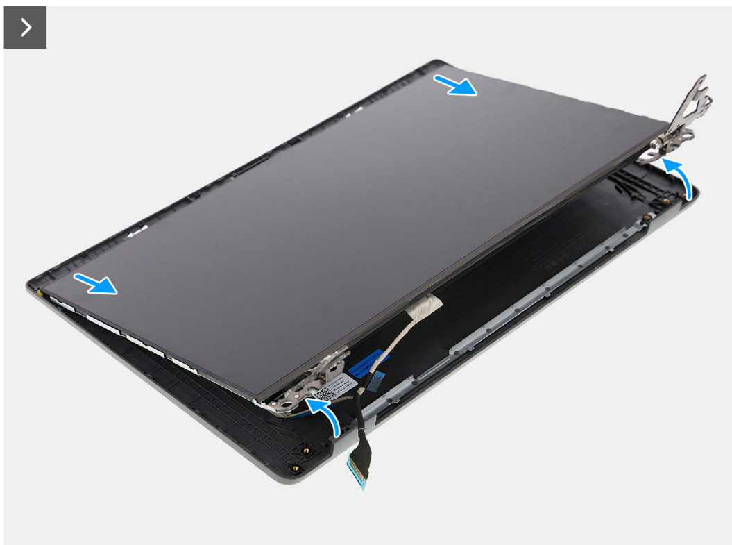
Abbildung 58. Entfernen des Bildschirms
