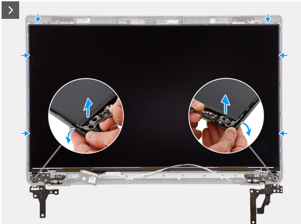
Abbildung 57. Entfernen des Bildschirms
