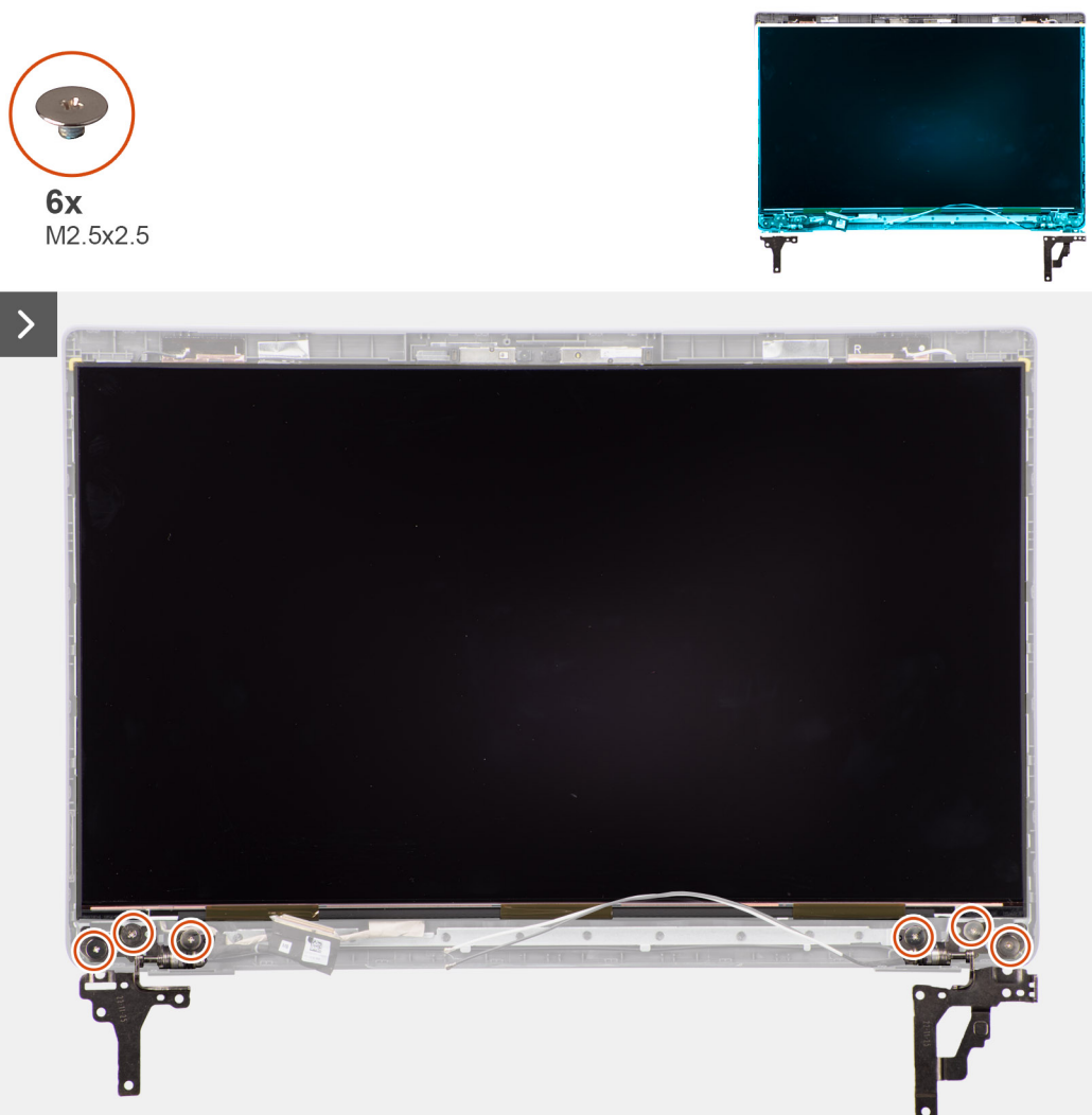
Abbildung 56. Entfernen des Bildschirms
