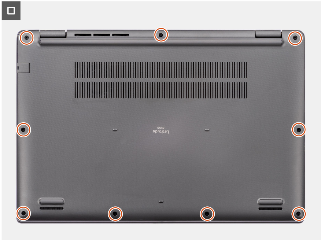
Abbildung 11. Anbringen der Bodenabdeckung
