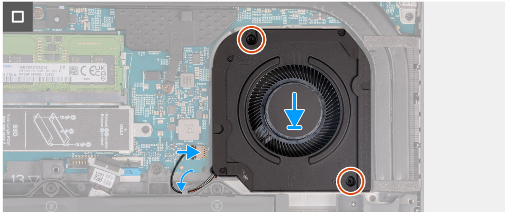
Abbildung 34. Installieren des Lüfters
