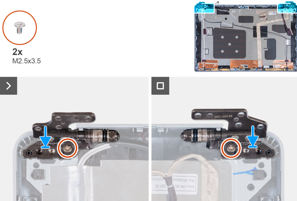
Abbildung 87. Installieren der Bildschirmscharniere
