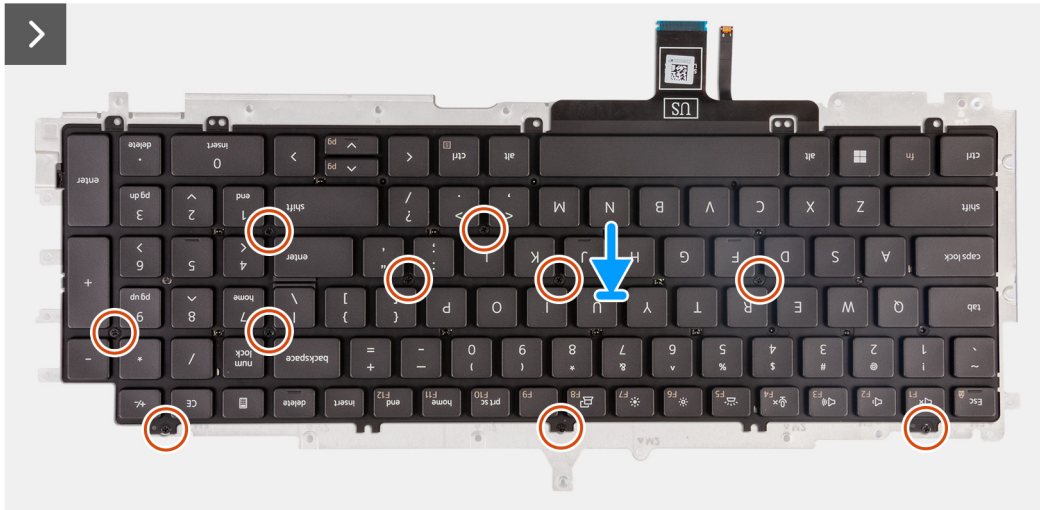
Abbildung 71. Installieren der Tastatur
