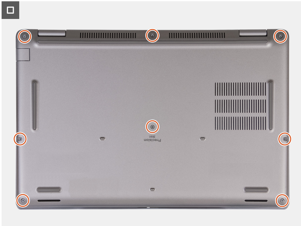
Abbildung 18. Festziehen der unverlierbaren Schrauben
