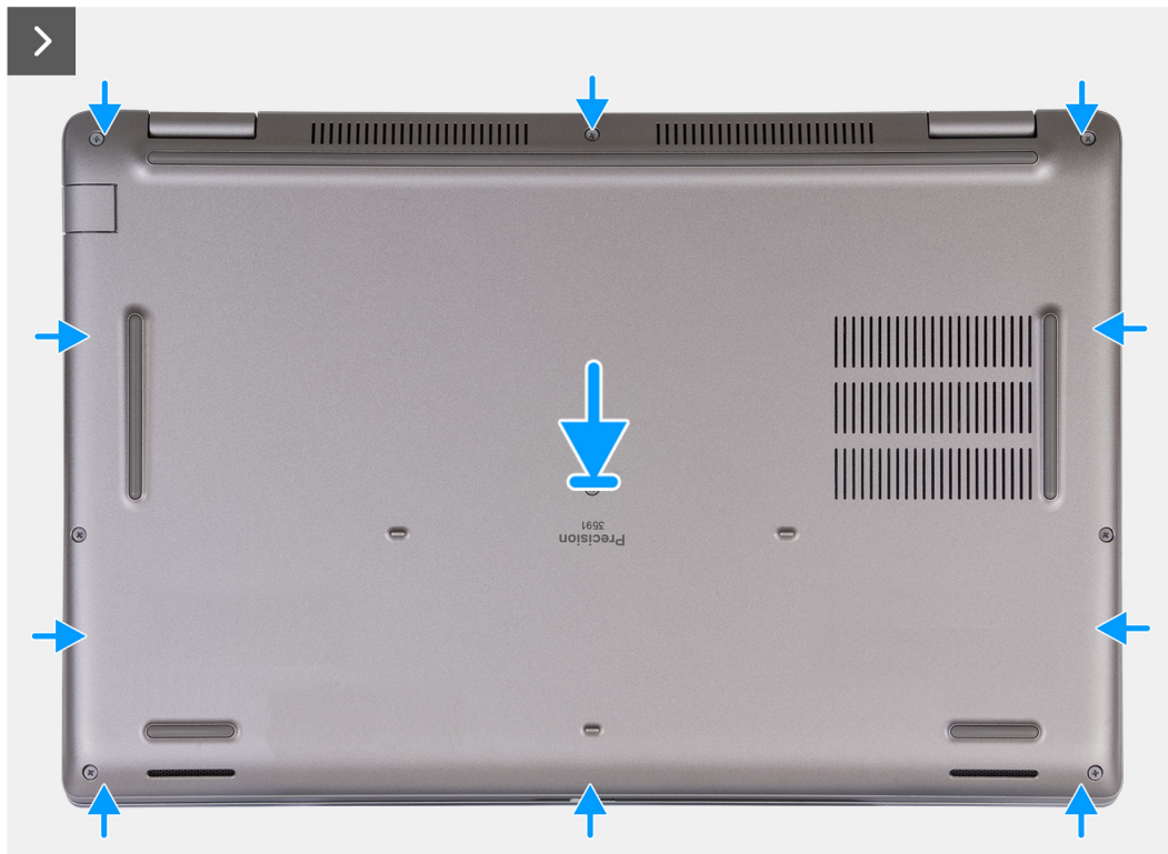
Abbildung 17. Installieren der Bodenabdeckung
