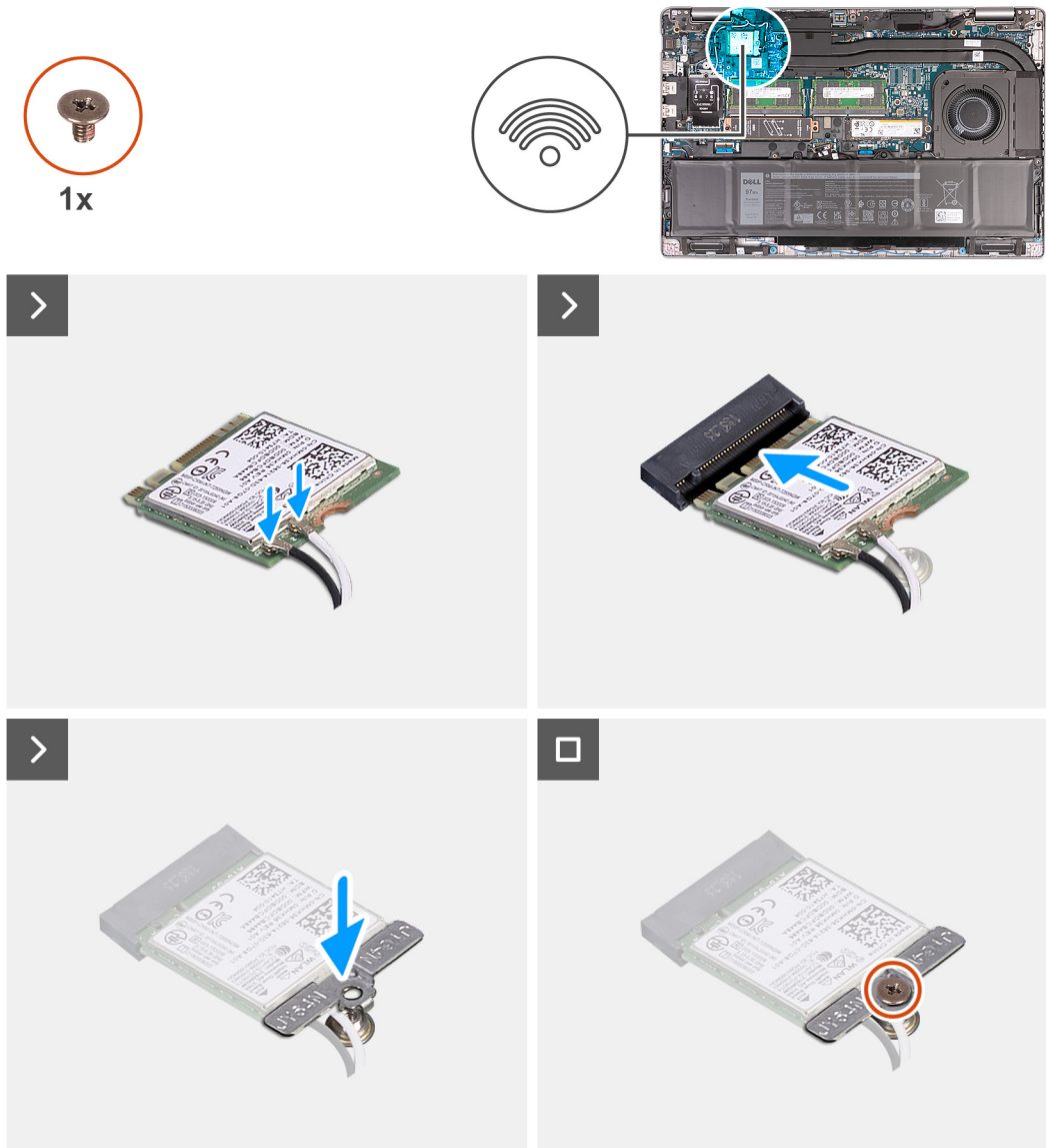
Abbildung 20. Installieren der Wireless-Karte
