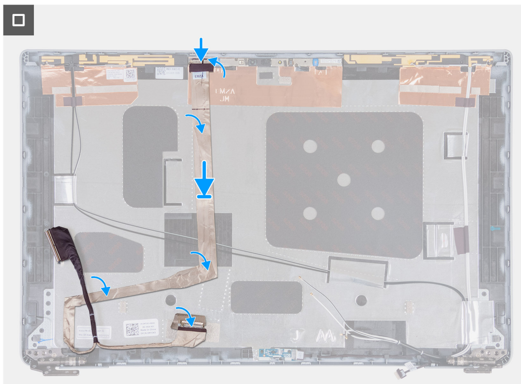
Figure 95. Installation du câble de l'écran
