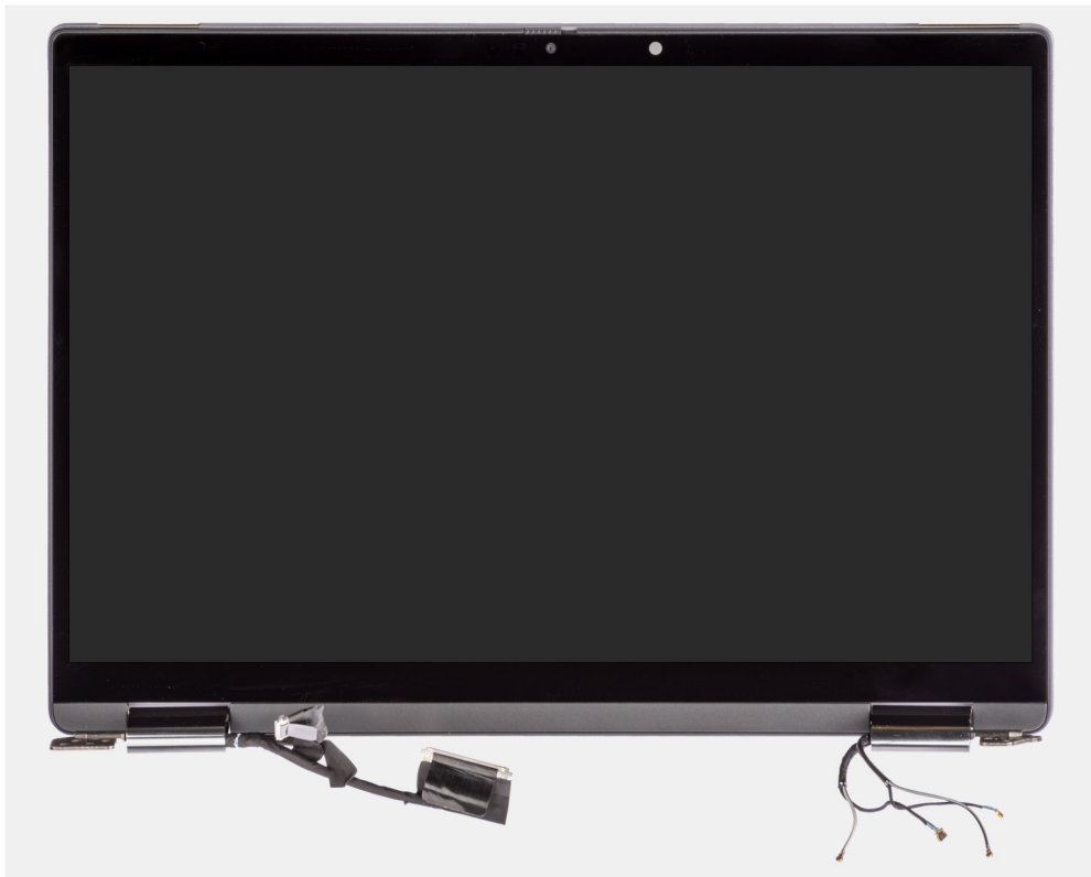
Figure 43. Assemblage d'écran sans câble d'antenne WWAN
