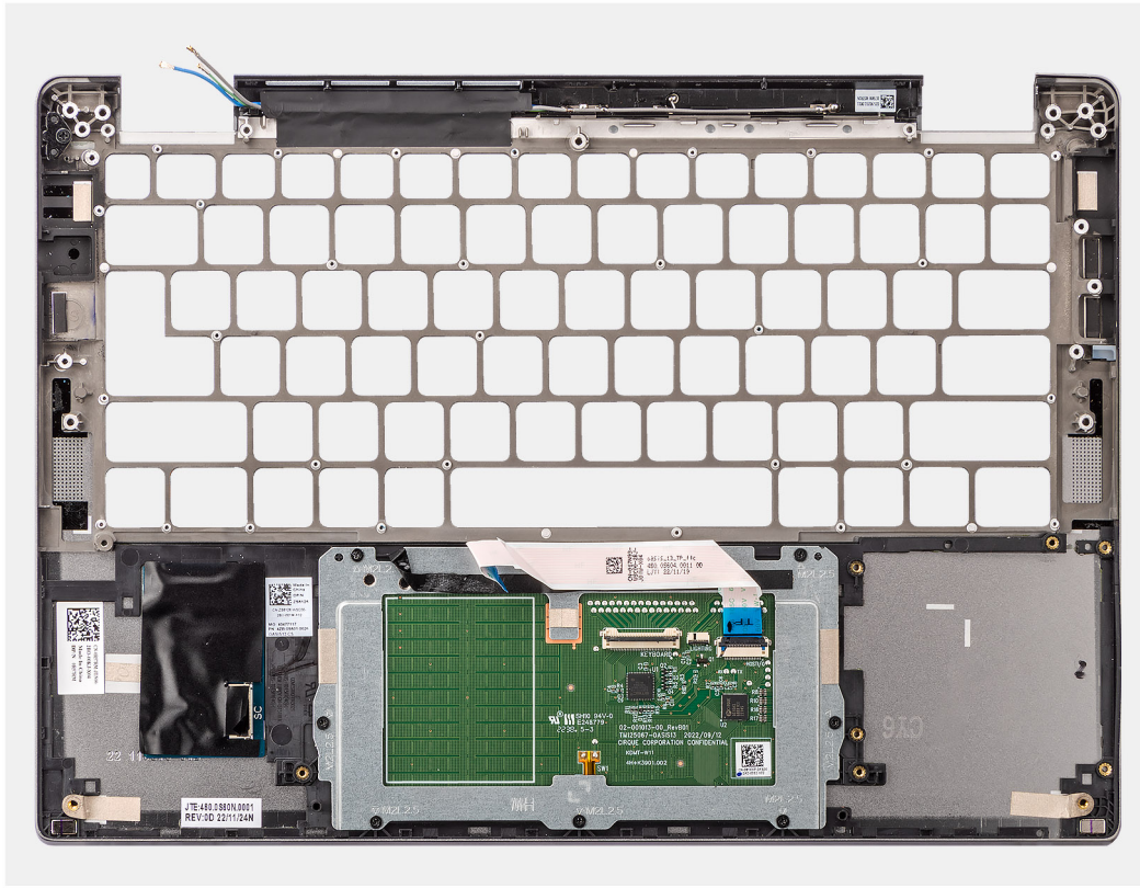
Figure 68. Retrait de l'assemblage du repose-poignets
