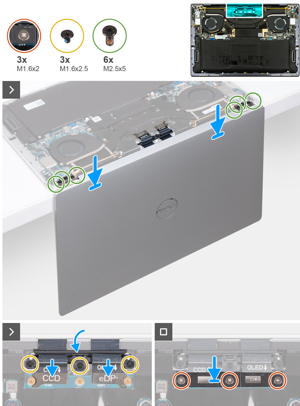
Figur 35. Installera bildskärmsenheten
