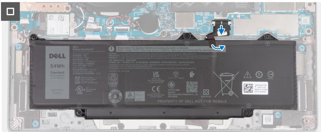
Abbildung 19. Trennen des Akkukabels von der Hauptplatine
