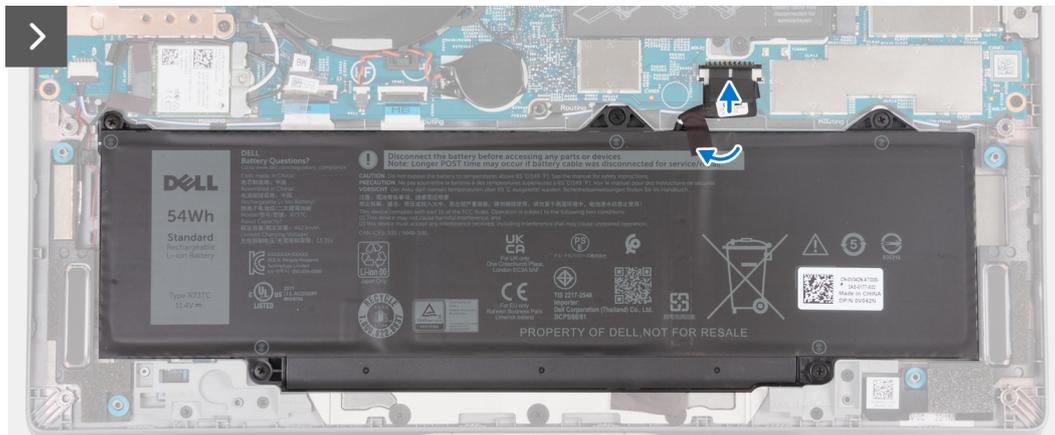
Abbildung 20. Verbinden Sie das Batteriekabel mit der Systemplatine
