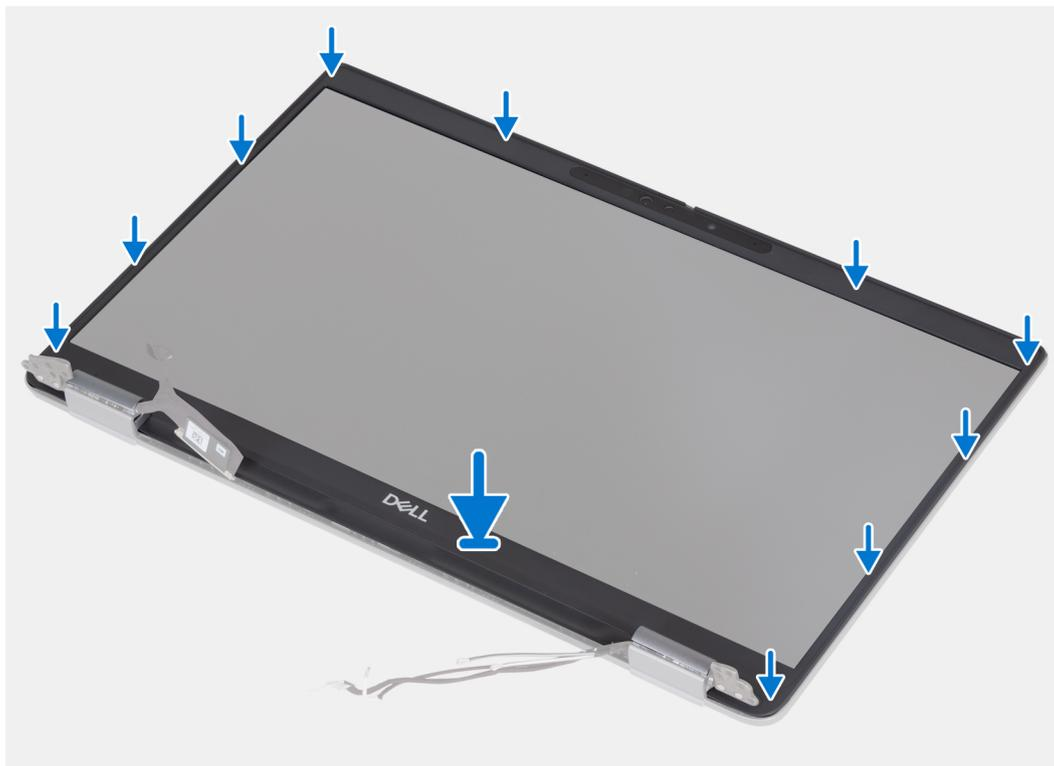
**Abbildung 69. Installieren des Bildschirmrahmens (Laptop)**
