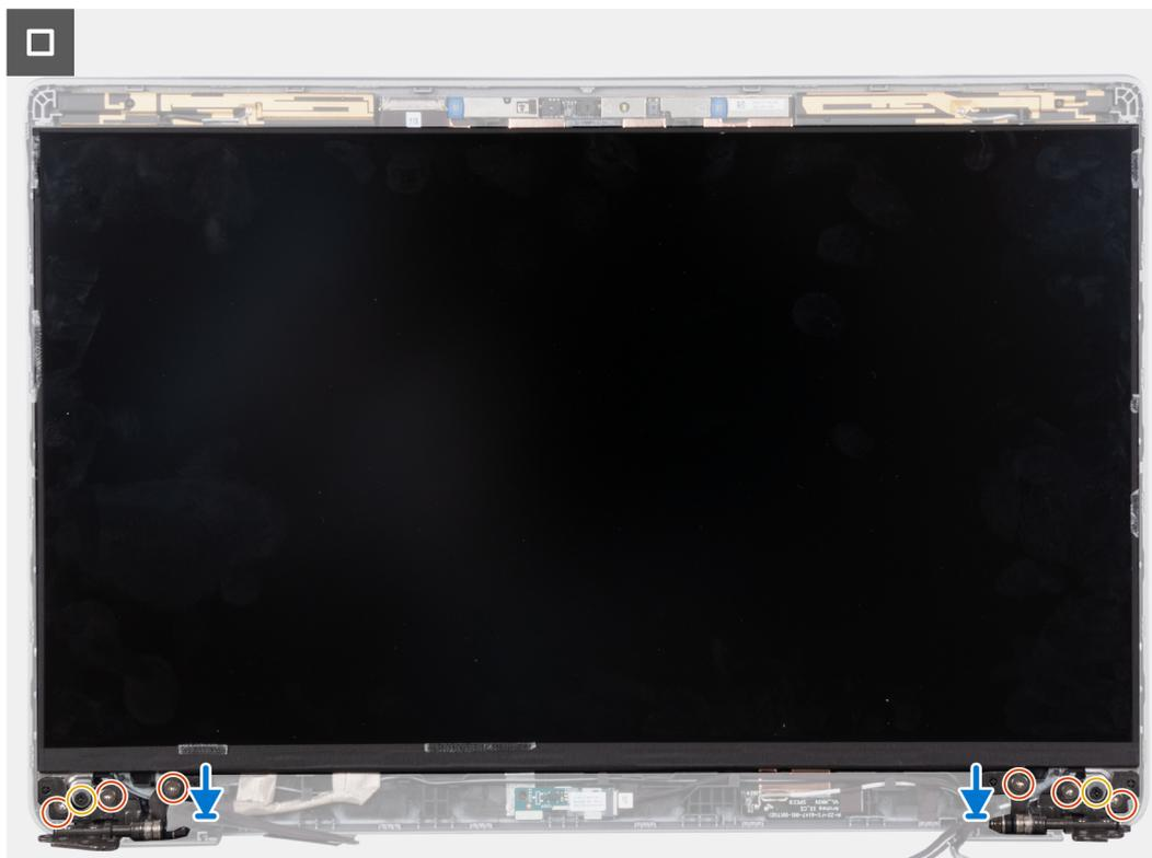
Abbildung 79. Einsetzen der Laschen des Bildschirms in die Schlitz der Bildschirmabdeckung
