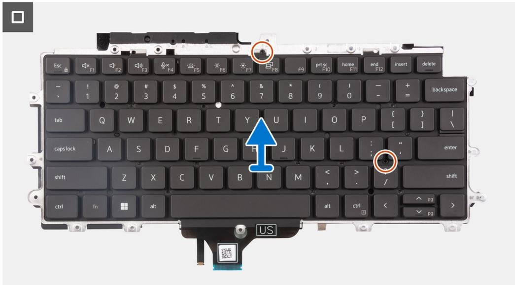
Abbildung 60. Entfernen der Tastaturbaugruppe
