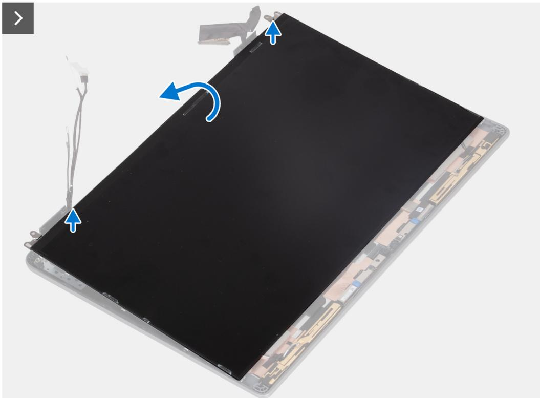
Abbildung 74. Entfernen des Bildschirms (Laptop)
