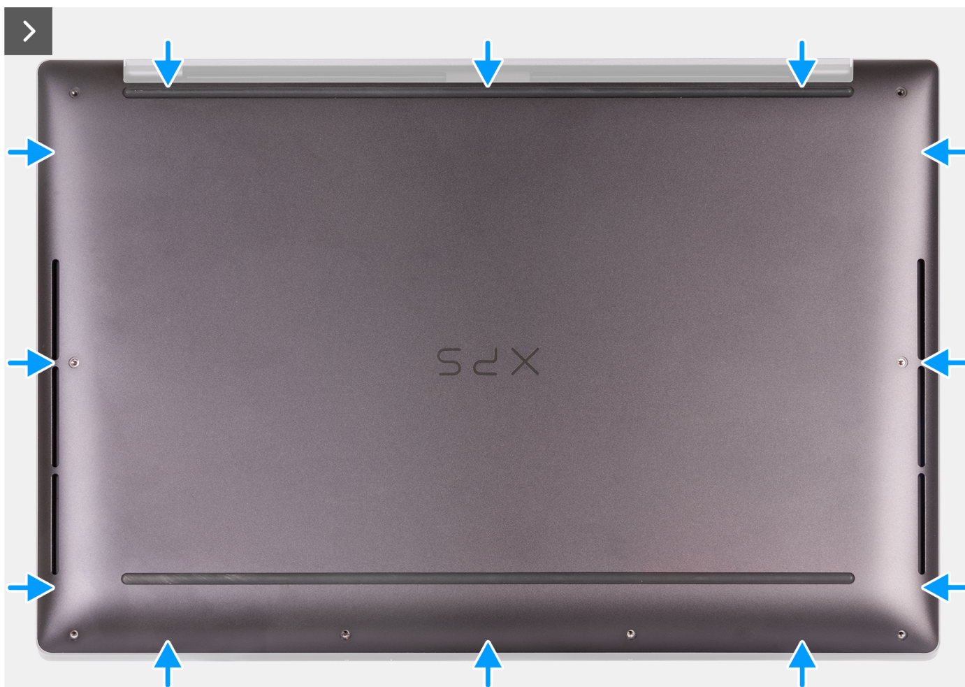
Figur 14. Klicka fast baskåpan på plats på handledsstödet
