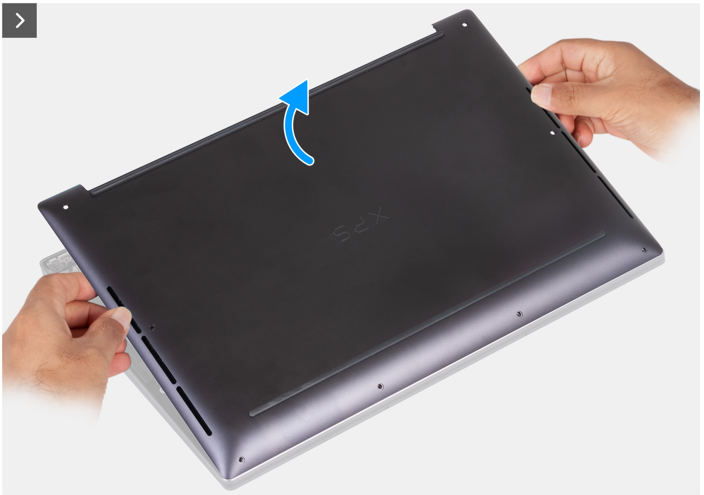
Figur 10. Lyfta bort baskåpan från handledsstödet
