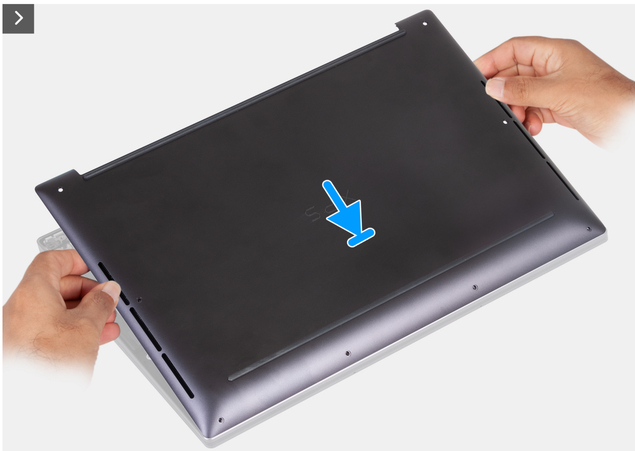
Figur 13. Placera baskåpan i spåren på handledsstödet
