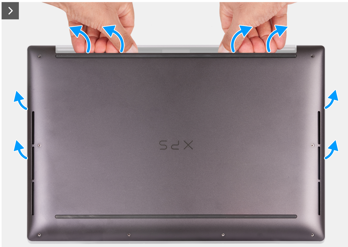
Figur 9. Bända loss baskåpan med tummarna
