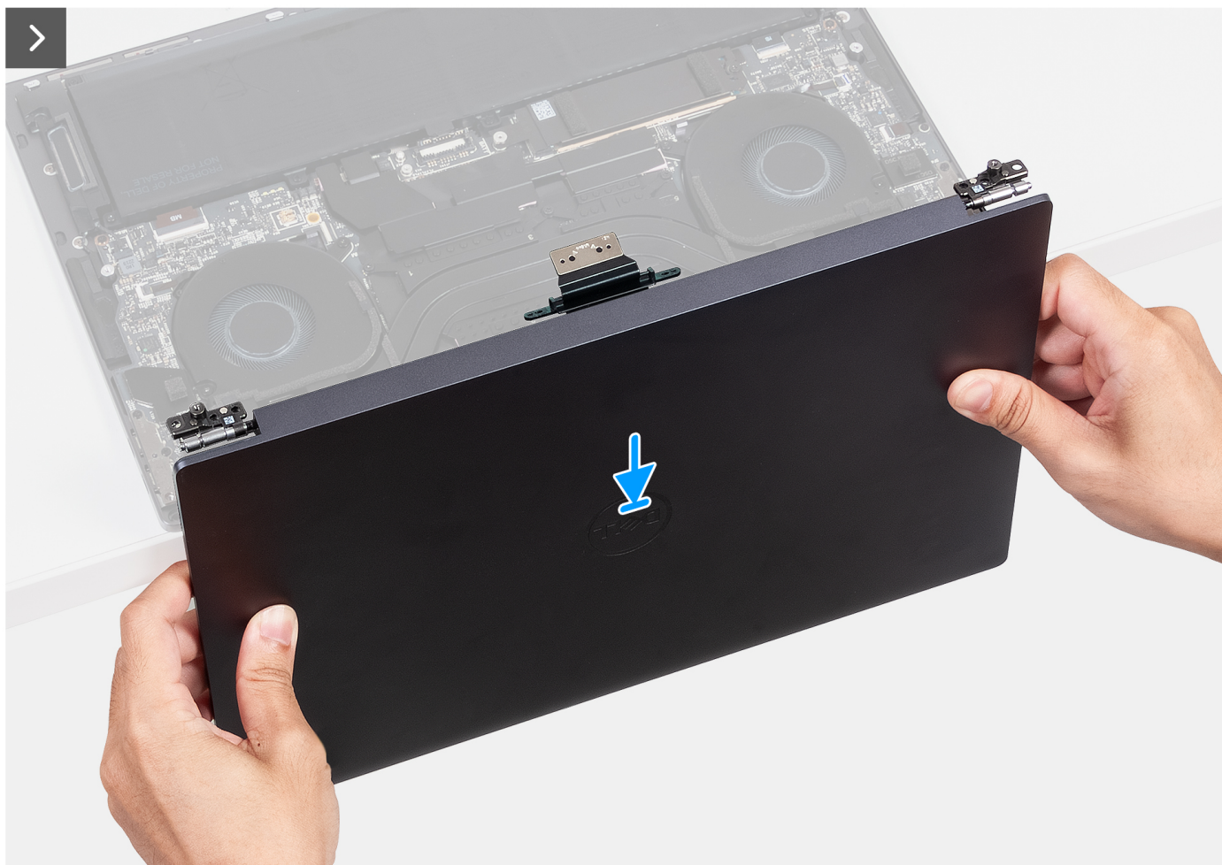
Figura 29. Installazione del gruppo del display
