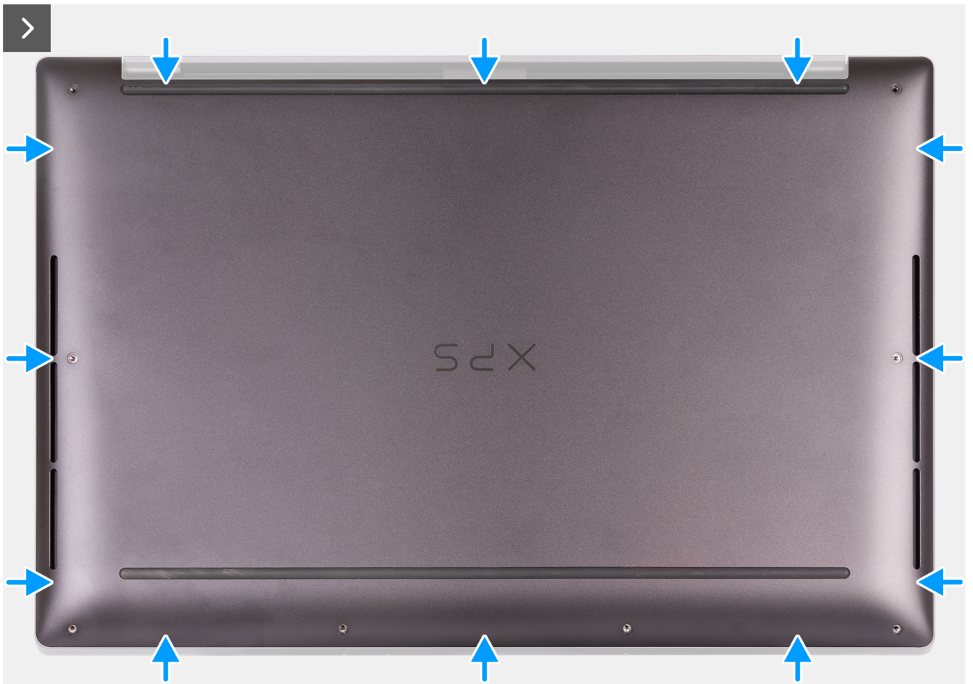
Figura 14. Scatto del coperchio della base in posizione sul gruppo del poggiapolsi
