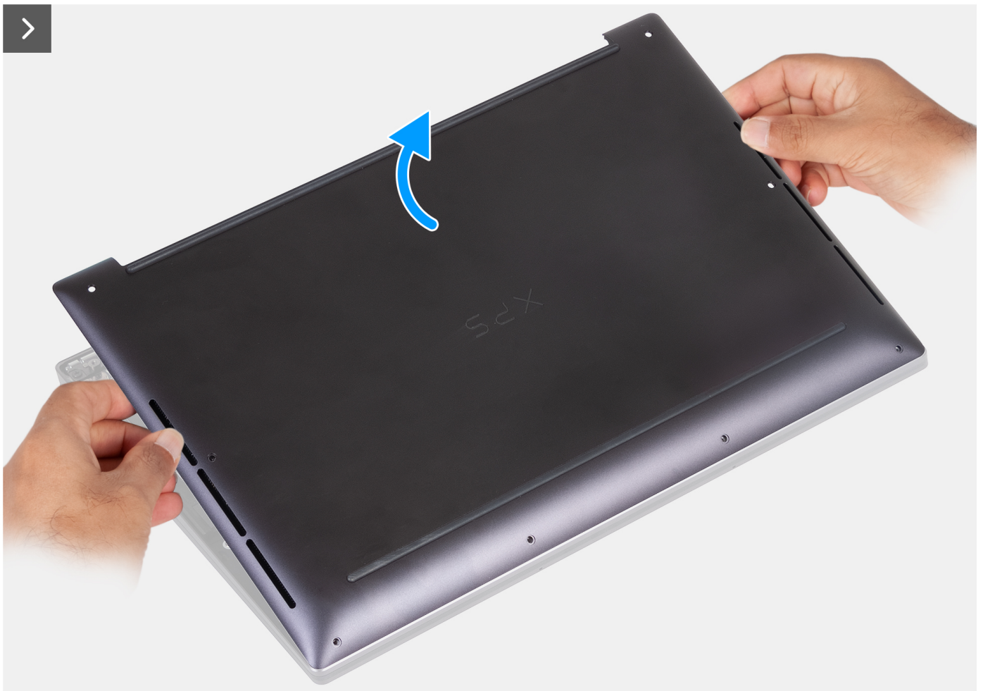
Figura 10. Sollevamento del coperchio della base ed estrarlo dal gruppo del poggiapolsi
