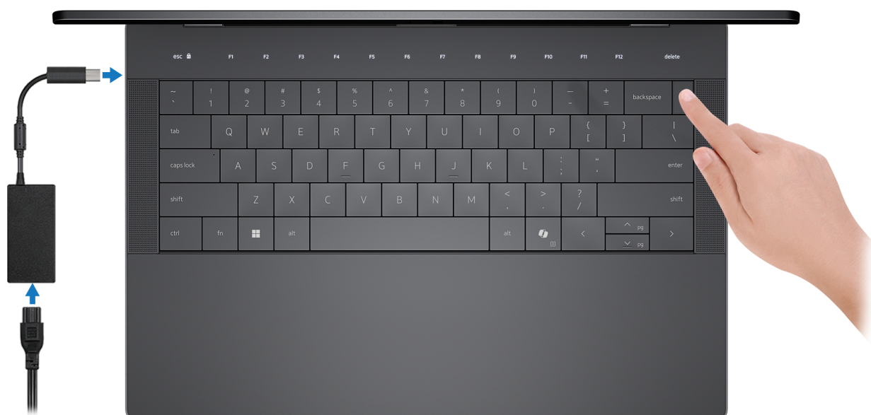
Figura 7. Collegare l'adattatore per l'alimentazione e premere il pulsante di accensione.
