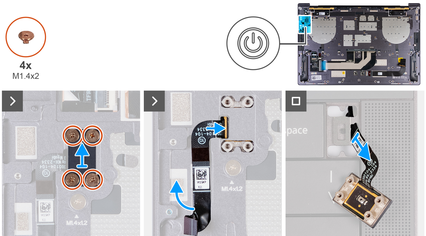
Figura 37. Rimozione del pulsante di accensione con lettore di impronte digitali
