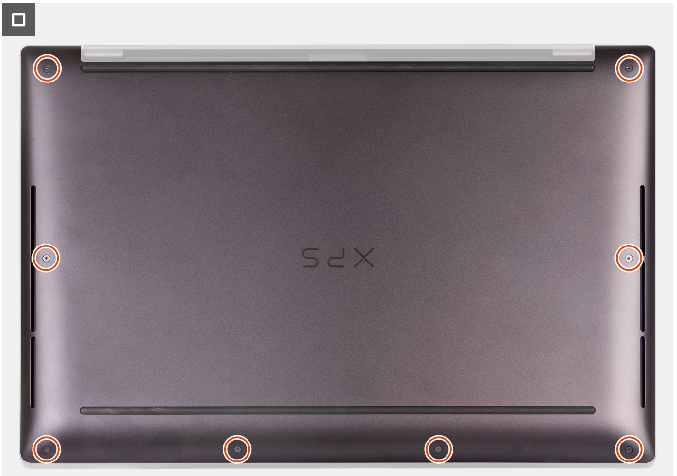
Figura 15. Serraggio delle viti di fissaggio che fissano il coperchio della base al gruppo del poggiapolsi
