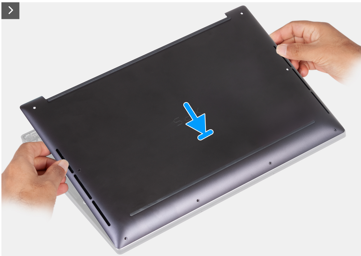
Figura 13. Posizionamento del coperchio della base negli slot sul gruppo del poggiapolsi
