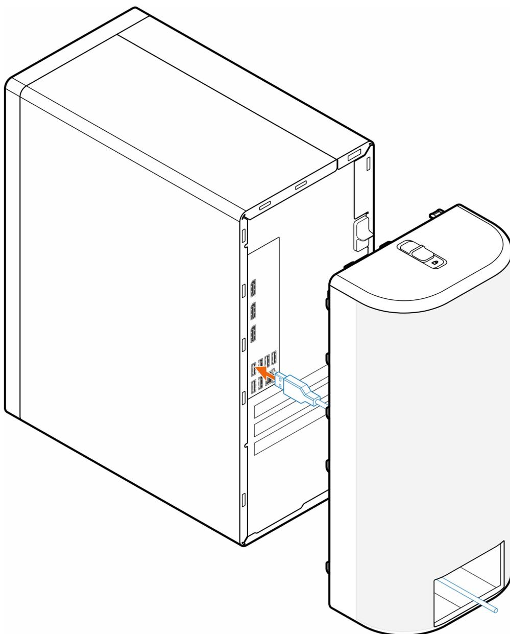
4. Alinee los ganchos de retención de la cubierta de cables con las ranuras del chasis.
