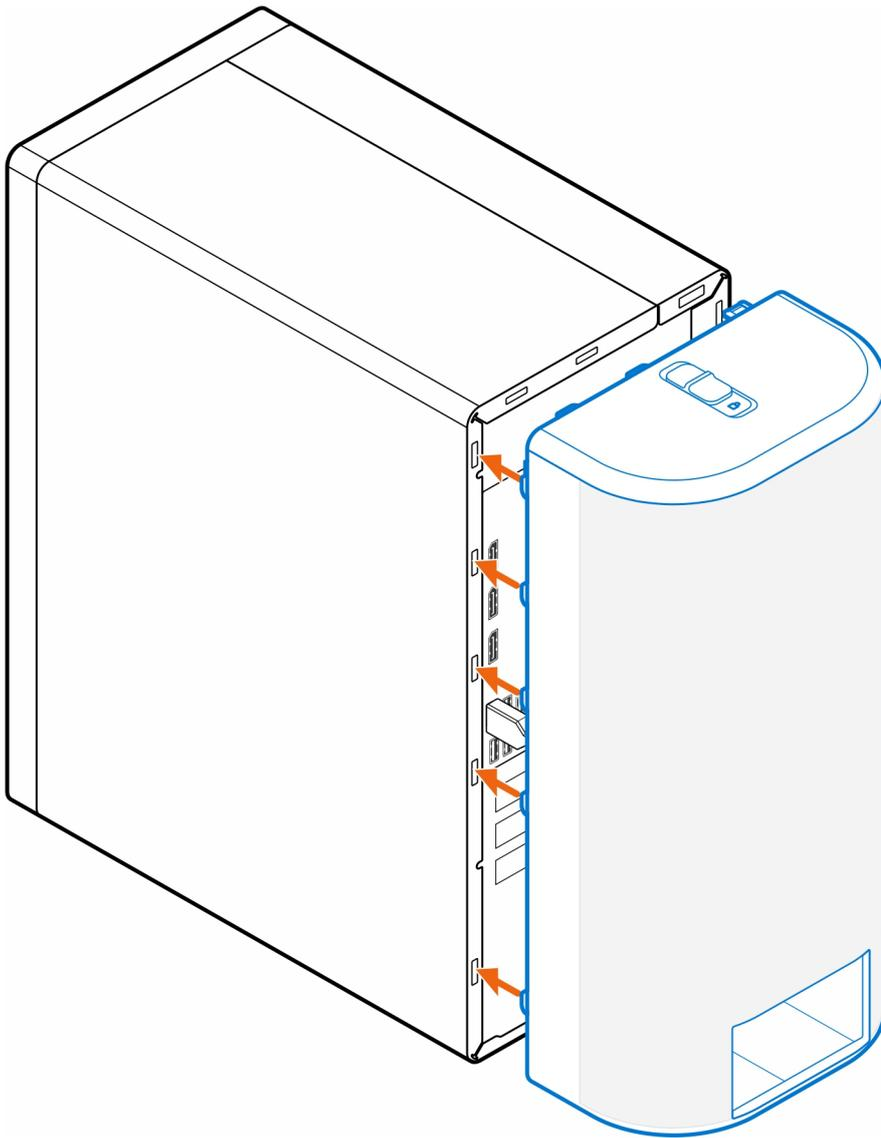
5. Empuje suavemente la cubierta de cables hasta que encaje en su lugar.
