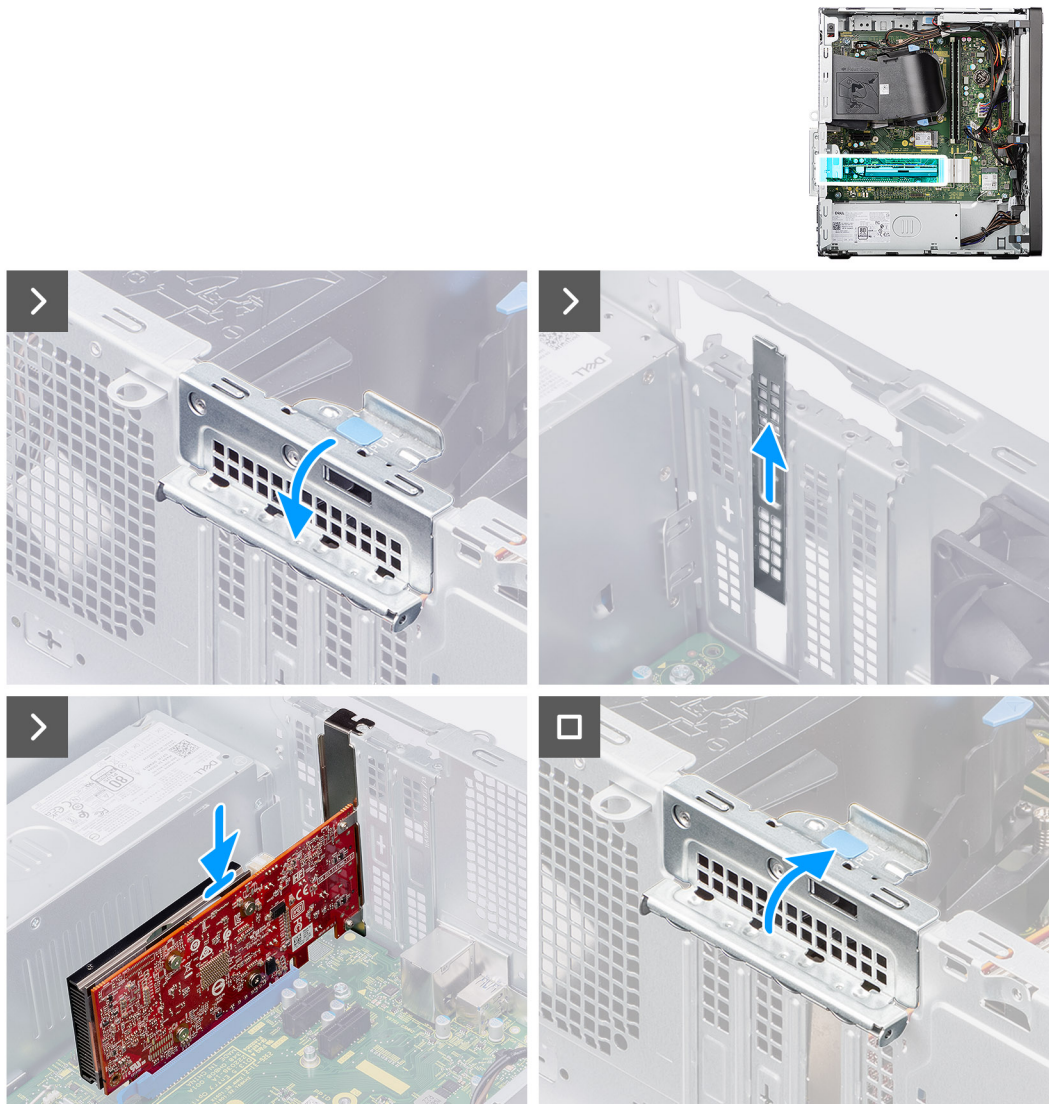
Abbildung 34. Installieren der Grafikkarte
