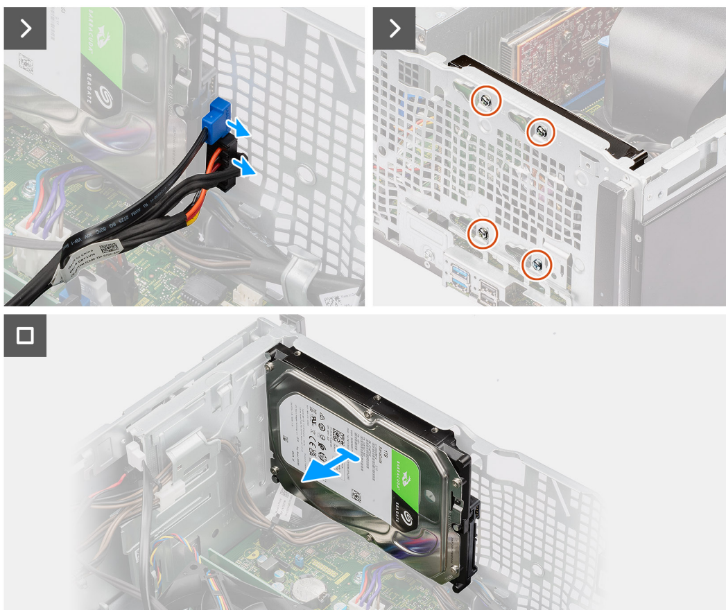
Abbildung 35. Entfernen des 3,5-Zoll-Festplattenlaufwerks
