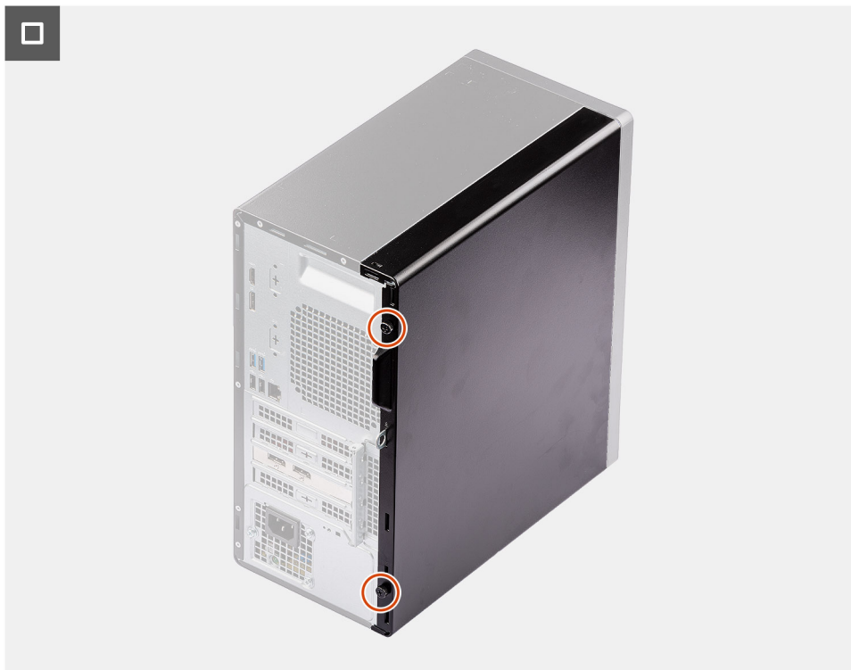
Abbildung 12. Anbringen der Seitenabdeckung
