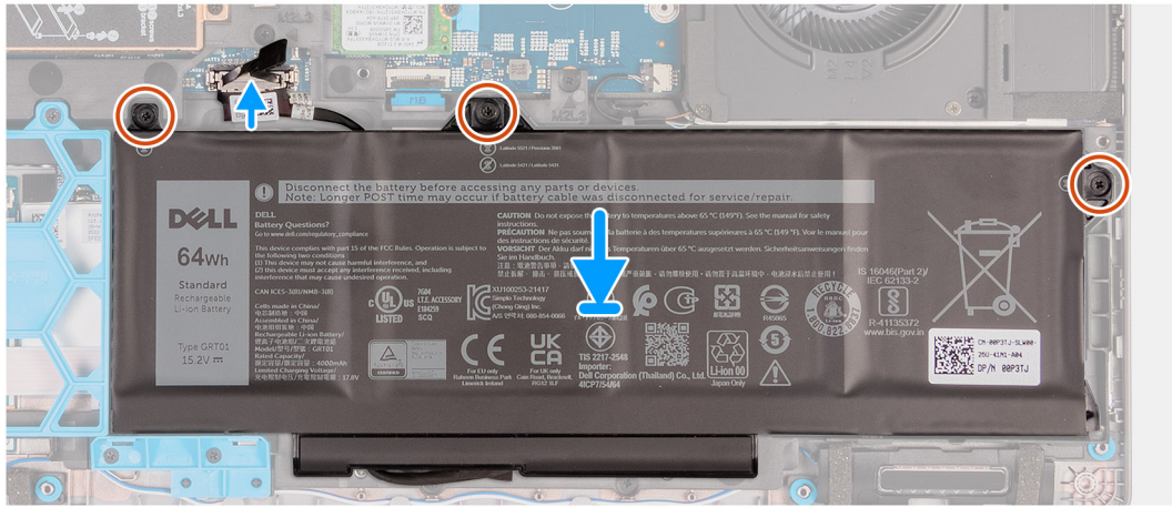
Figura39. Instalar a bateria de 64 Wh
