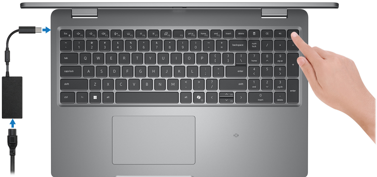
Figura 8. Ligar o transformador e premir o botão de alimentação
