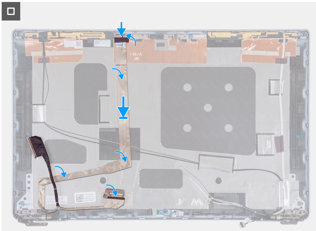
Figura95. Instalar o cabo de vídeo
