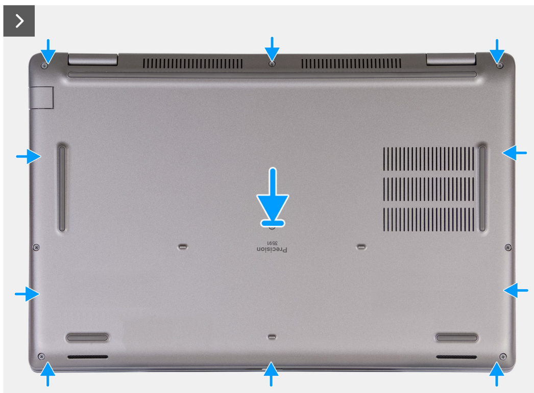
Figura17. Instalar a tampa da base
