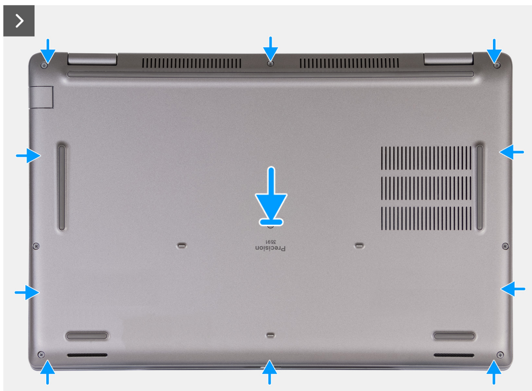
Ilustración 17. Instalación de la cubierta de la base
