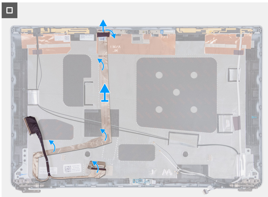
Ilustración 94. Extracción del cable de pantalla
