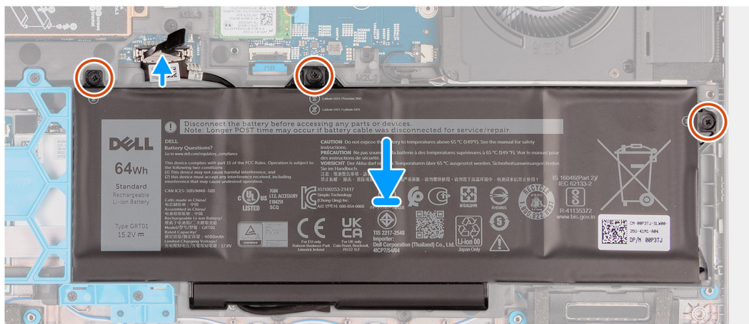
Ilustración 39. Instalación de la batería de 64 Wh
