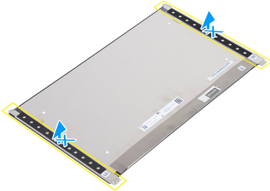
Afbeelding 83. Trek de Stretch Release-tapes (SR) niet los
