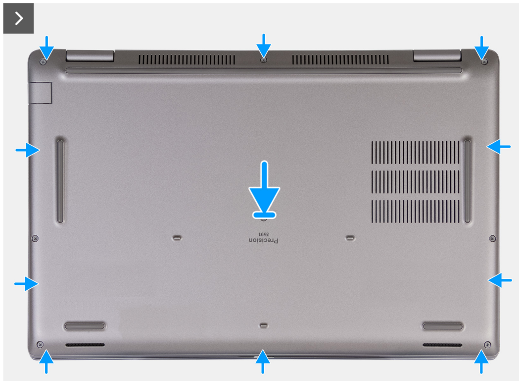
Afbeelding 17. De onderplaat plaatsen
