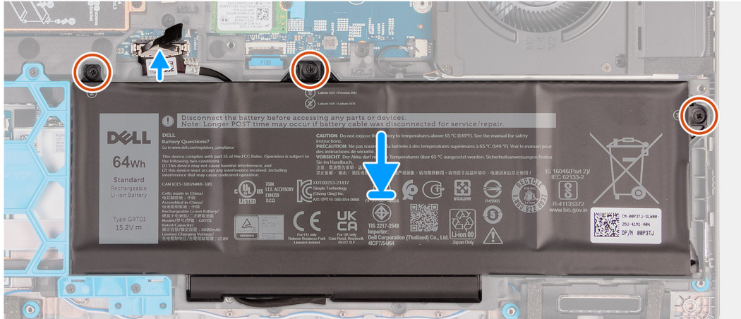
Afbeelding 39. De 64 Whr batterij installeren
