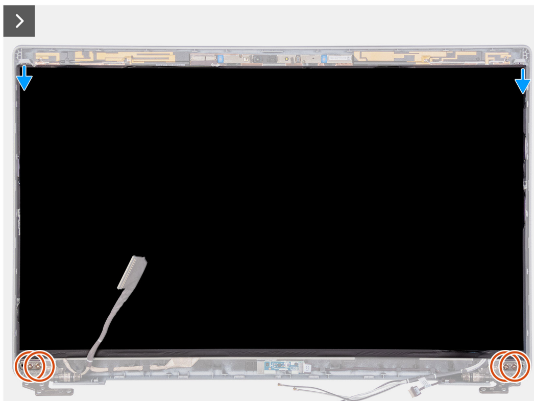
Afbeelding 80. Het beeldschermpaneel verwijderen
