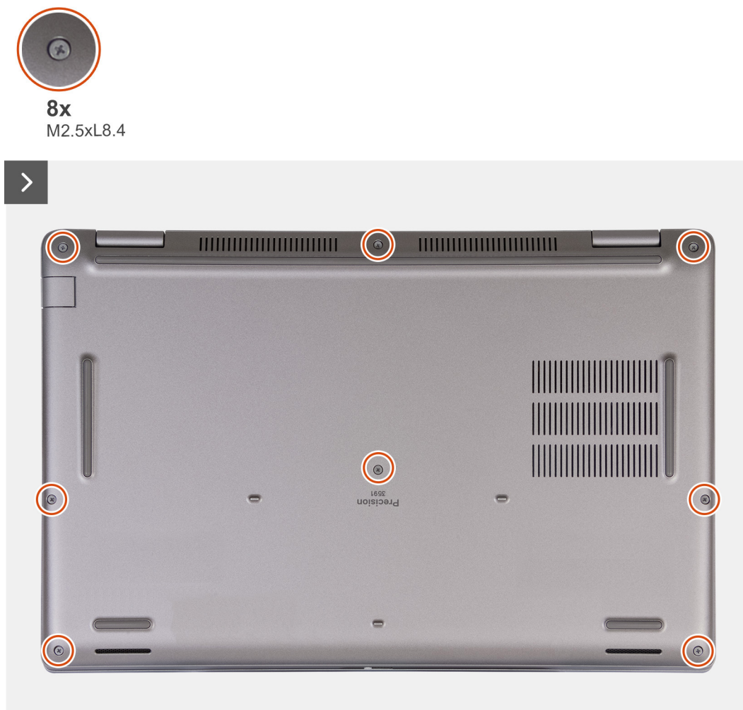
Afbeelding 13. De geborgde schroeven losdraaien
