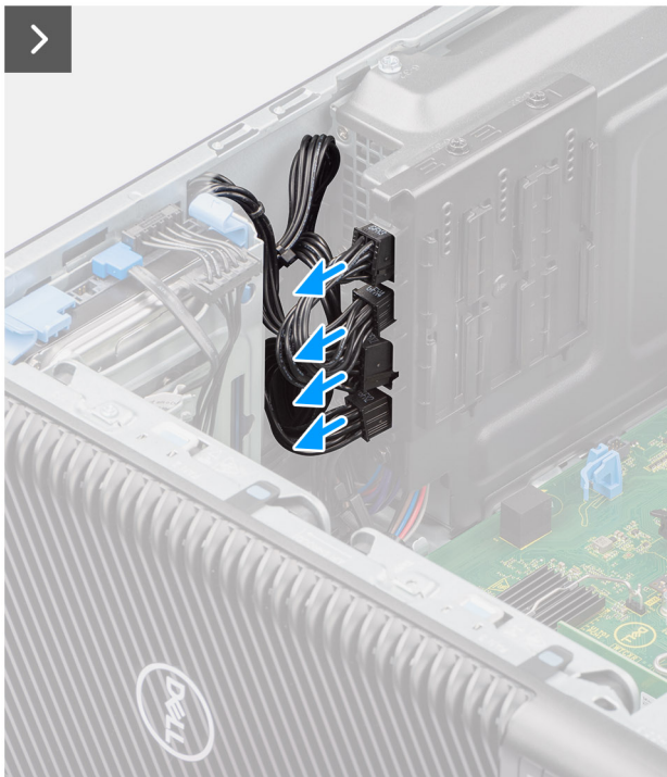
Obrázek 46. Demontáž krytu jednotky napájecího zdroje
