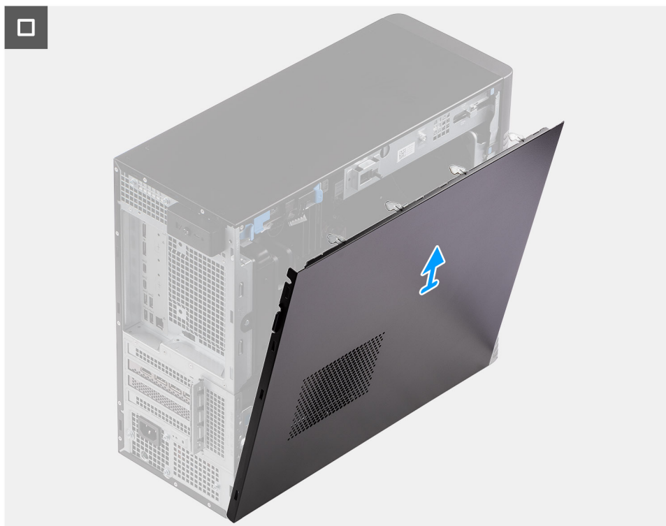
Obrázek 9. Demontáž bočního krytu
