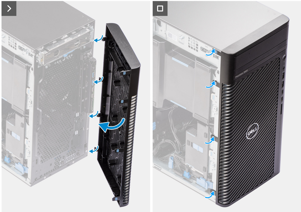
Obrázek 13. Montáž čelního krytu
