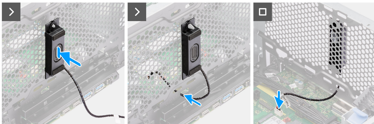
Obrázek 73. Montáž interního reproduktoru
