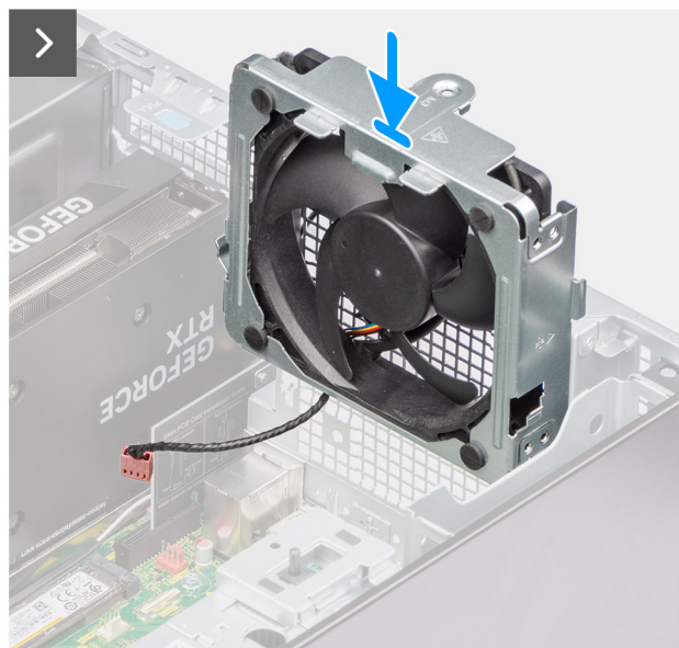
Obrázek 67. Montáž zadního ventilátoru (1 000W napájecí zdroj)
