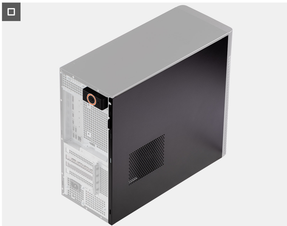
Obrázek 11. Montáž bočního krytu
