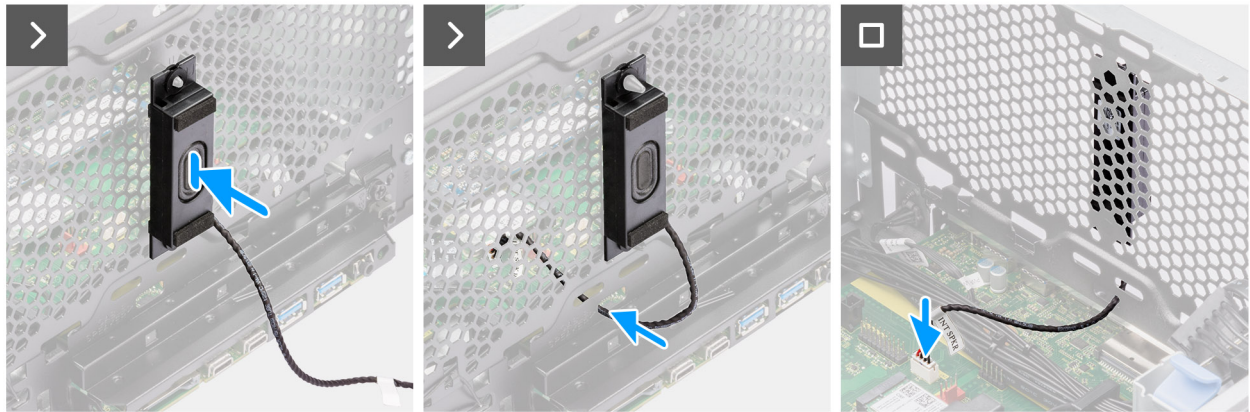
Figure 73. Installation du haut-parleur interne
