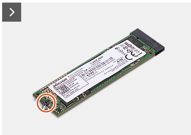
Figur 24. Ta bort M.2 2280 PCIe SSD-disken
