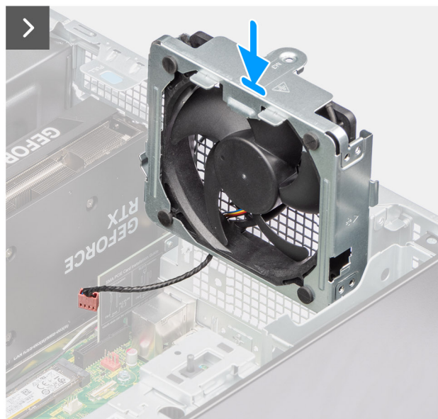
Figur 67. Installera den bakre fläkten (nätaggregat på 1 000 W)
