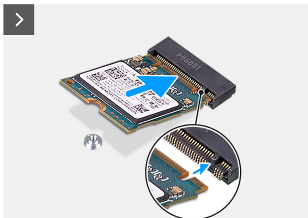
Figur 23. Installera M.2 2230 PCIe SSD-disken
