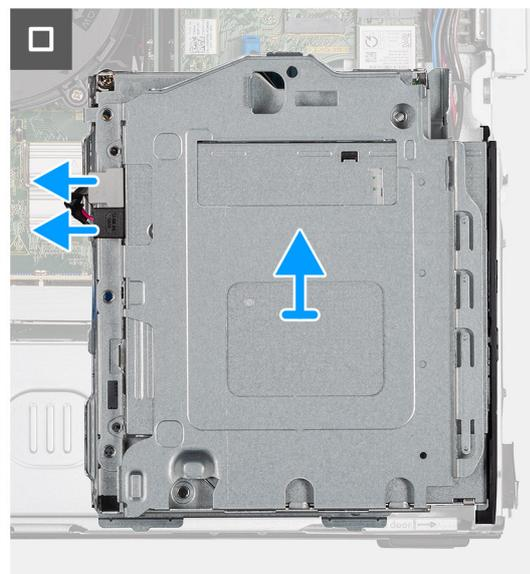
Abbildung 11. Entfernen des Festplattengehäuses
