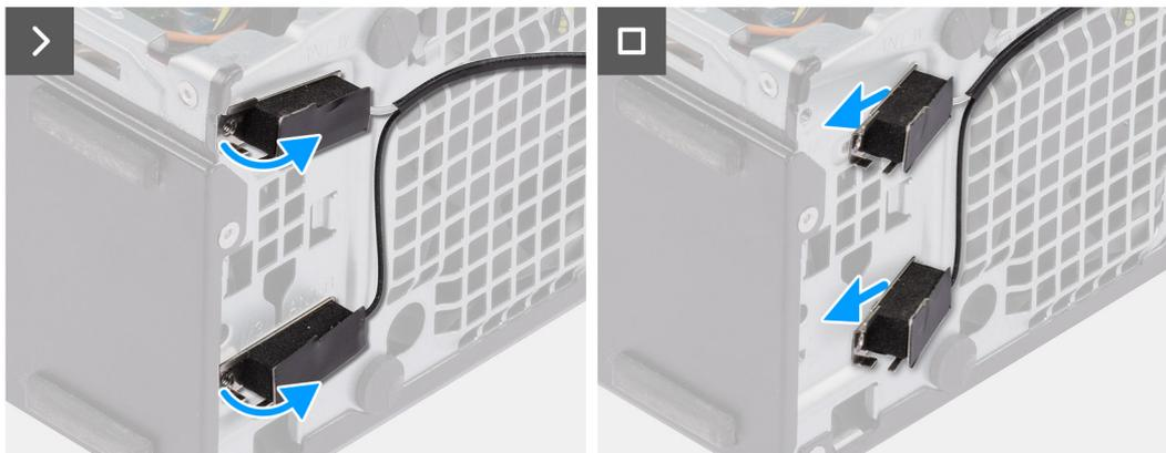
Abbildung 37. Entfernen des internen Antennenmoduls
