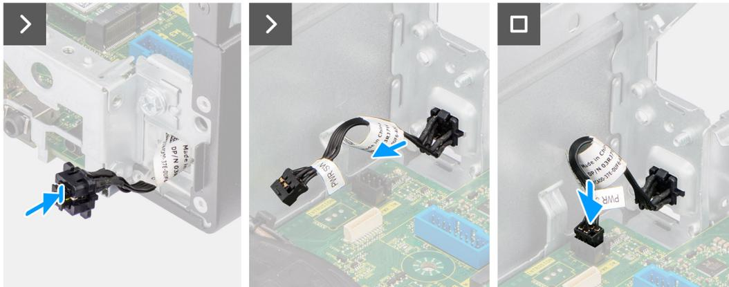
Abbildung 36. Einbauen des Netzschalters
