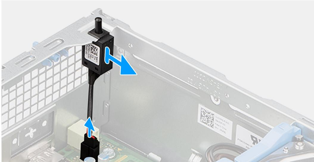
Abbildung 33. Entfernen des Eingriffsschalters
