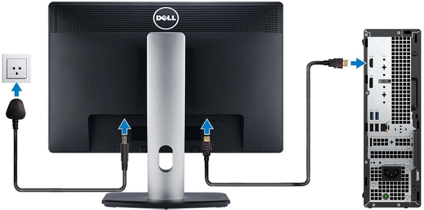
4. Schließen Sie das Stromkabel an.
