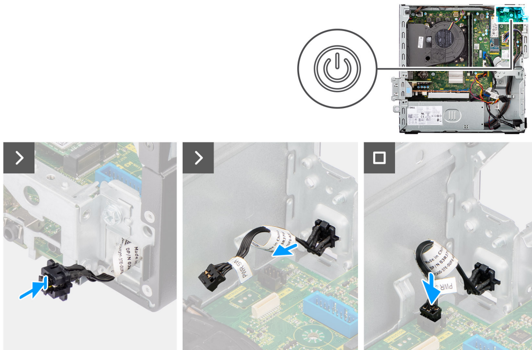
Figure 36. Installation du bouton d'alimentation
