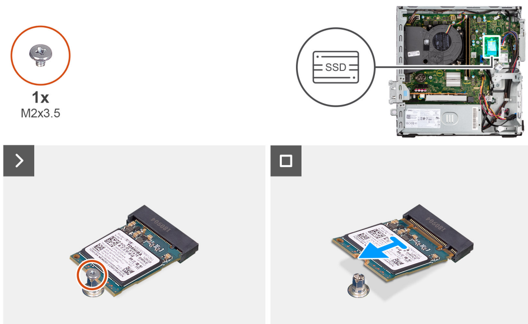
Figure 17. Retrait du disque SSD M.2 2230
