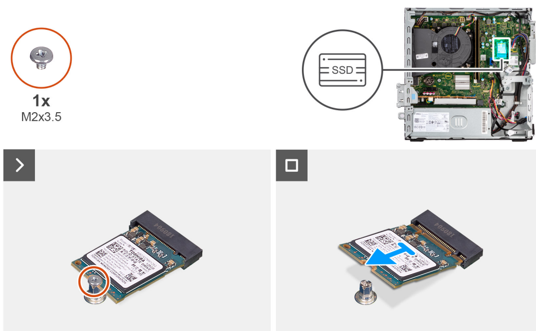
Figura 17. Rimozione dell'unità SSD M.2 2230
