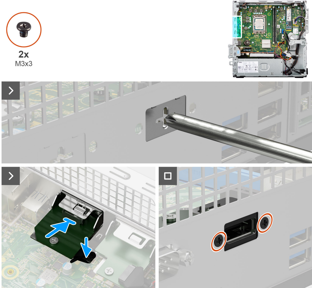
Figura 53. Installazione del modulo DisplayPort
