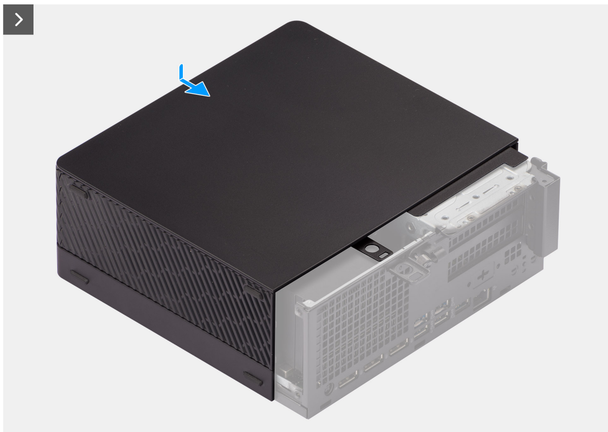
Obrázek 12. Montáž bočního krytu
