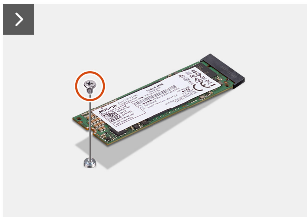
Obrázek 23. Demontáž disku SSD M.2 2280 PCIe (slot 2)
