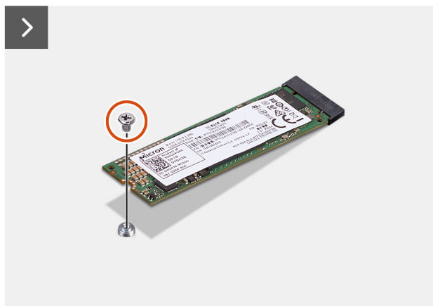
Obrázek 22. Demontáž disku SSD M.2 2280 PCIe (slot 1)
