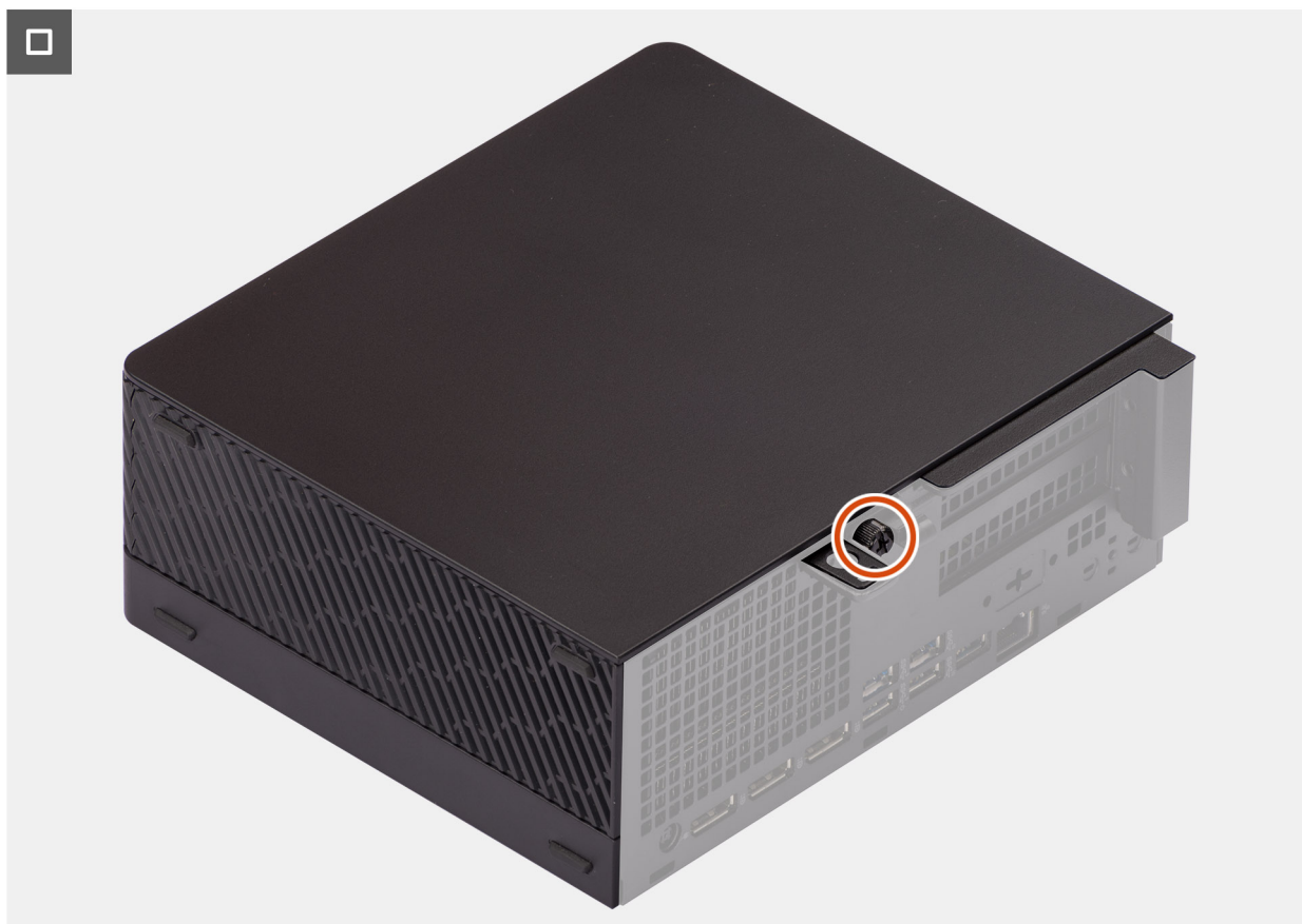
Obrázek 13. Montáž bočního krytu
