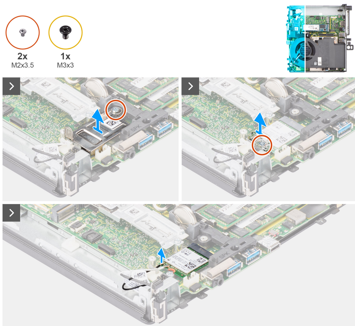
Obrázek 54. Demontáž interní antény – poloha 2
