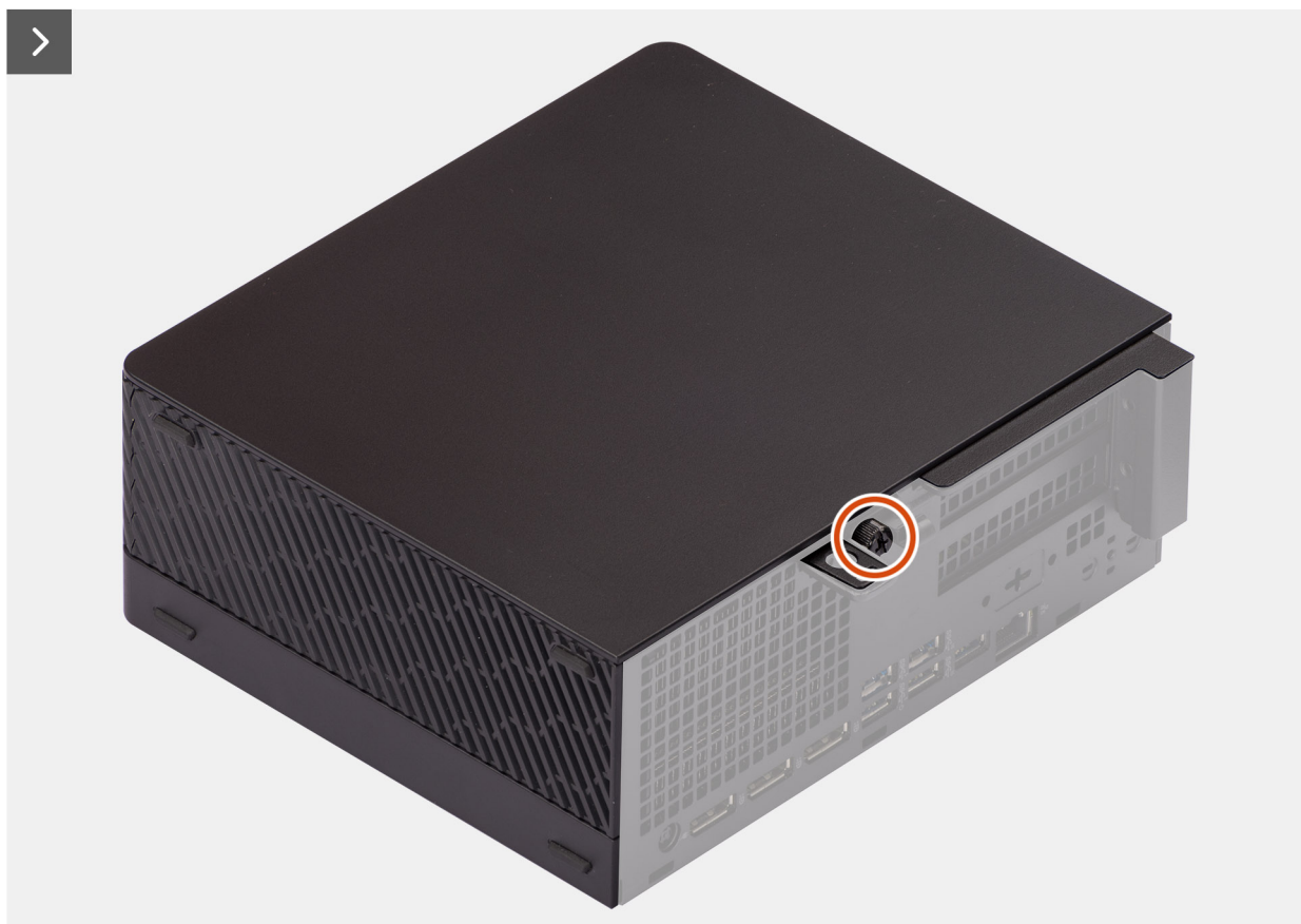
Obrázek 10. Demontáž bočního krytu
