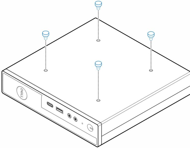
6. Alignez la vis à pas (M4x4) avec les encoches du support mural et montez l'ordinateur sur le support mural.
