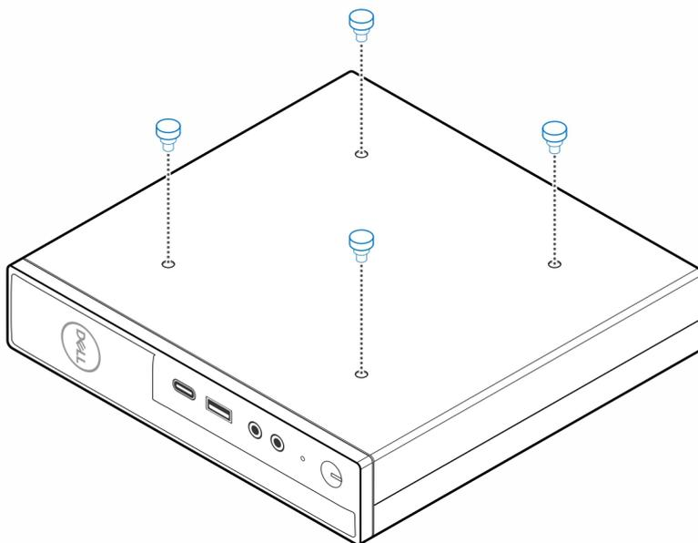
5. Alignez les vis à pas (M4x4) avec les encoches du support de bureau et montez l'ordinateur sur le support de bureau.
