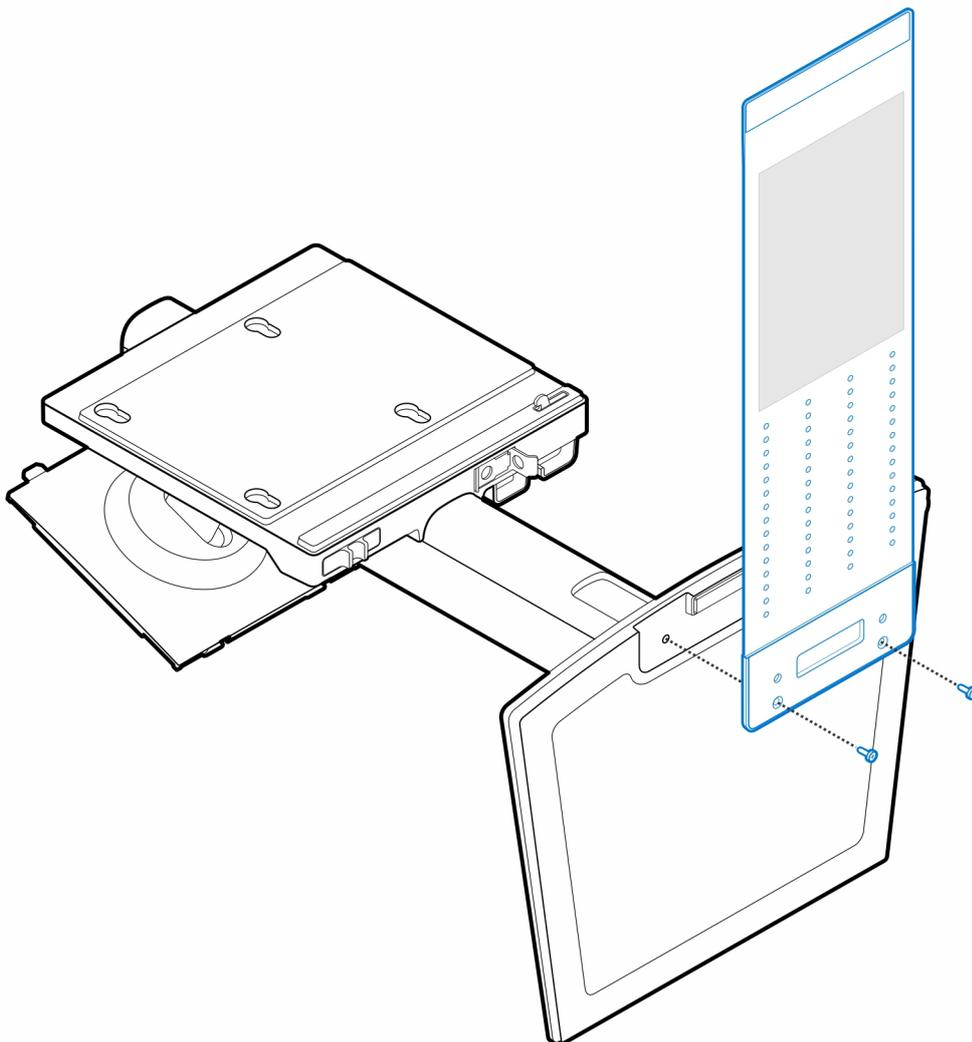
2. Installez les quatre vis à pas(M4x4) sur le boîtier.
