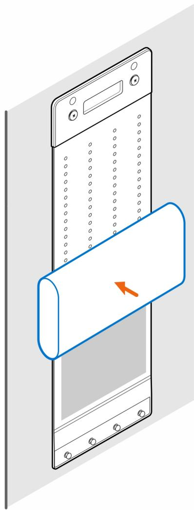
8. Entourez l'adaptateur secteur avec le manchon et insérez les languettes de fixation dans les trous du manchon de l'adaptateur secteur à un niveau approprié.
