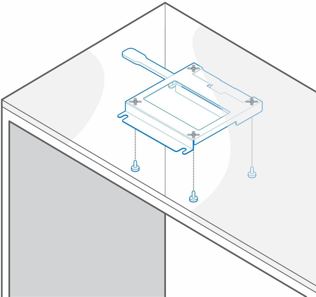
4. Installez les quatre vis à pas(M4x4) sur le boîtier.
