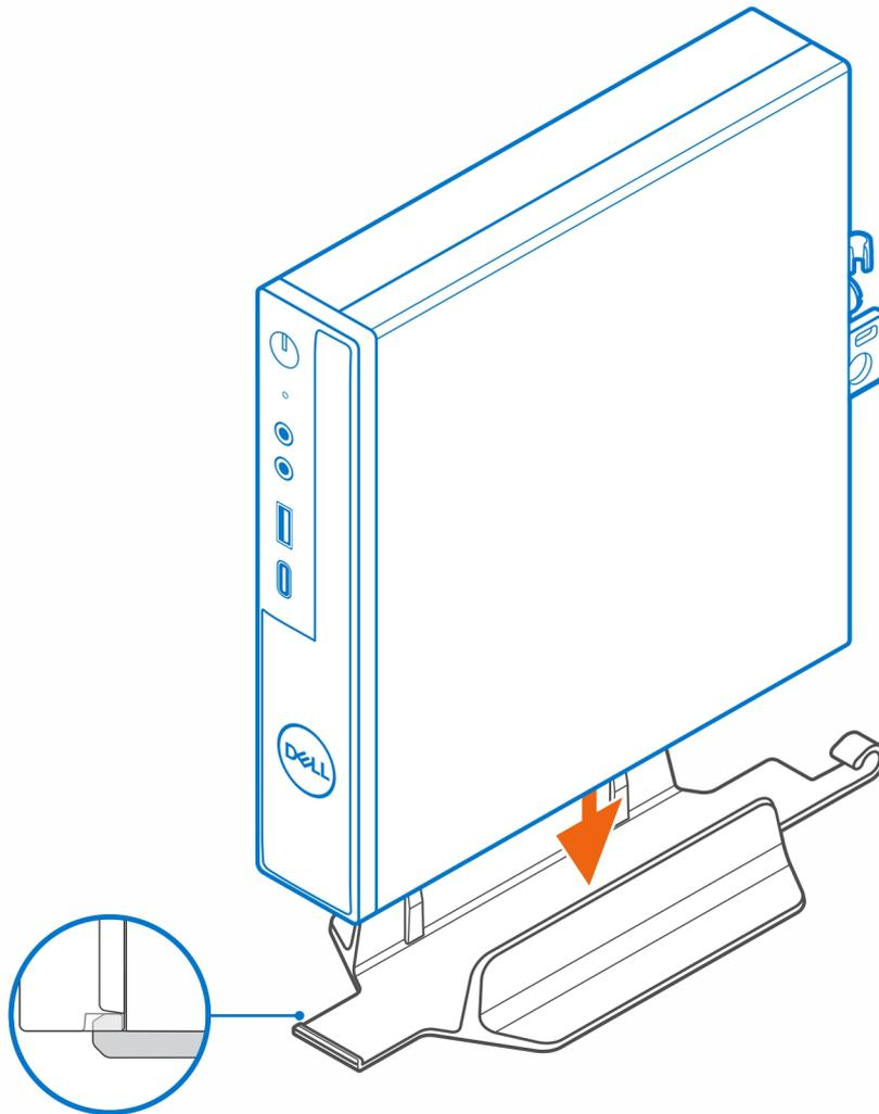
**REMARQUE :** Veillez à aligner le logement du boîtier avec la languette située sur le socle vertical afin d'éviter que l'ordinateur ne glisse du socle vertical.
