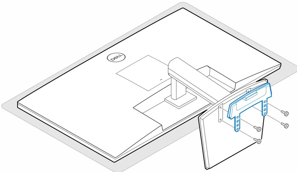
4. Installez les deux vis (M3x6) pour fixer le manchon de l'adaptateur secteur (montée de gamme) au socle tout-en-un.
