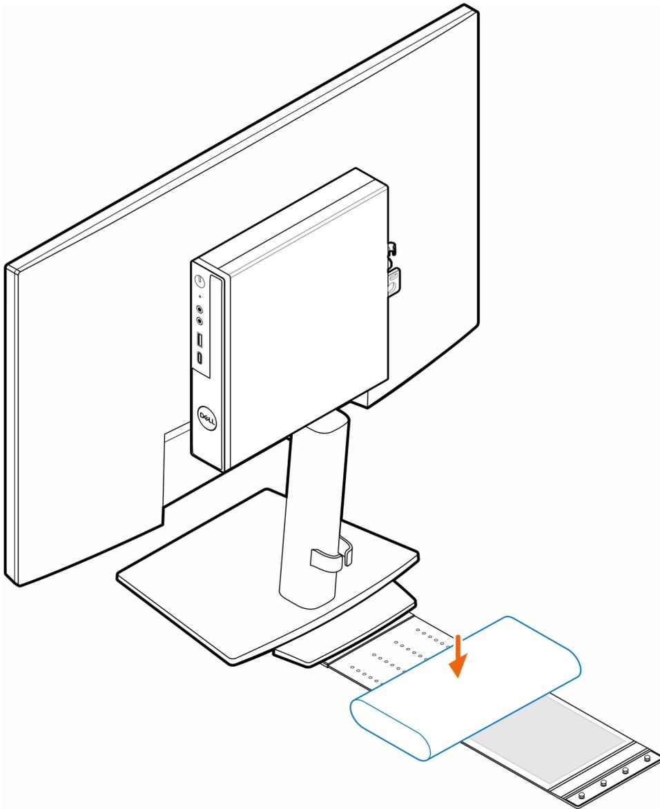
10. Entourez l'adaptateur secteur avec le manchon et insérez les languettes de fixation dans les trous du manchon de l'adaptateur secteur à un niveau approprié.
