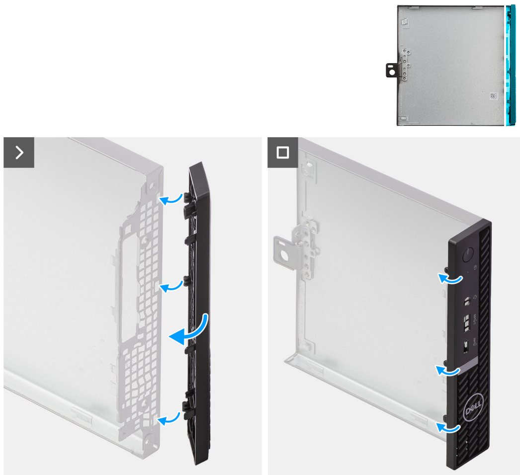
Figure 16. Installation du panneau avant
