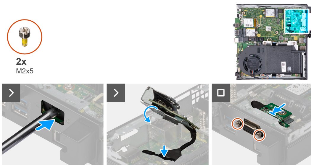
Abbildung 37. Installieren eines optionalen E/A-Moduls (VGA oder Seriell)
