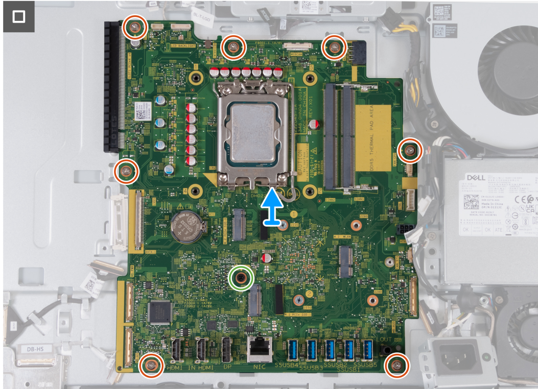
Figura 67. Rimozione della scheda di sistema
