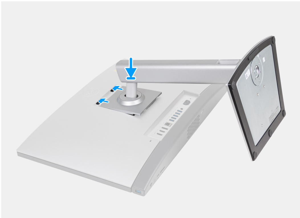
Figura 17. Installazione del supporto ad altezza regolabile (HAS)
