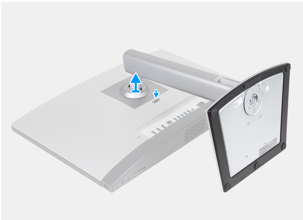
Figura 15. Rimozione del supporto ad altezza regolabile (HAS)
