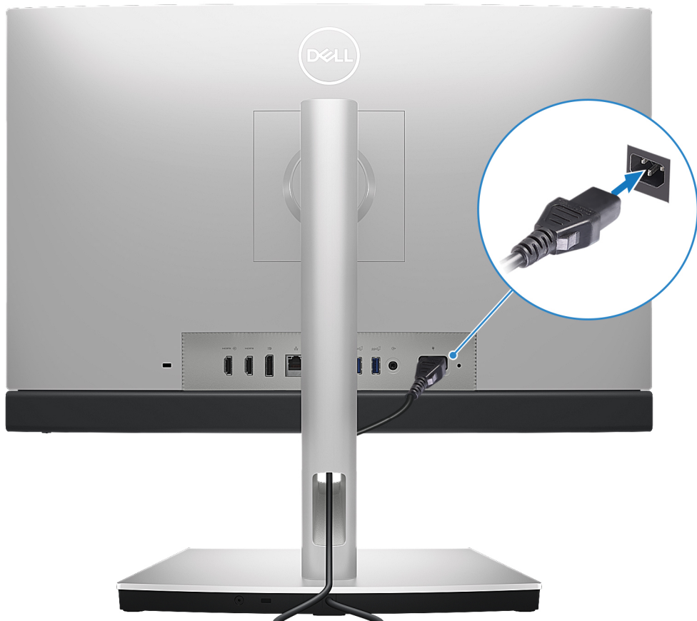
Figura 12. Collegamento del cavo di alimentazione
