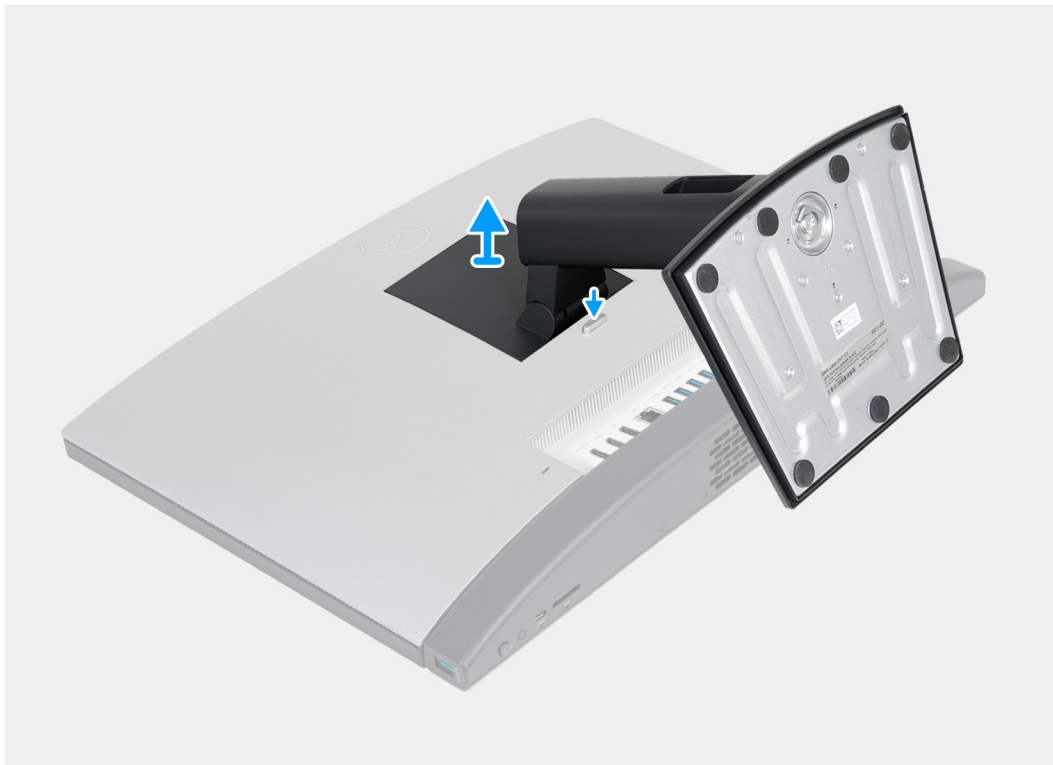
Figura 16. Rimozione del supporto fisso
