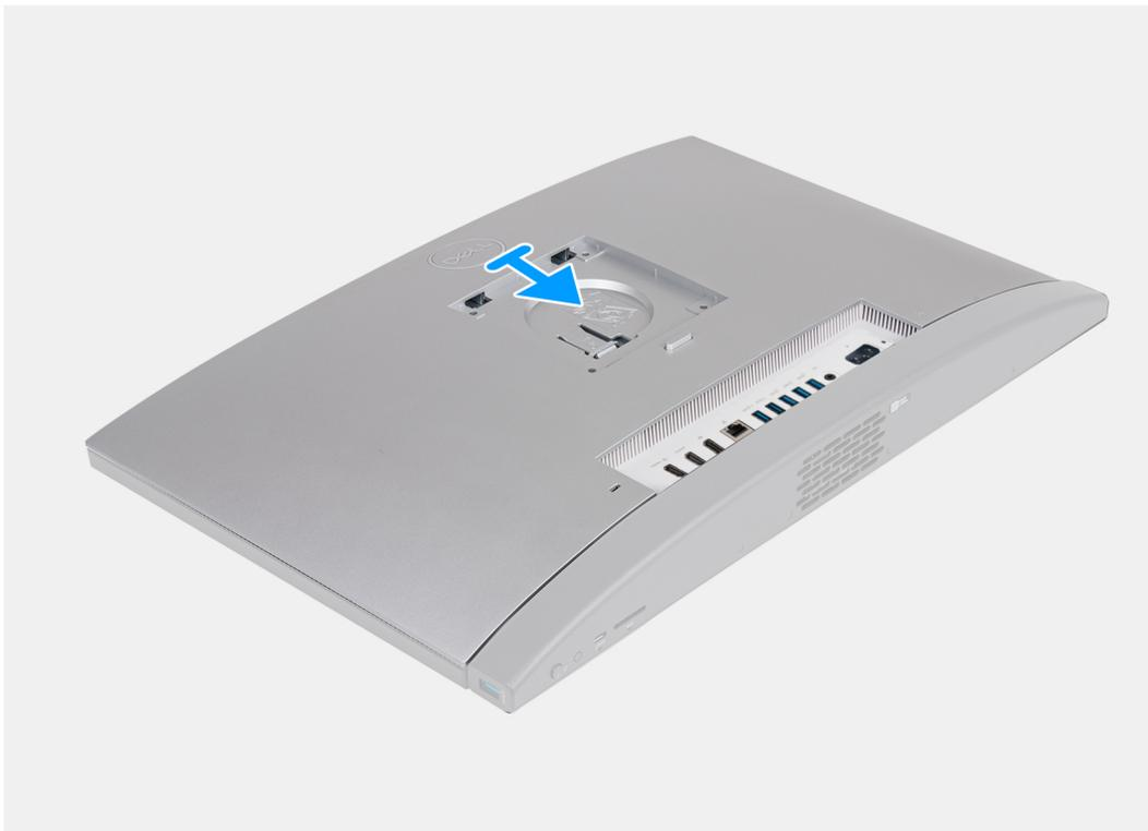
Abbildung 20. Einbauen der rückseitigen Abdeckung
