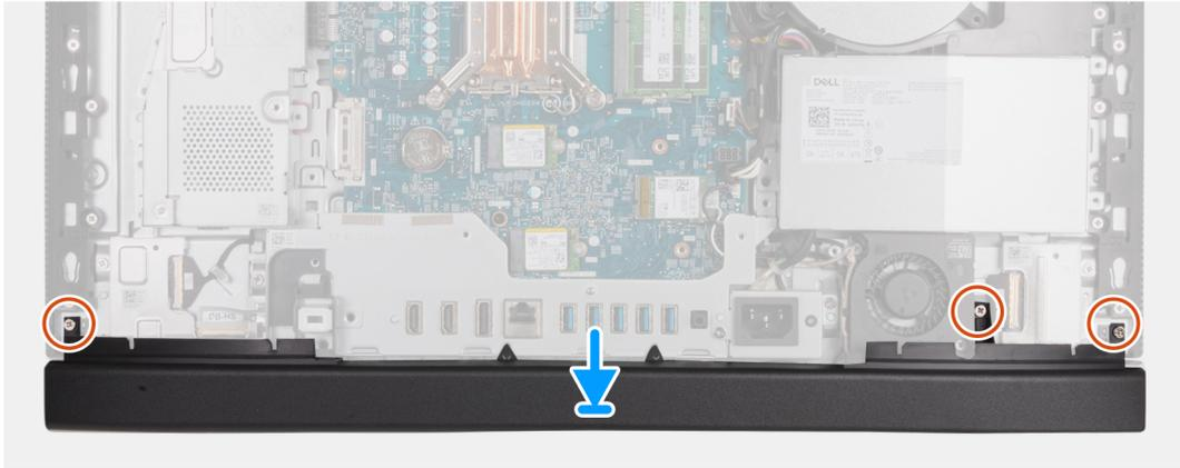
**Abbildung 44. Anbringen der unteren Abdeckung**
