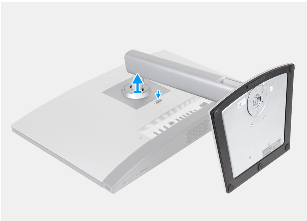
Abbildung 15. Entfernen des höhenverstellbaren Ständers (HAS)
