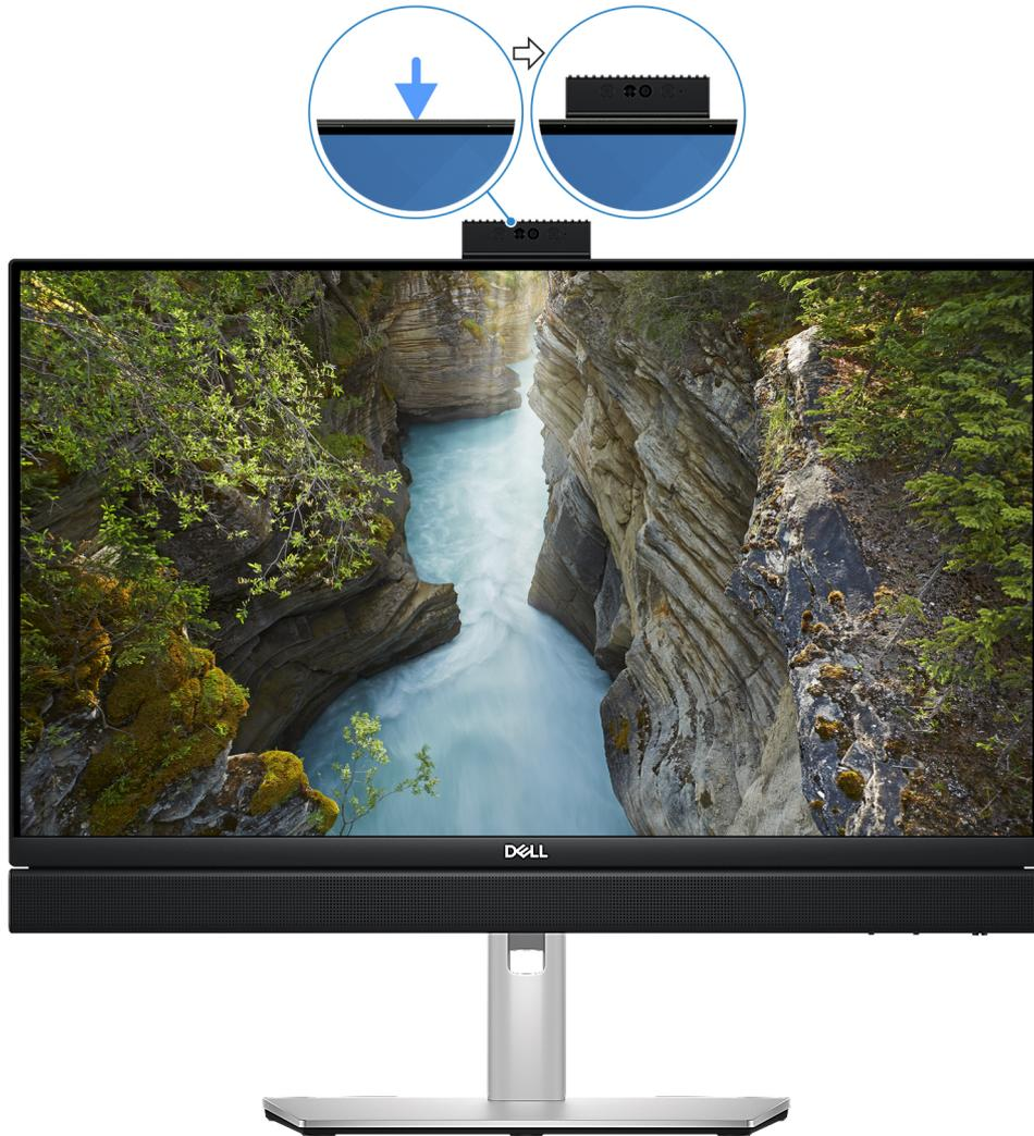
Abbildung 4. Auf einziehbare Kamera zugreifen
