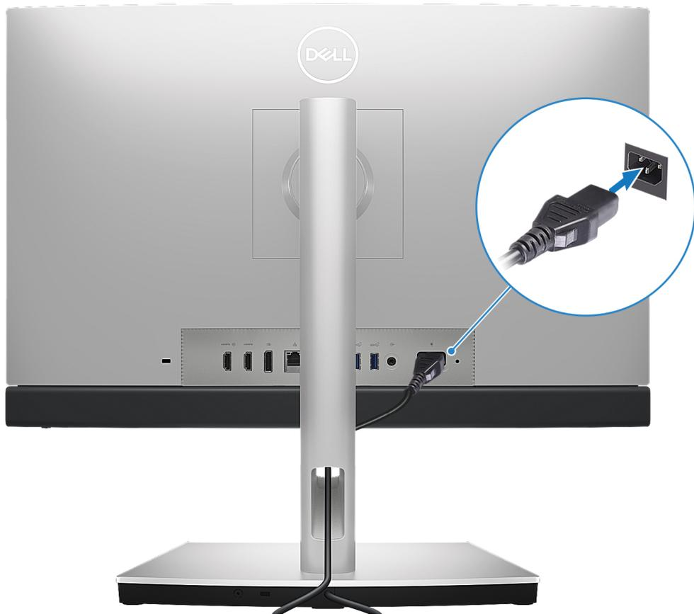
**Abbildung 12. Anschließen des Stromkabels**
