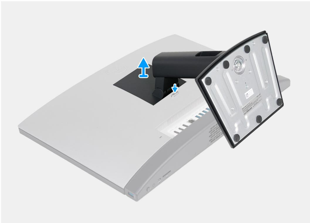
**Abbildung 16. Entfernen des feststehenden Ständers**
