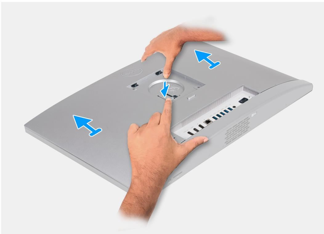
Abbildung 19. Entfernen der rückseitigen Abdeckung
