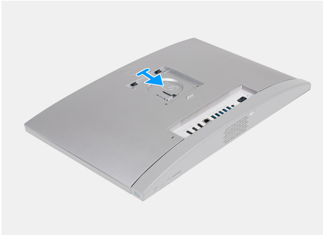
Figure 20. Installation du capot arrière
