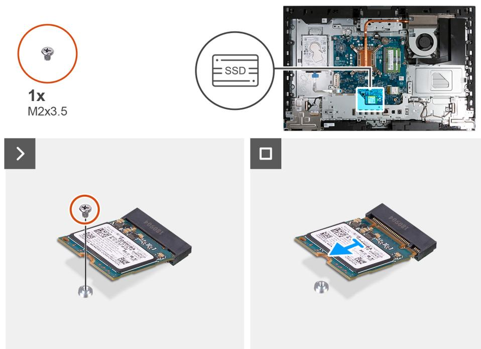
Figure 90. Retrait du disque SSD M.2 2230
