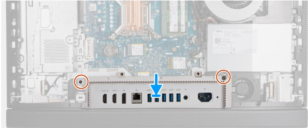
Figure 43. Installation du cache d'E/S
