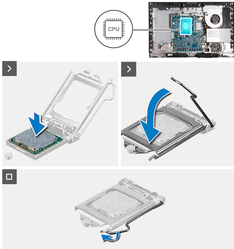
Figure 65. Installation du processeur
