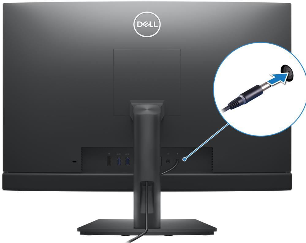
**Figure 12. Branchement du câble de l'adaptateur secteur**
