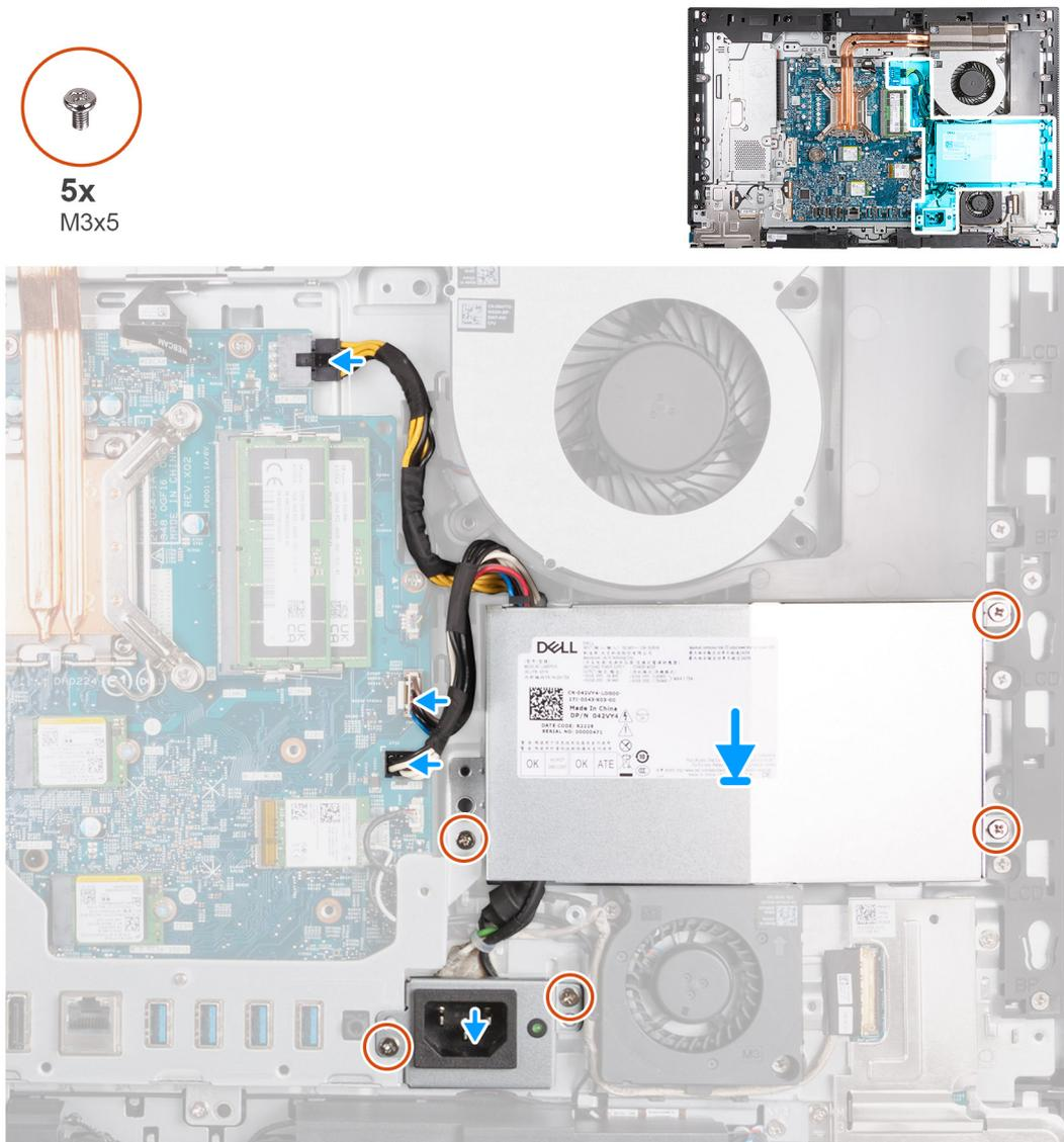
Figure 51. Installation du bloc d'alimentation
