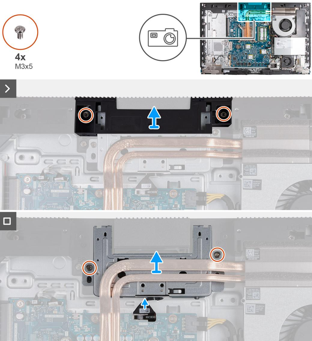
**Figure 46. Retrait de l'assemblage de la caméra escamotable**
