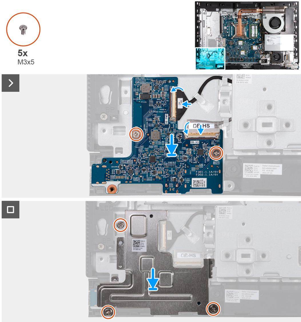
Figure 73. Installation du bouton d'alimentation et de la carte d'E/S
