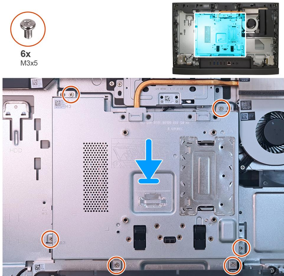
Figure 87. Pose de la protection de la carte système
