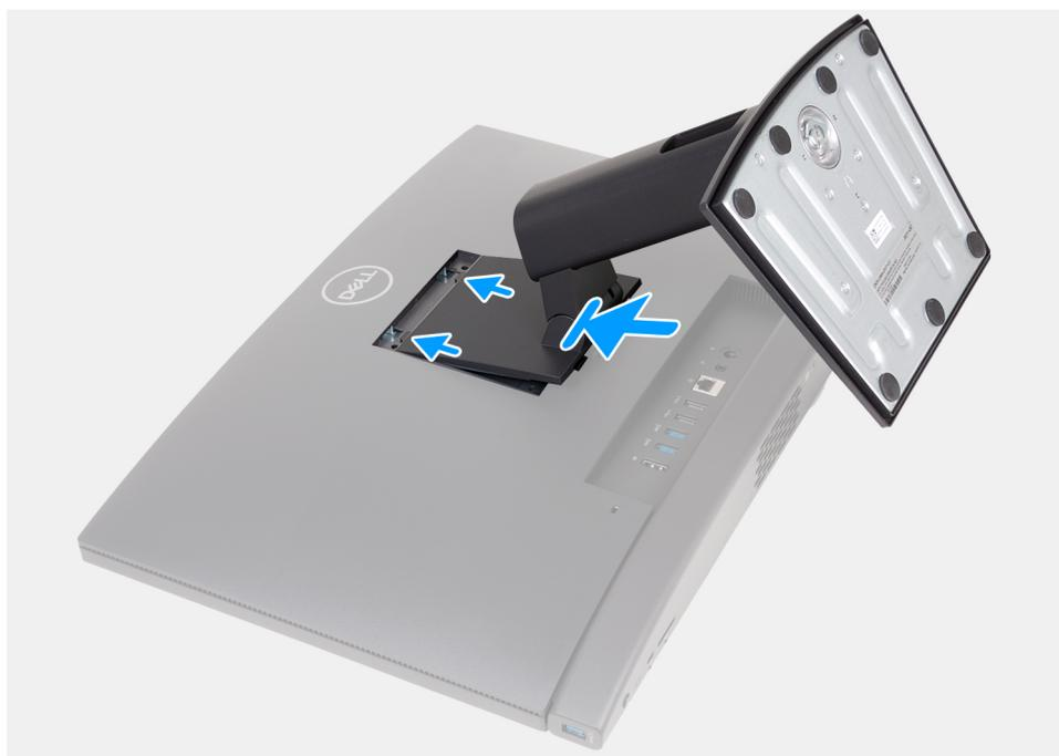
Figure 80. Installation du socle
