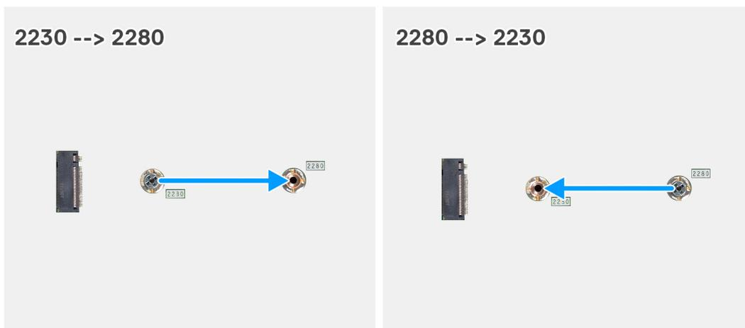
Figure 34. Déplacement du support de vis du disque SSD sur le logement M.2 0
