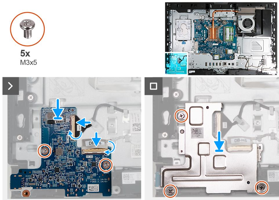
Figure 120. Installation de la carte d'E/S et du bouton d'alimentation
