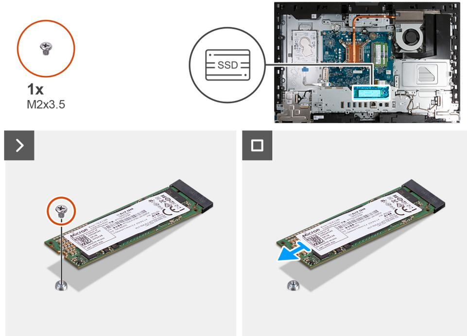
Figure 92. Retrait du disque SSD M.2 2280
