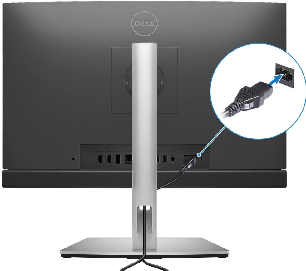
**Figure 13. Branchement du câble d'alimentation**
