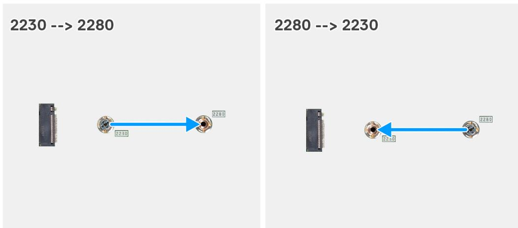
Figure 39. Déplacement du support de vis du disque SSD sur le logement M.2 1
