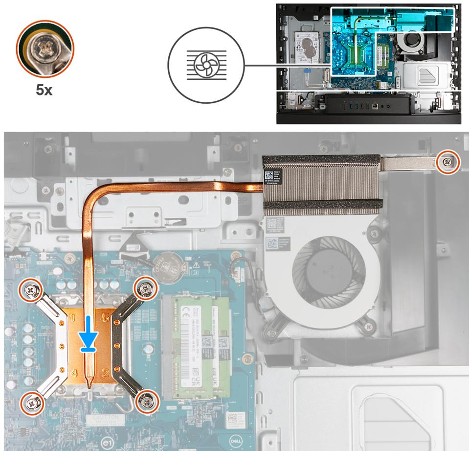
Figure 110. Installation du dissipateur de chaleur
