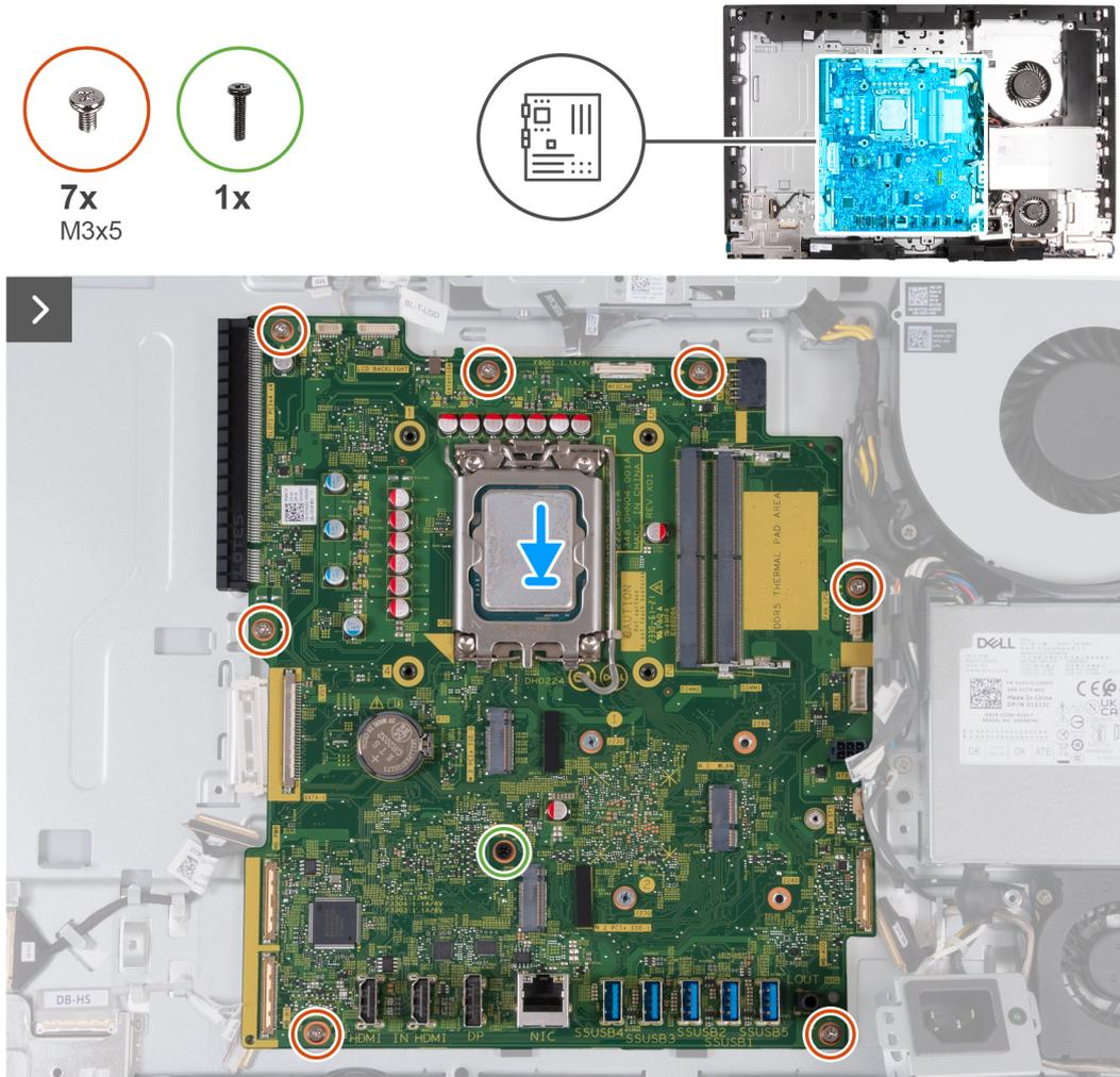
Figure 70. Installation de la carte système
