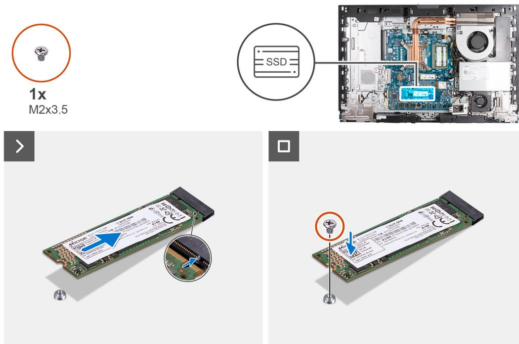
Figure 38. Installation du disque SSD M.2 2280 dans le logement M.2 1
