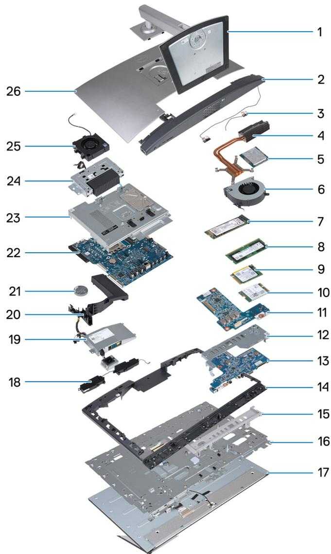
**Figure 16. Principaux composants de votre ordinateur OptiPlex All-in-One 7420 avec un processeur hautes performances**
