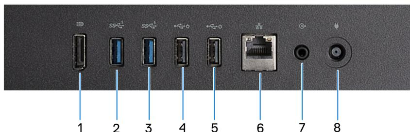
Figure 7. Vue du panneau arrière de l'ordinateur OptiPlex All-in-One 7420 avec un processeur écoénergétique
