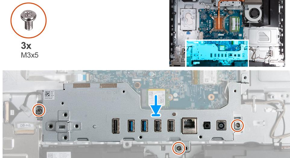
Figure 106. Installation du support d'E/S
