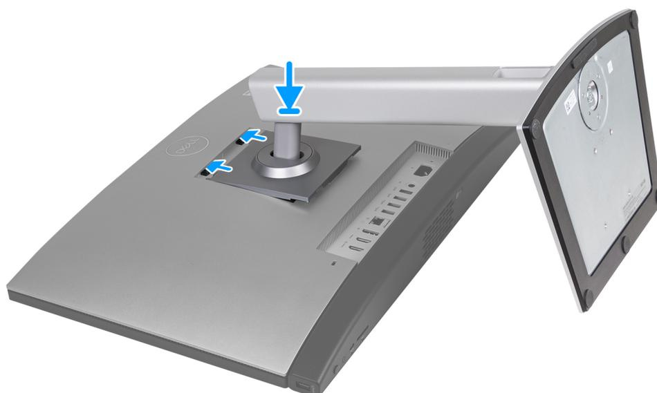
Figure 81. Installation du socle
