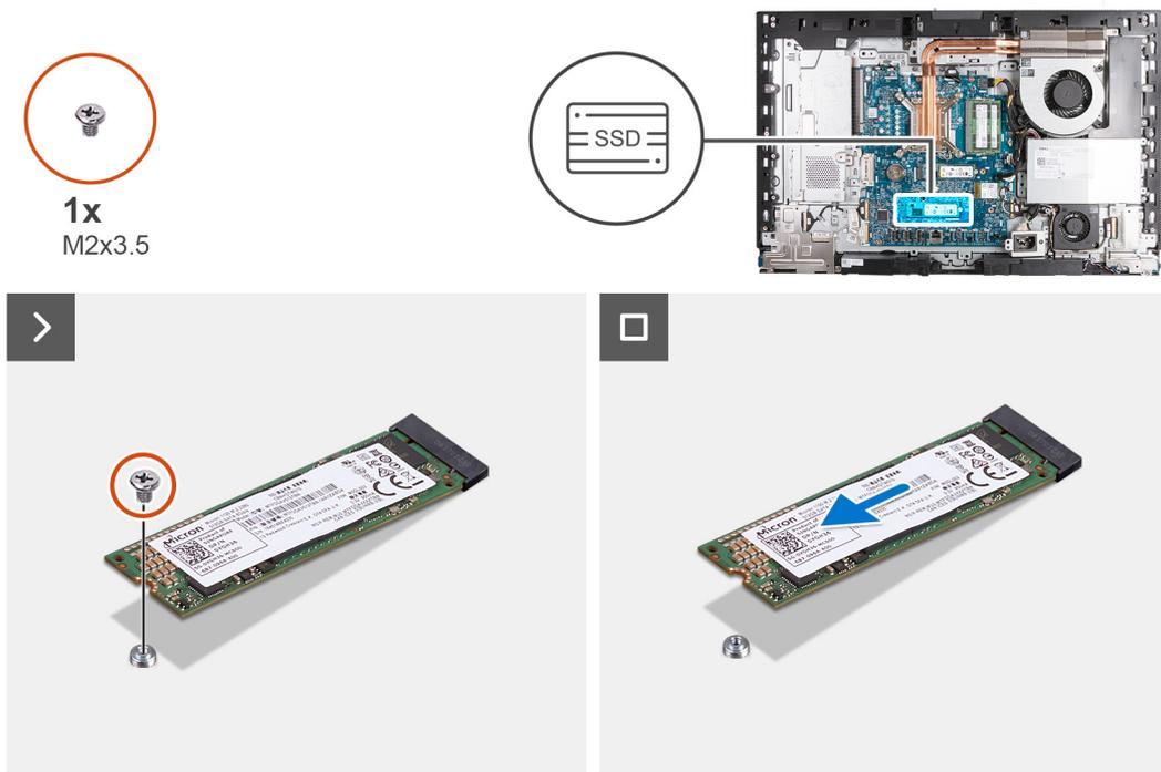
Figure 37. Retrait du disque SSD M.2 2280 du logement M.2 1
