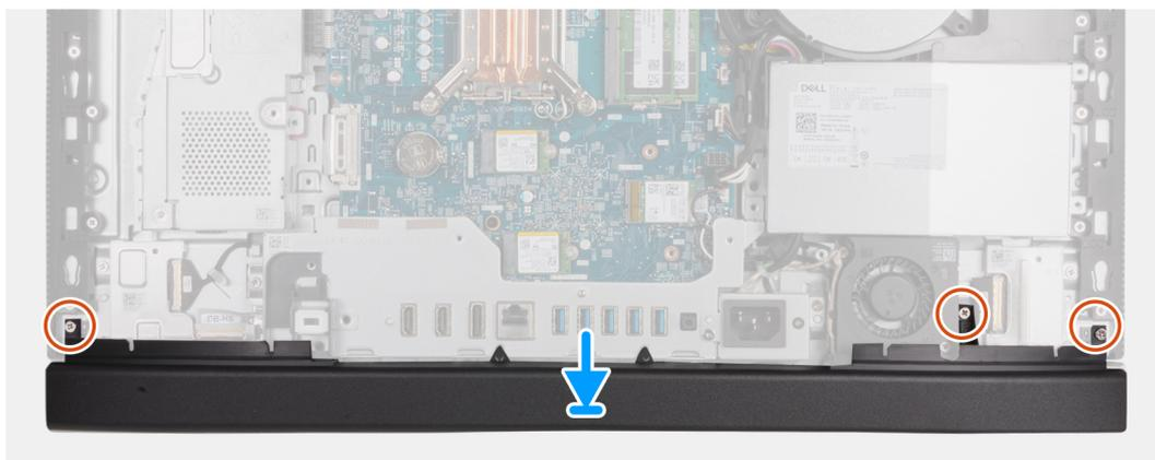
**Figure 45. Installation du capot inférieur**
