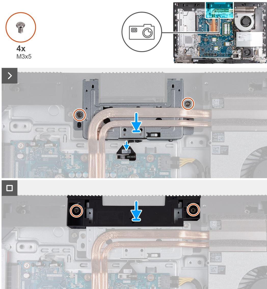
**Figure 47. Installation de l'assemblage de la caméra escamotable**
