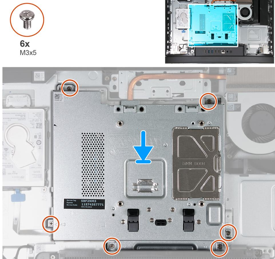
Figure 27. Pose de la protection de la carte système
