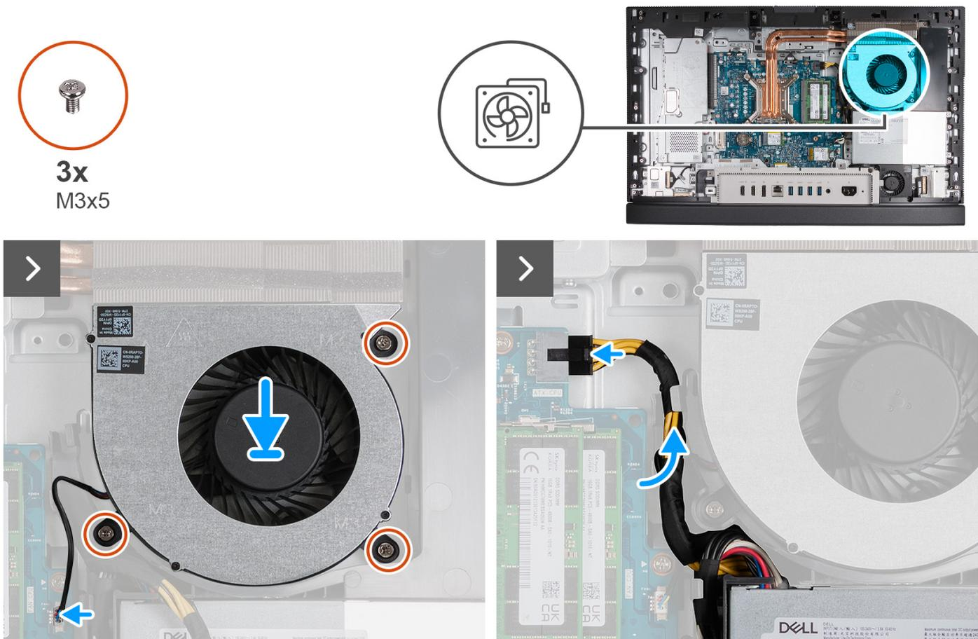
Figure 49. Installation du ventilateur
