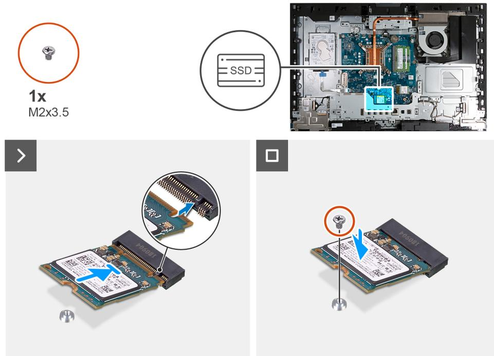
Figure 91. Installation du disque SSD M.2 2230
