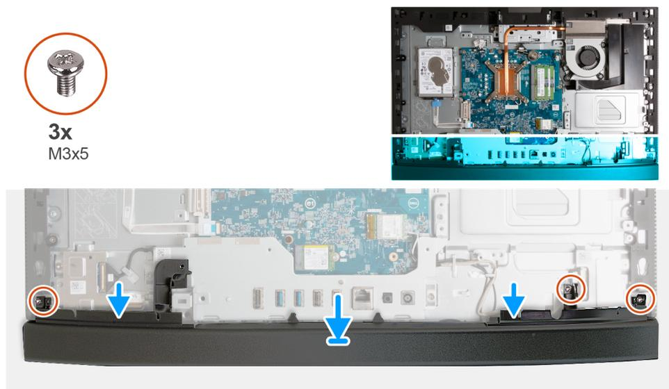
Figure 100. Installation du capot inférieur
