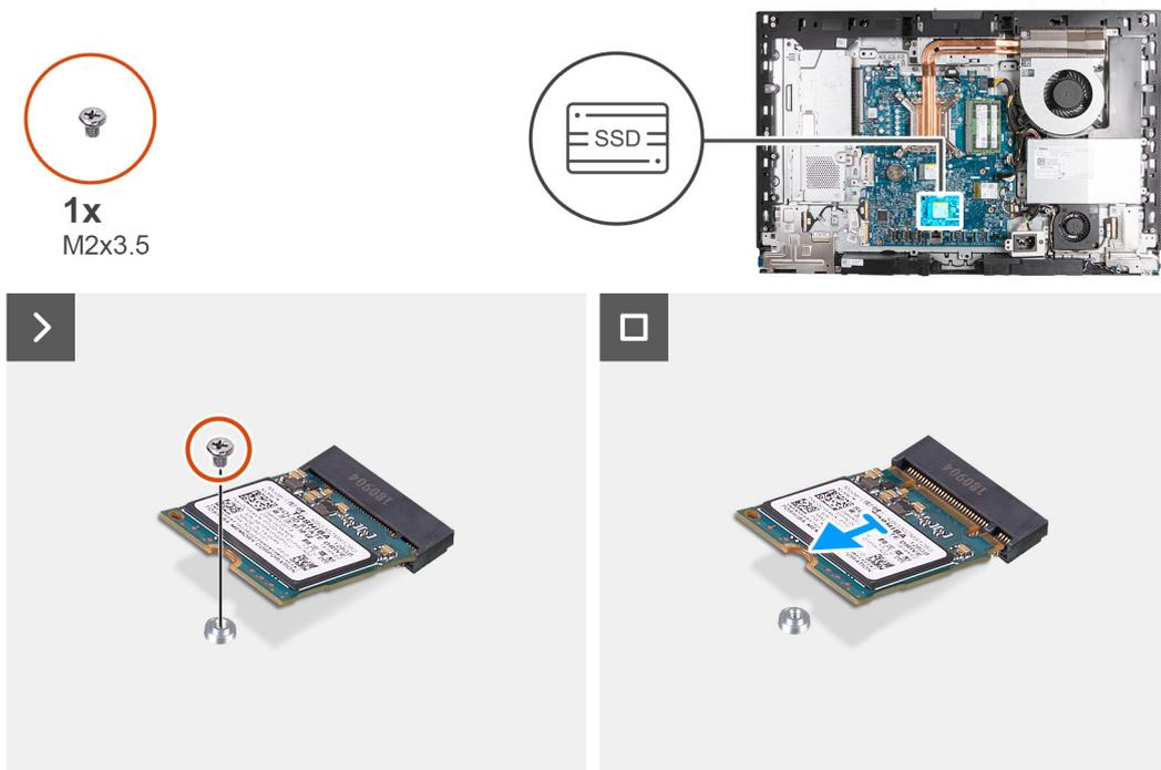
Figure 35. Retrait du disque SSD M.2 2230 du logement M.2 1
