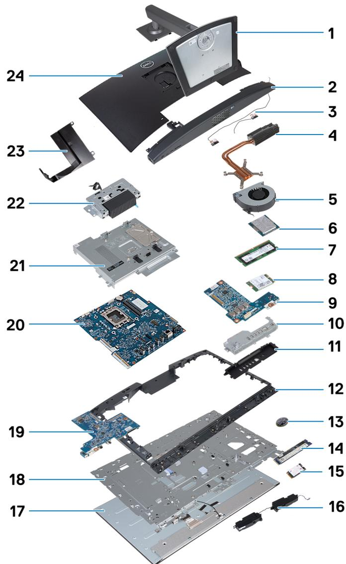
**Figure 17. Principaux composants de votre ordinateur OptiPlex All-in-One 7420 avec un processeur écoénergétique**
