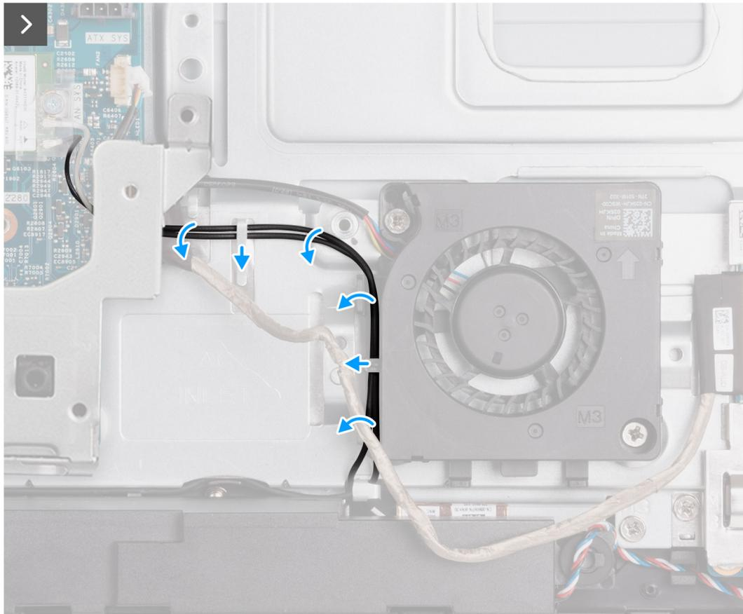
Figure 53. Retrait du ventilateur du bloc d'alimentation
