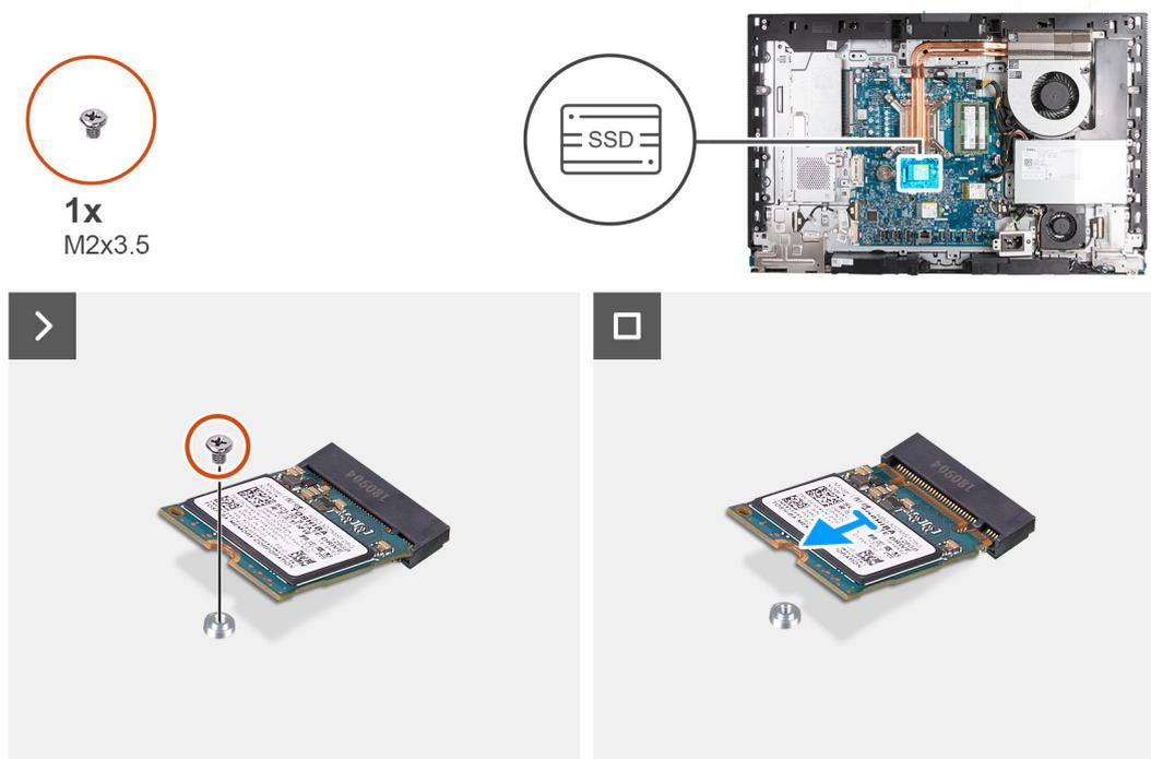
Figure 30. Retrait du disque SSD M.2 2230 du logement M.2 0
