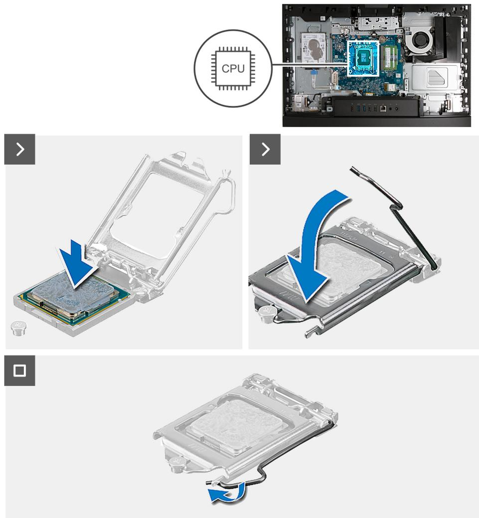
Figure 112. Installation du processeur
