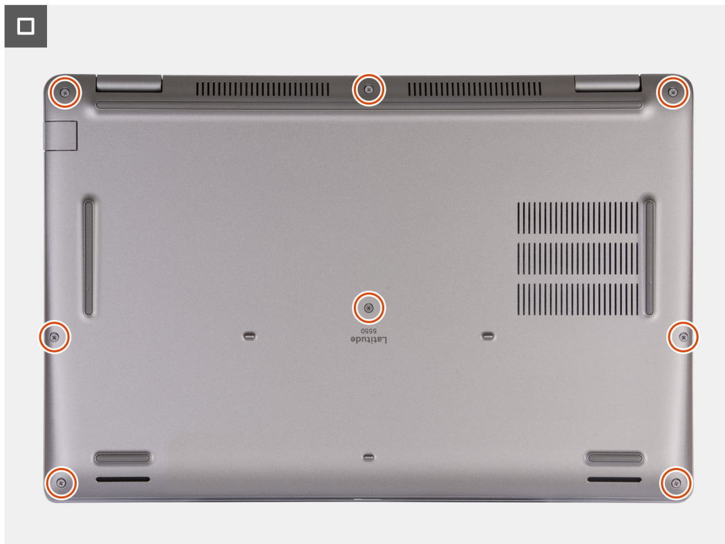
Abbildung 18. Festziehen der unverlierbaren Schrauben
