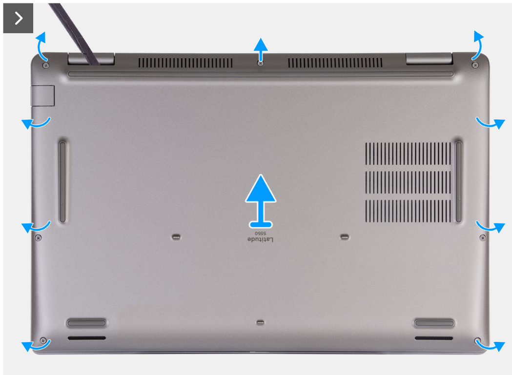
Abbildung 14. Entfernen der Bodenabdeckung
