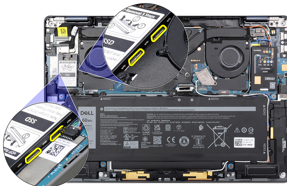
Figure 29. Capot de protection du disque SSD M.2
