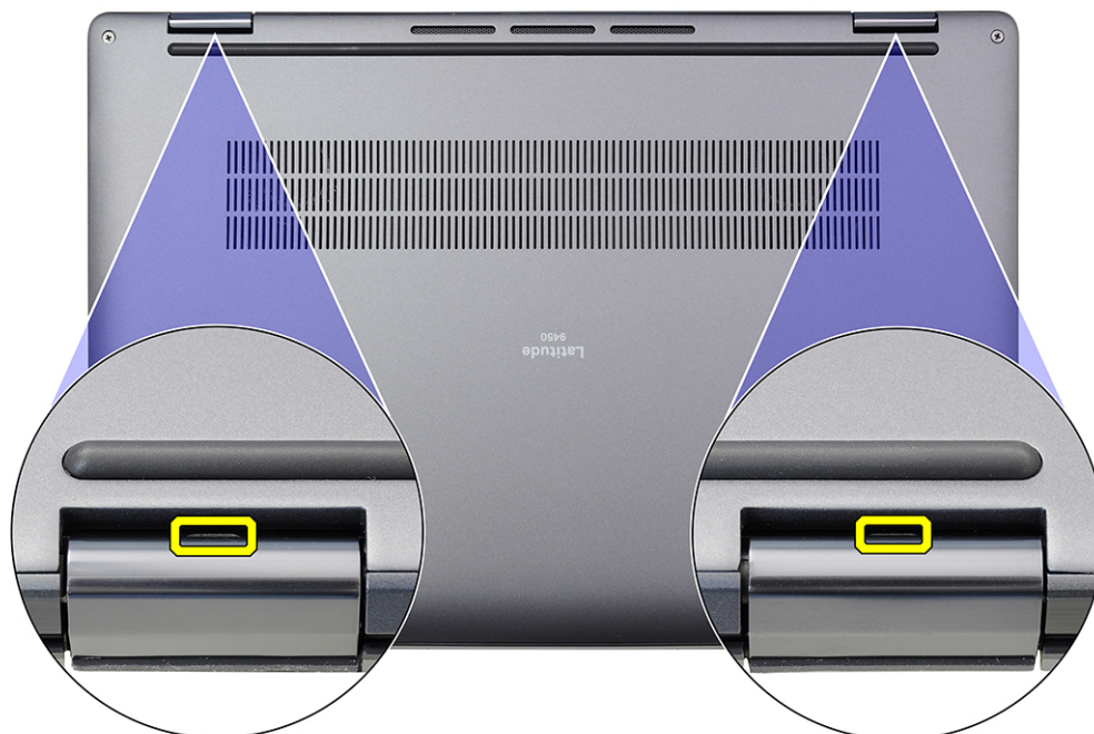
Figure 21. Points de levier du cache de fond
