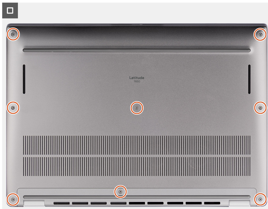
Ilustración 17. Instalación de la cubierta de la base
