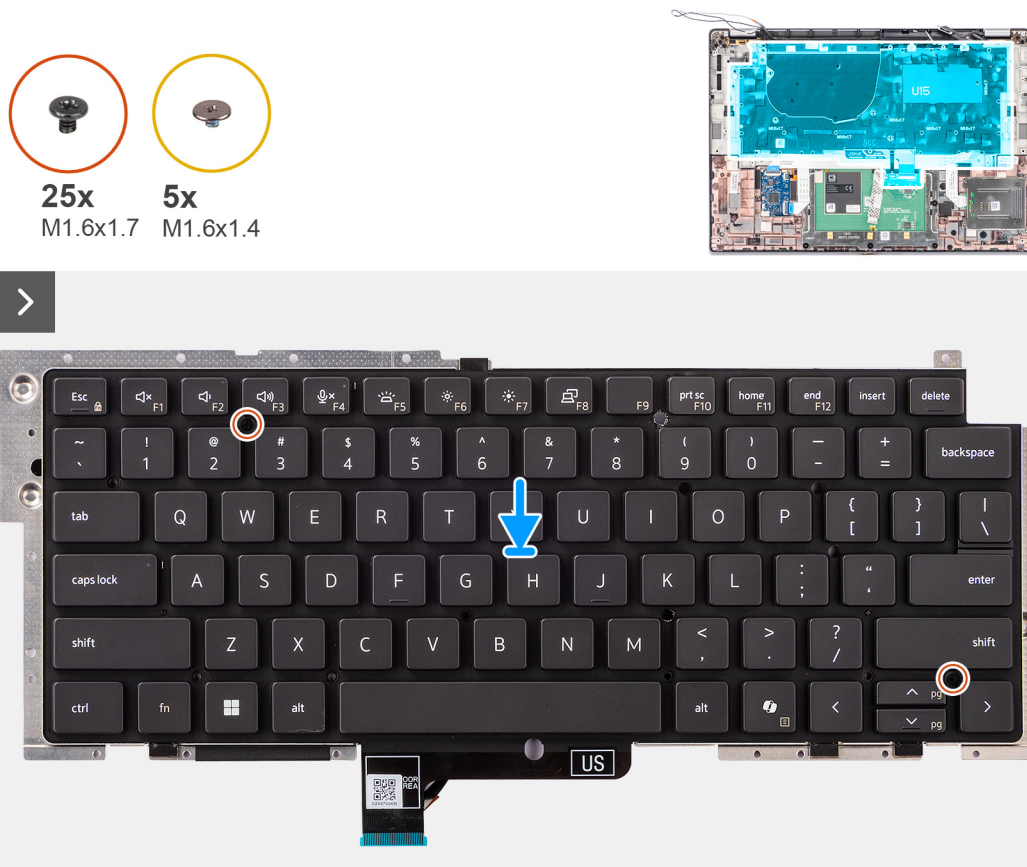
Ilustración 67. Instalación del teclado
