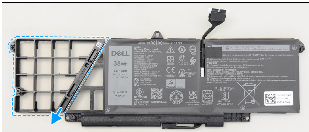
Ilustración 30. Extracción de la batería de 2 celdas
