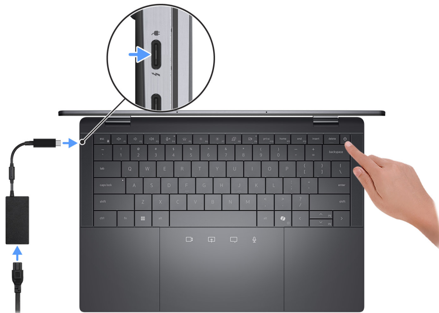
Afbeelding 11. De voedingsadapter aansluiten
