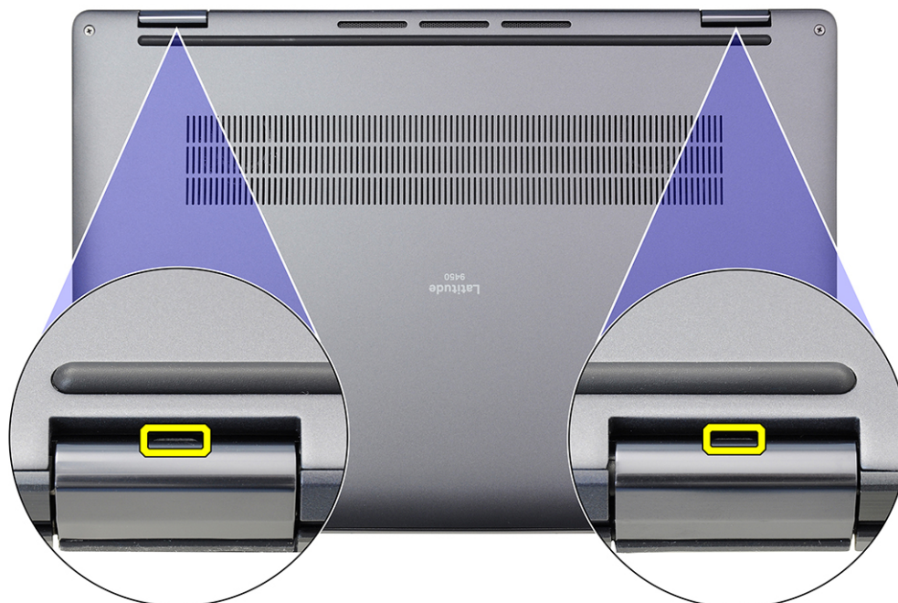
Afbeelding 21. Wrikpunten van de onderplaat
