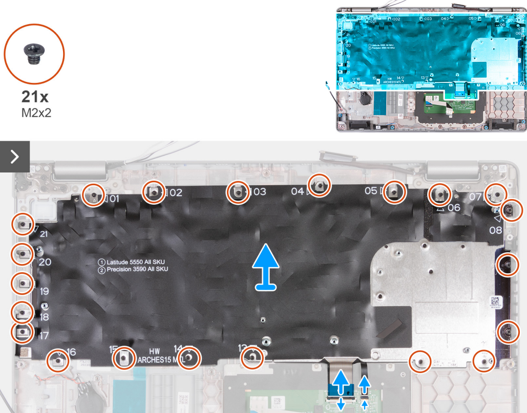
Afbeelding 65. Het toetsenbord verwijderen
