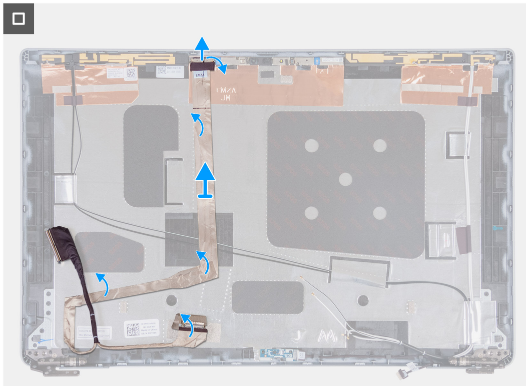
Figur 90. Ta bort bildskärmskabeln
