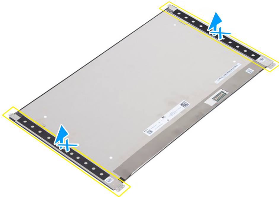
Figur 79. Dra inte och lossa Sr-tejpens (Stretch Release) från bildskärmen.
