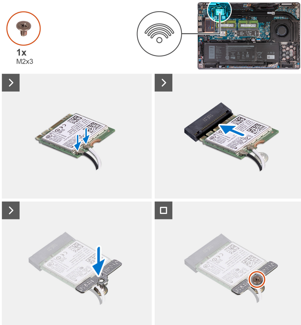
Figura20. Instalar a placa de comunicação sem fios
