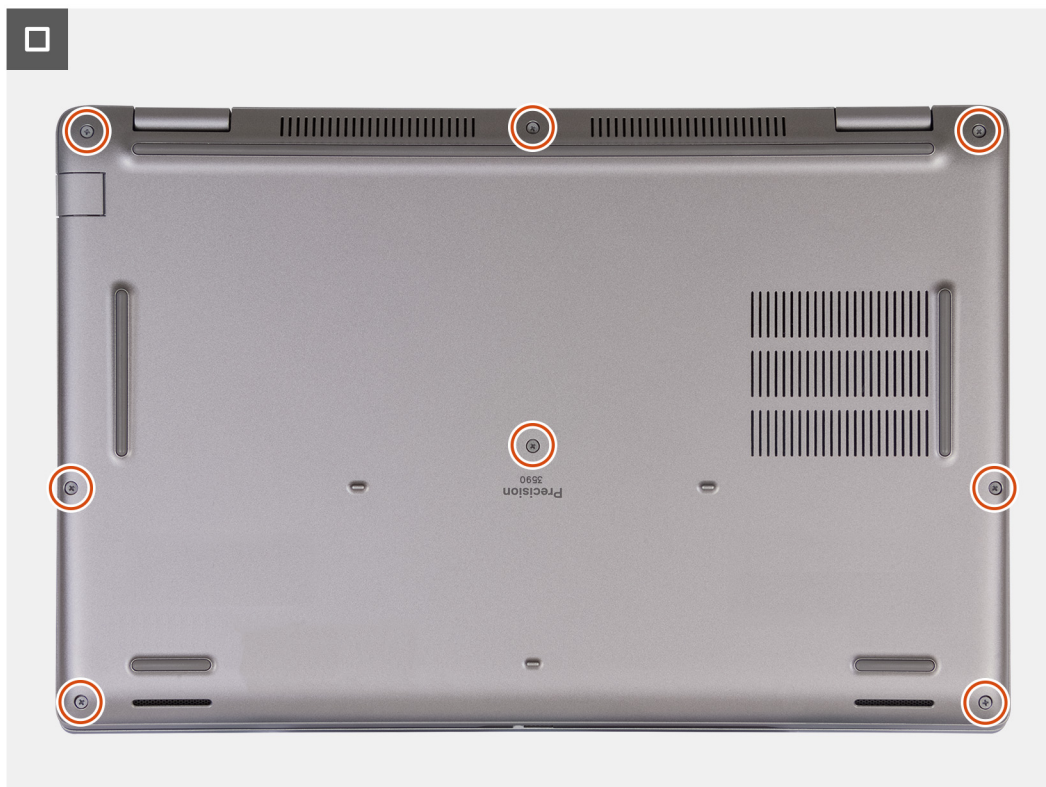
Figura18. Apertar os parafusos integrados
