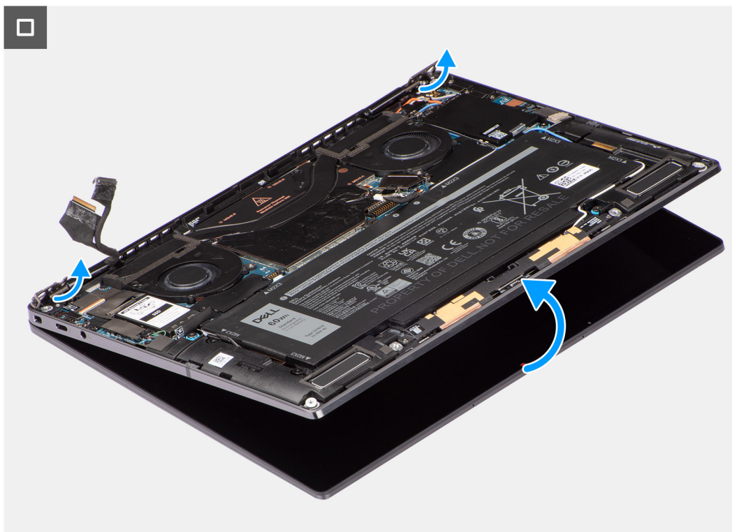
Obrázek 46. Demontáž sestavy displeje
