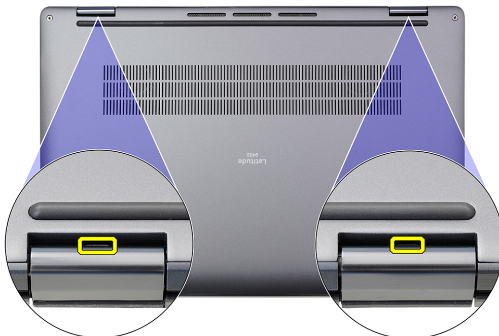
Obrázek 21. Body uvolnění na spodním krytu
