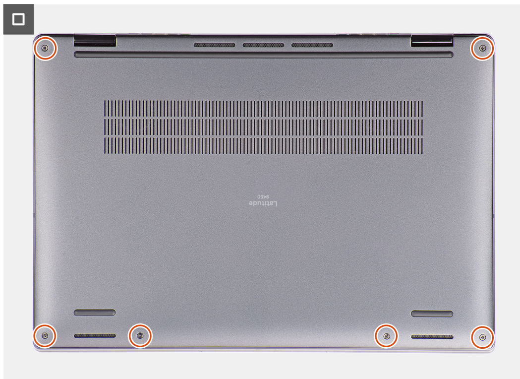
Obrázek 23. Nasazení spodního krytu
