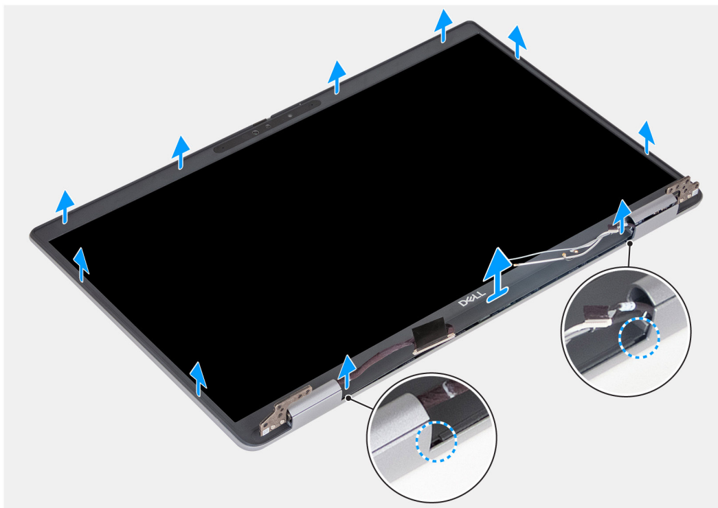
Figura74. Retirar a moldura do ecrã
