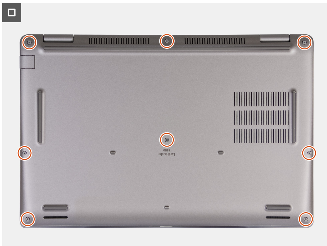
Figura18. Apertar os parafusos integrados
