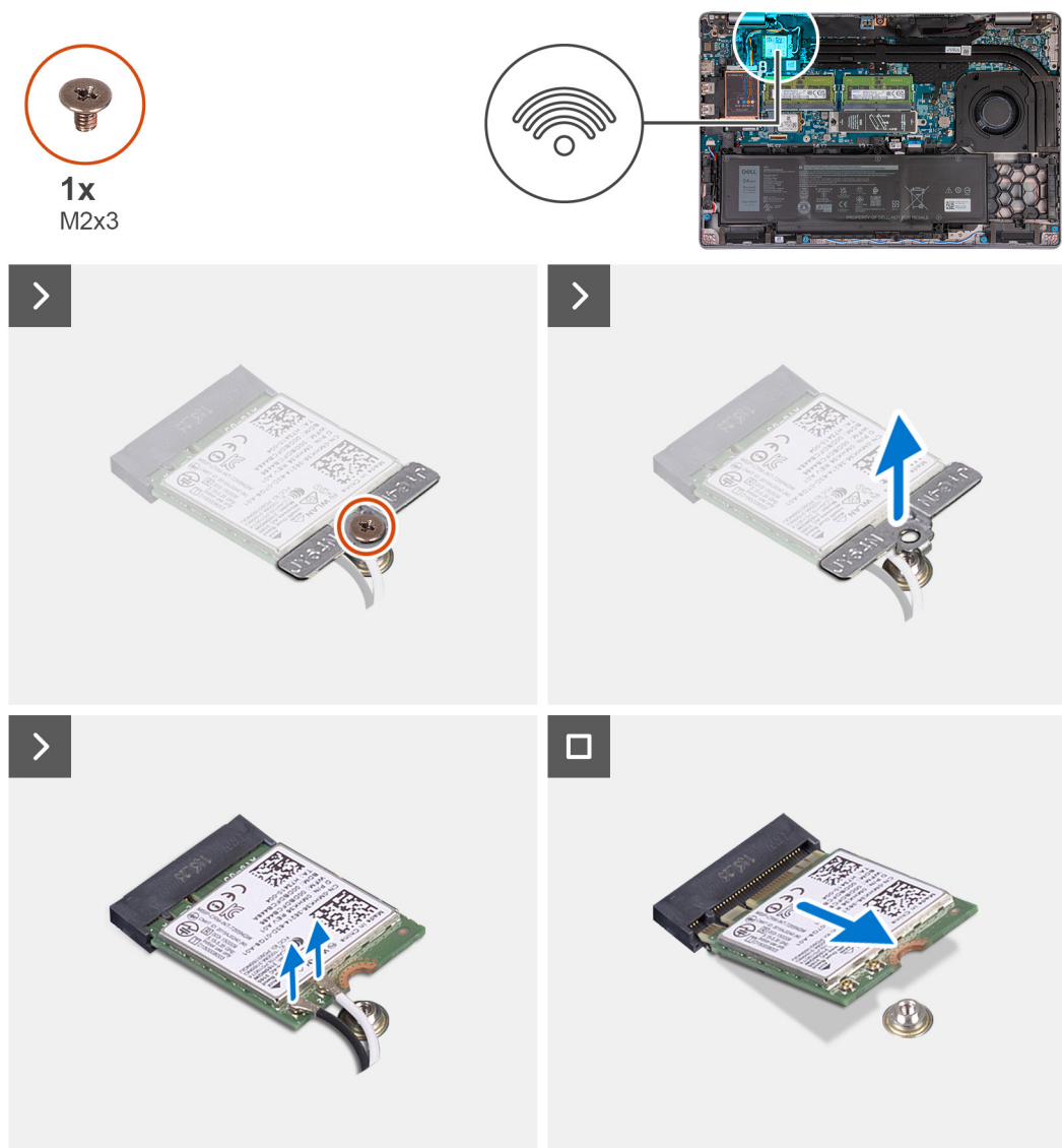
Figura19. Retirar a placa de comunicação sem fios
