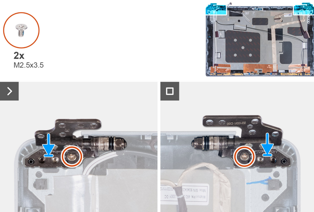
Figura87. Instalar as dobradiças do ecrã
