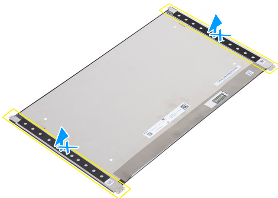
Figura79. Não puxe e solte as fitas de estiramento (SR)
