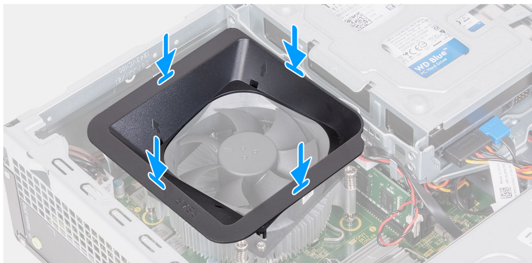
Obrázek 47. Montáž krytu ventilátoru
