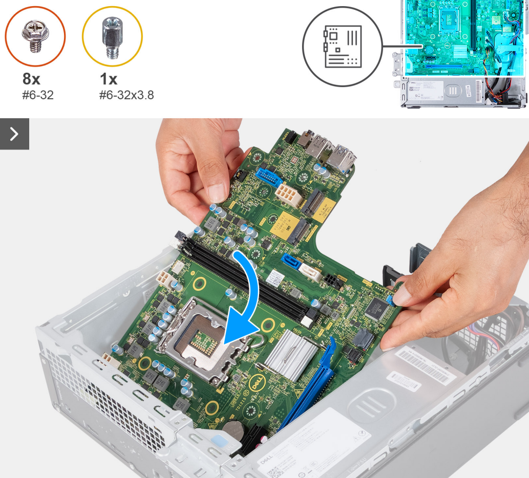
Obrázek 57. Vložení základní desky do šasi
