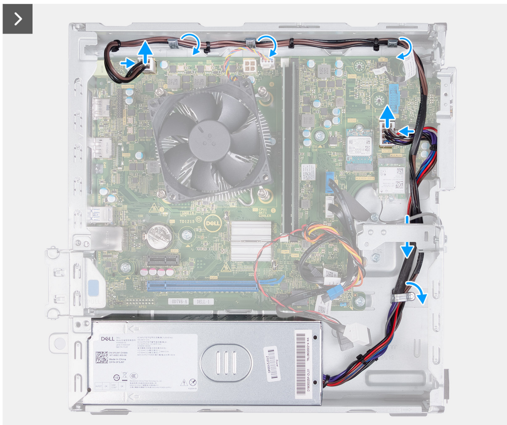
Obrázek 38. Demontáž kabelů z vodítek
