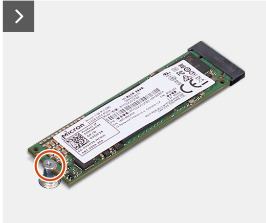
Obrázek 27. Demontáž disku SSD M.2 2280
