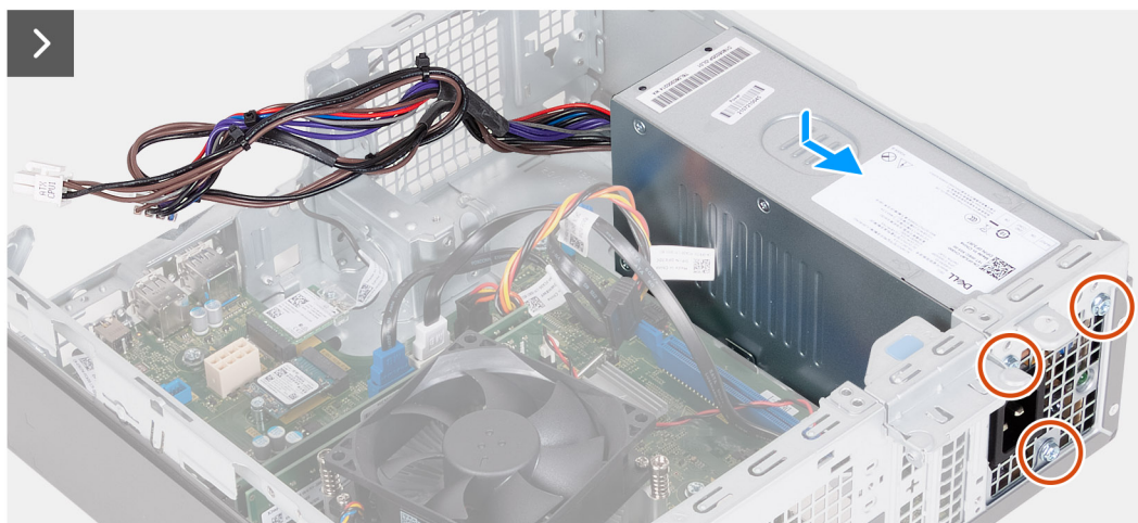
Obrázek 40. Montáž napájecí jednotky
