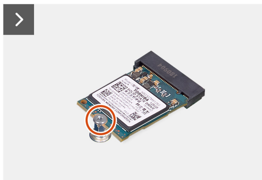
Obrázek 24. Demontáž disku SSD M.2 2230
