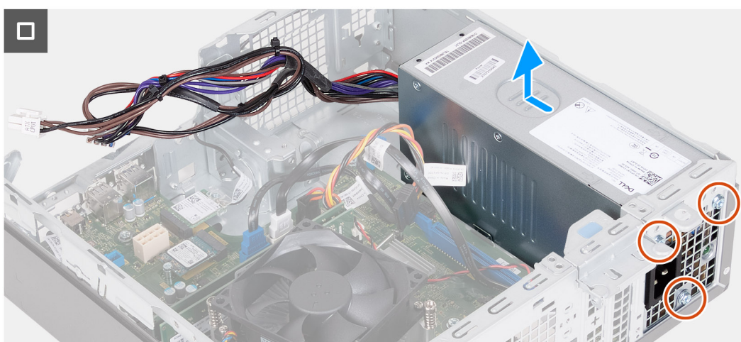
Obrázek 39. Vyjmutí napájecí jednotky
