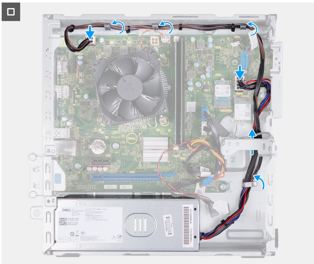
Obrázek 41. Protážení kabelů skrze vodítka
