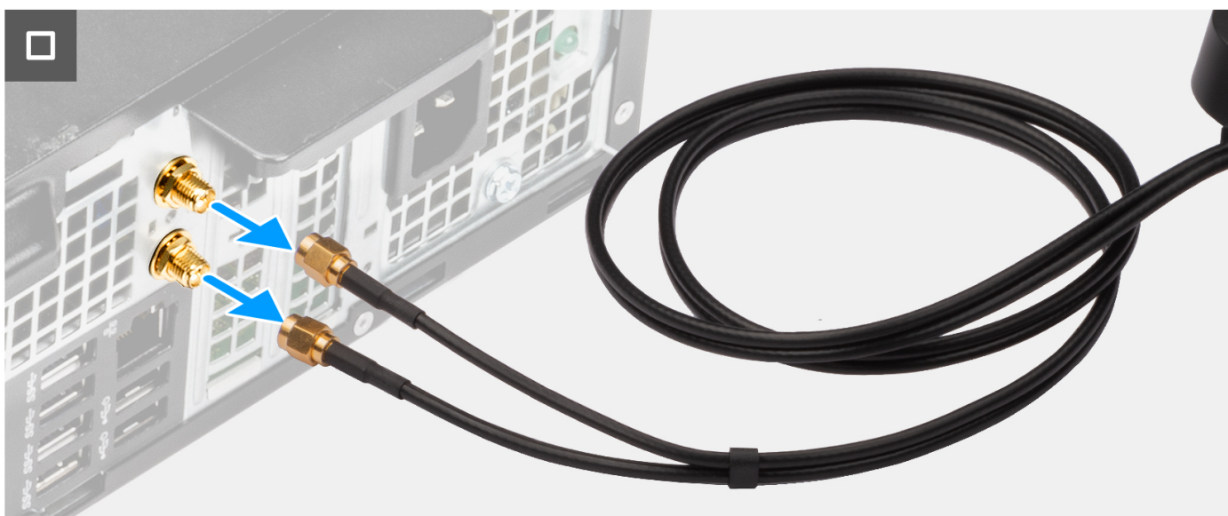
Obrázek 36. Demontáž externí antény
