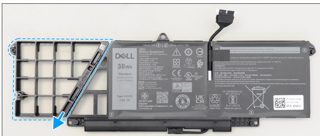
Rysunek 38. Wymontowywanie baterii 2-ogniowej
