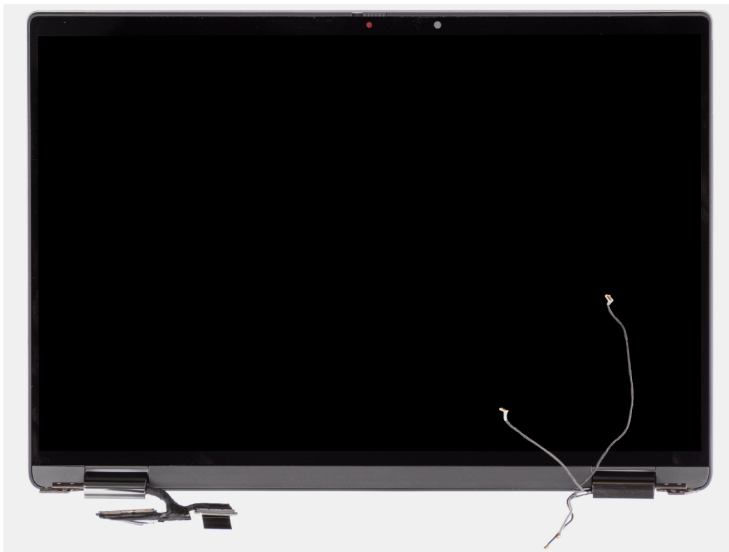
Rysunek 51. Zestaw wyświetlacza z kablami antenowymi sieci WWAN
