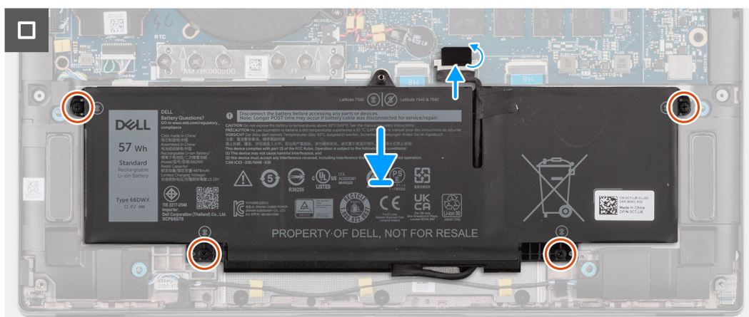
Rysunek 43. Instalowanie baterii 3-ogniowej
