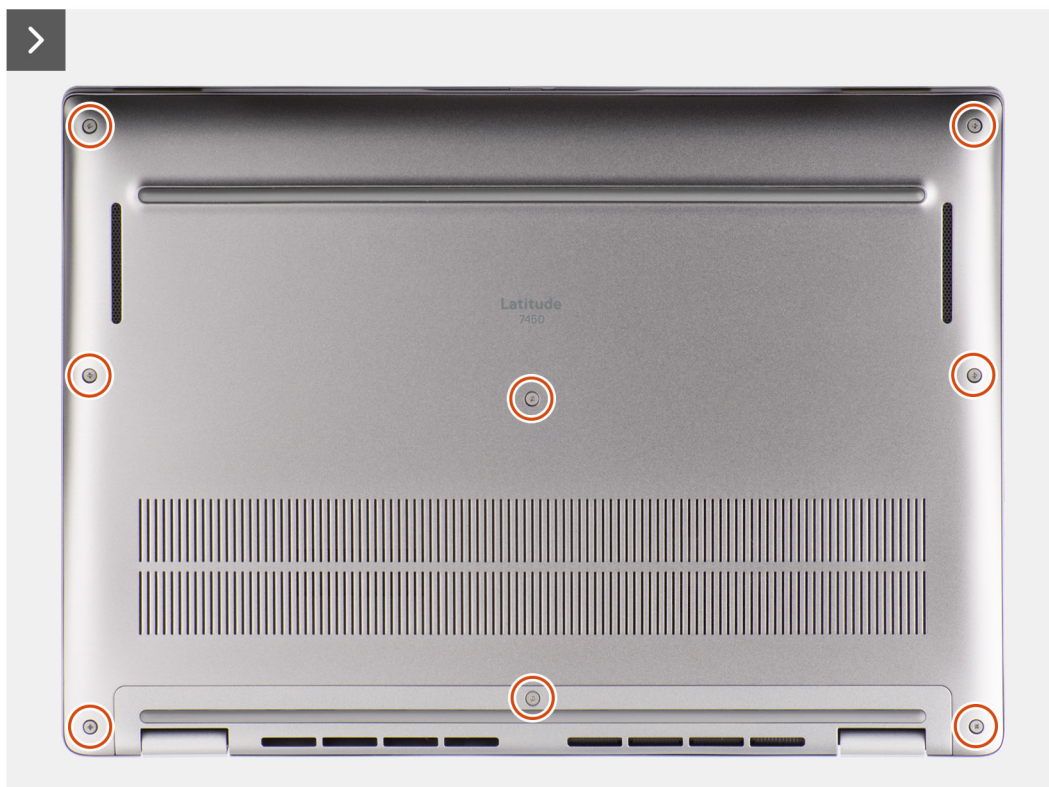
Rysunek 16. Wymontowywanie pokrywy dolnej
