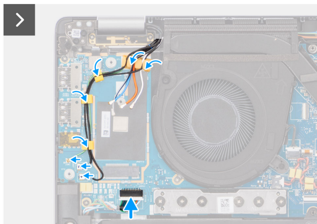
Rysunek 75. Instalowanie karty towarzyszącej we/wy
